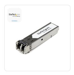
StarTech.com Módulo Tranceptor SFP Compatible con el Modelo EW3Z0000587 de Citrix - 1000BASE-LX - Fibra Monomodo (SMF) de 1GbE - SFP Ethernet Gigabit de 1Gb - LC - 10km - 1310nm - DDM
