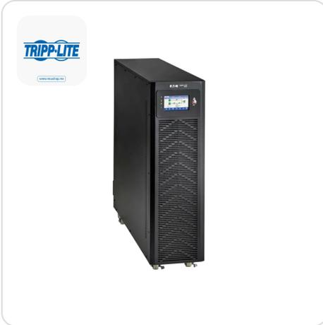
No Break Tripp Lite S3M15K2B UPS trifásico de doble conversión 208/220/120/127V 15kVA/kW - Unidad de factor de potencia (Unity PF), 2 cadenas de batería interna, Doble conversión (en línea), 15 kVA, 15000 W, Onda sinusoidal pura, 120 V, 220 V
