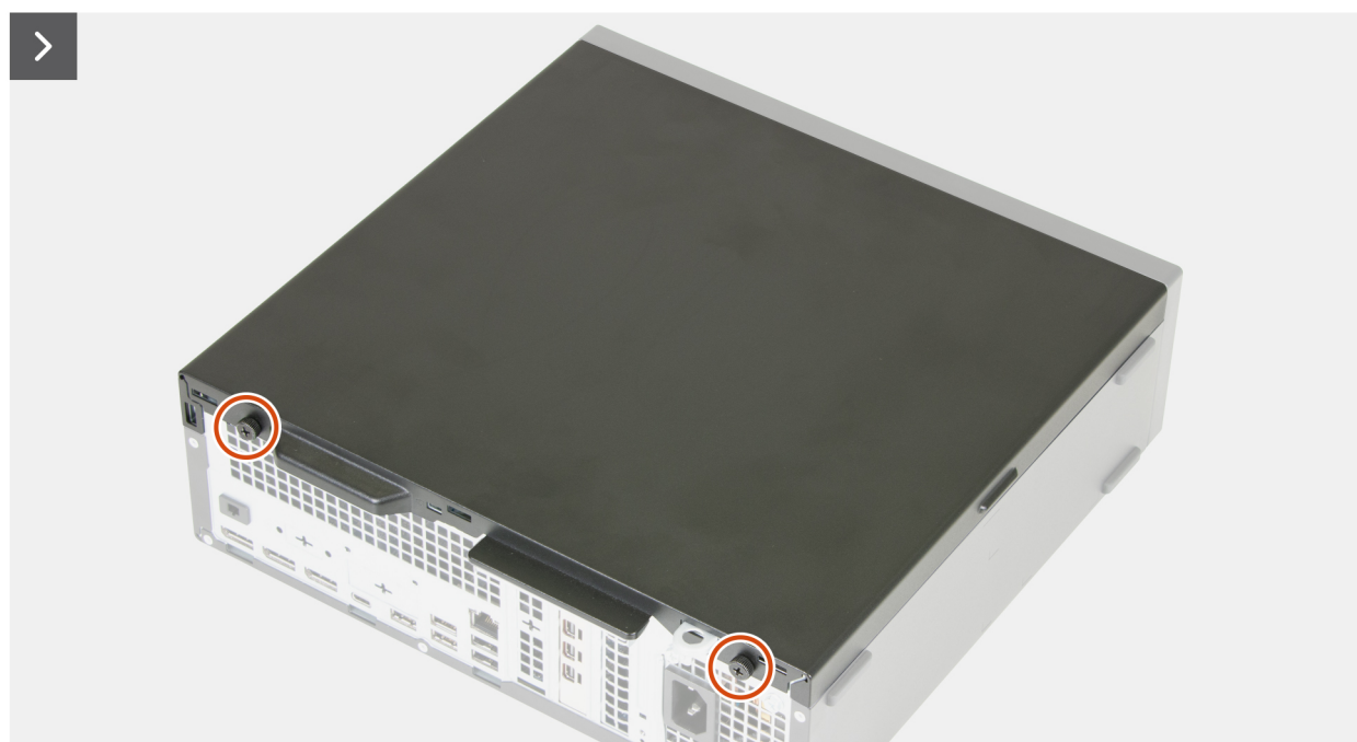
Ilustración 6. Extracción de la cubierta lateral
