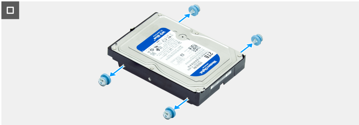
Ilustración 39. Extracción del disco duro
