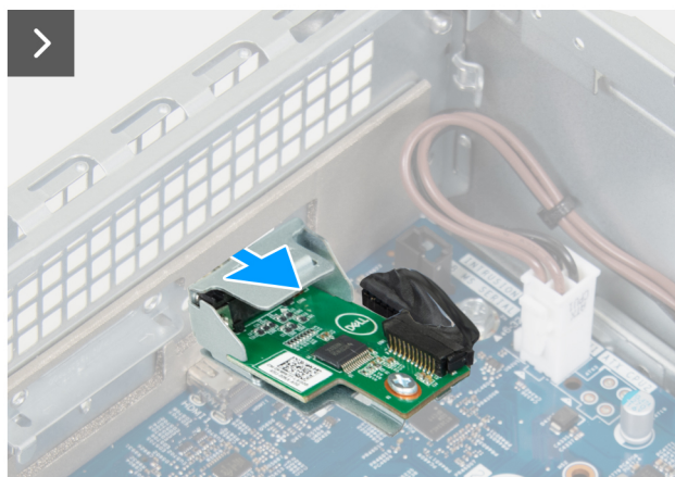
Ilustración 56. Cómo extraer el módulo de puerto serial
