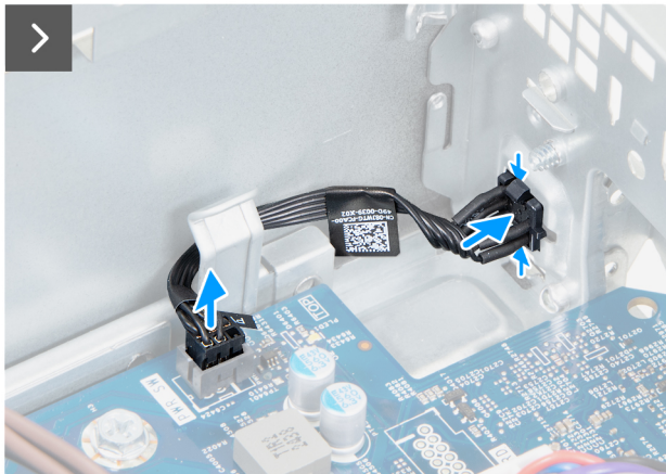
Ilustración 43. Extracción del botón de encendido
