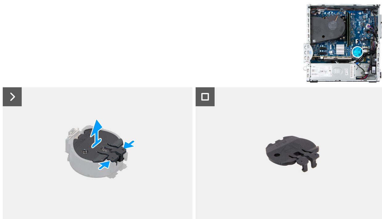
Ilustración 10. Extracción de la cubierta de la batería de tipo botón
