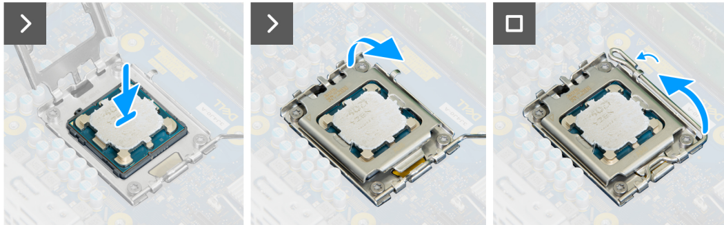
Ilustración 60. Instalación del procesador
