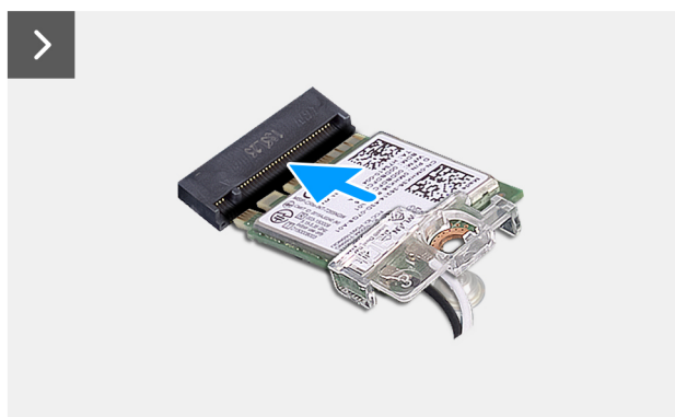
Ilustración 30. Instalación de la tarjeta inalámbrica
