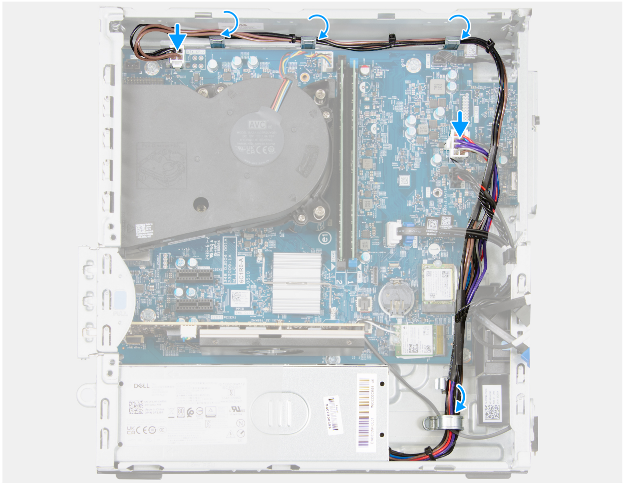
Ilustración 50. Instalación de la fuente de alimentación
