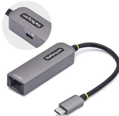
Añada acceso a la red de 2.5GbE a laptops, tablets y iPhones equipados con un puerto USB-C. Este adaptador USB-C a Ethernet cuenta con un puerto de paso PD de 100 W que le permite conectar un cargador al mismo puerto USB-C, lo que posibilita la conexión Ethernet y la carga de dispositivos de forma simultánea. Habilite la conexión ethernet sin perder el acceso al puerto USB-C original para cargar o conectar periféricos adicionales; muy adecuado para dispositivos con puertos limitados.
