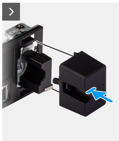
Ilustración 69. Instalación del módulo de la antena (cable blanco)
