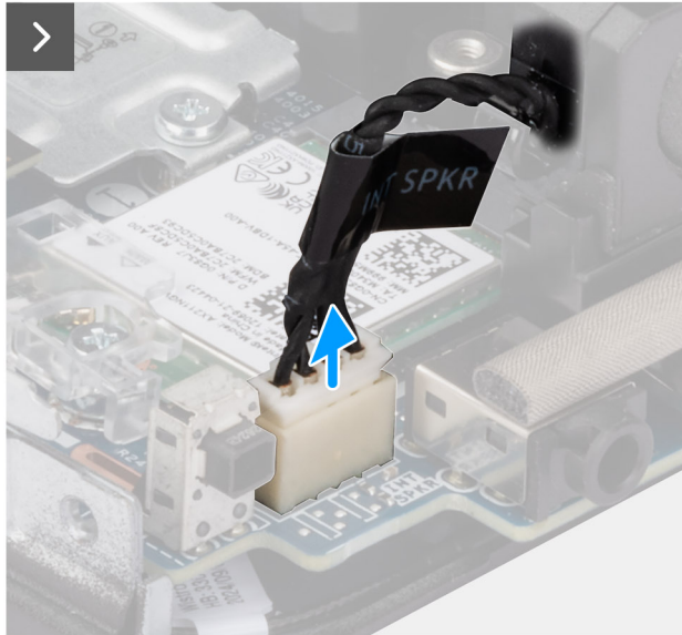
Ilustración 14. Extracción del parlante
