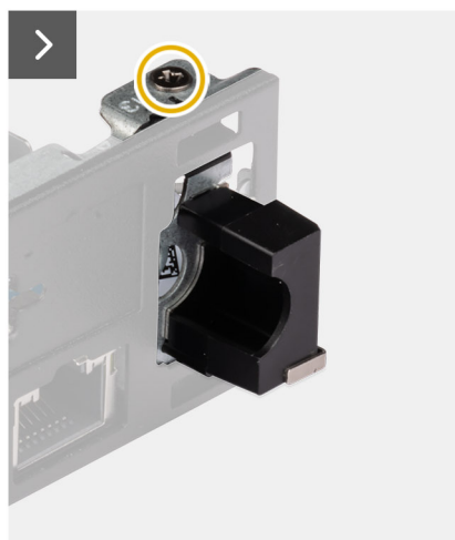
Ilustración 69. Instalación del módulo de la antena (cable blanco)
