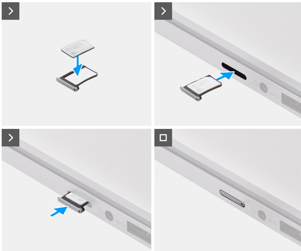
**Ilustración 4. Instalación de la tarjeta SIM en la computadora**
