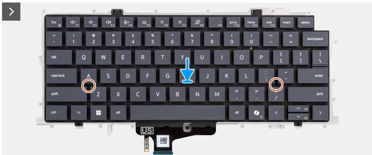
Ilustración 81. Instalación del teclado
