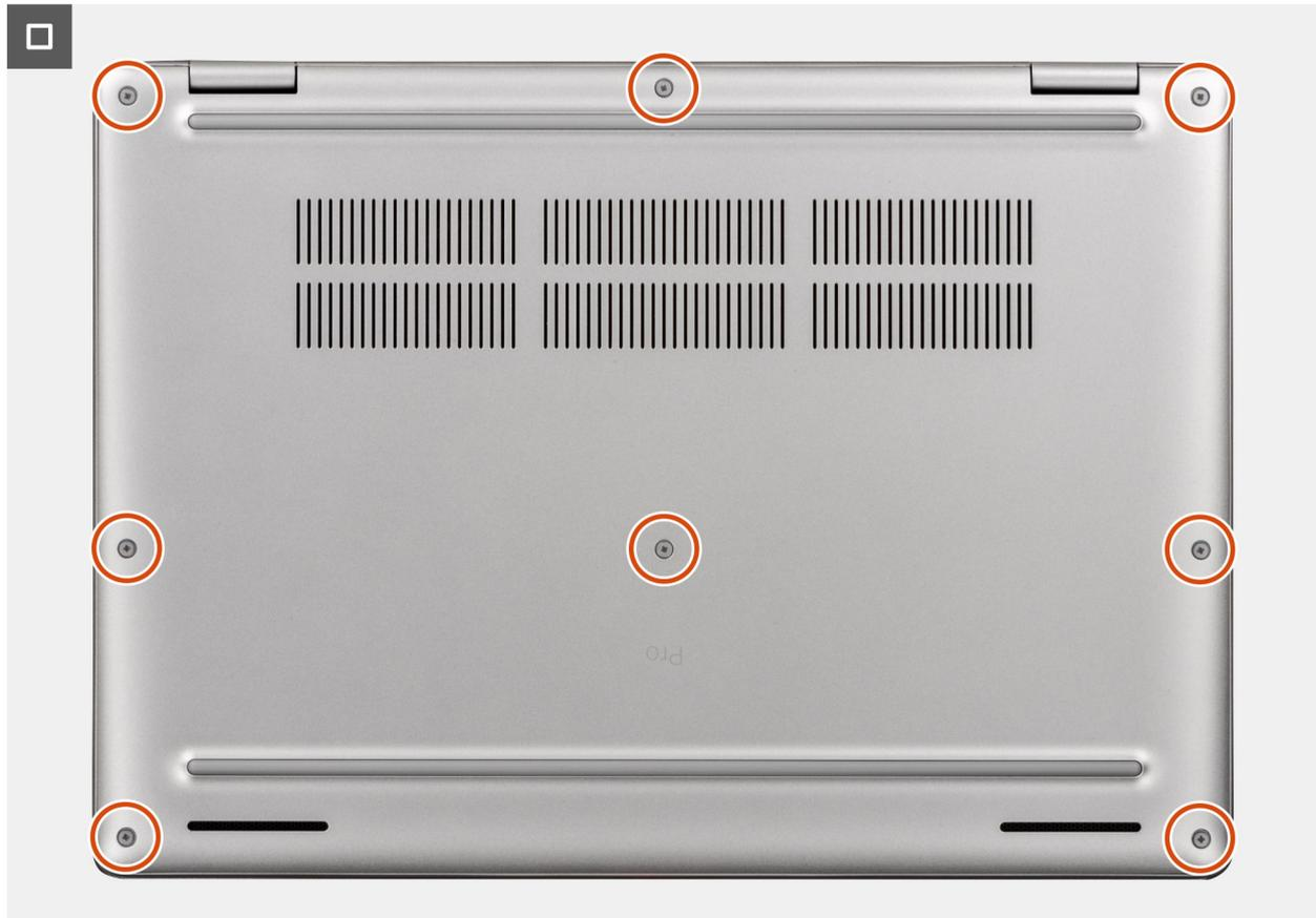
**Ilustración 23. Instalación de la cubierta de la base**
