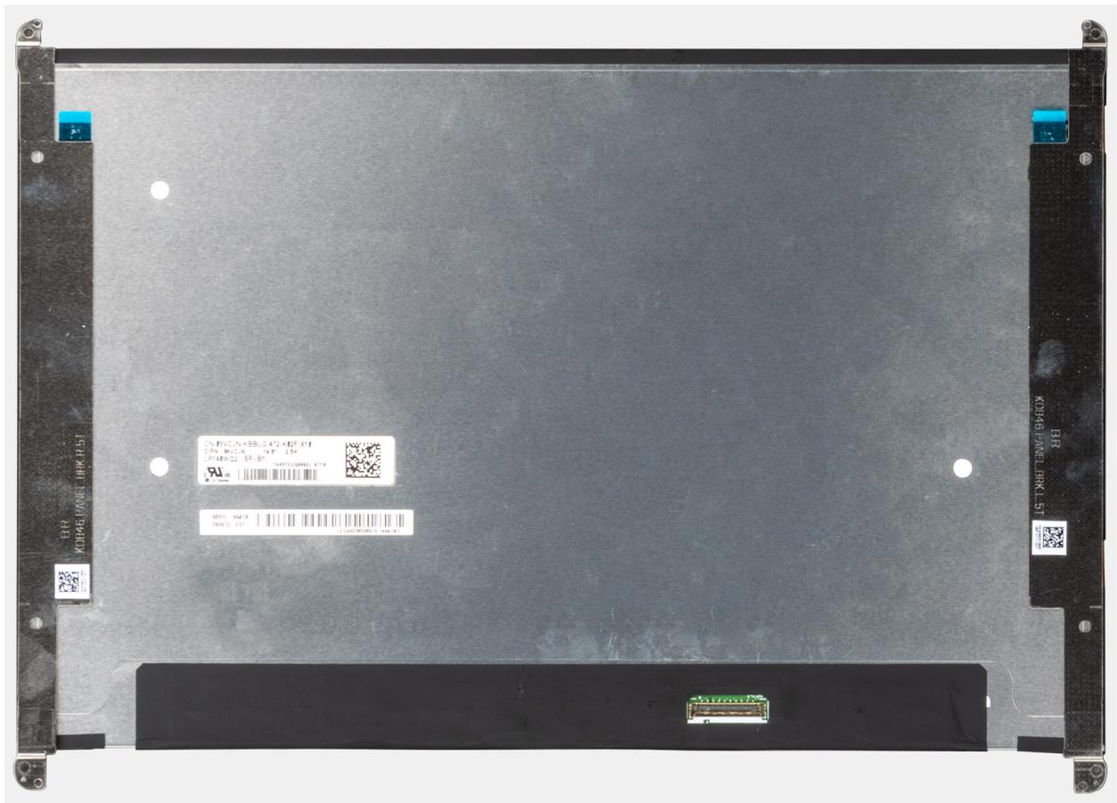
**Ilustración 51. Panel de pantalla con soportes**
