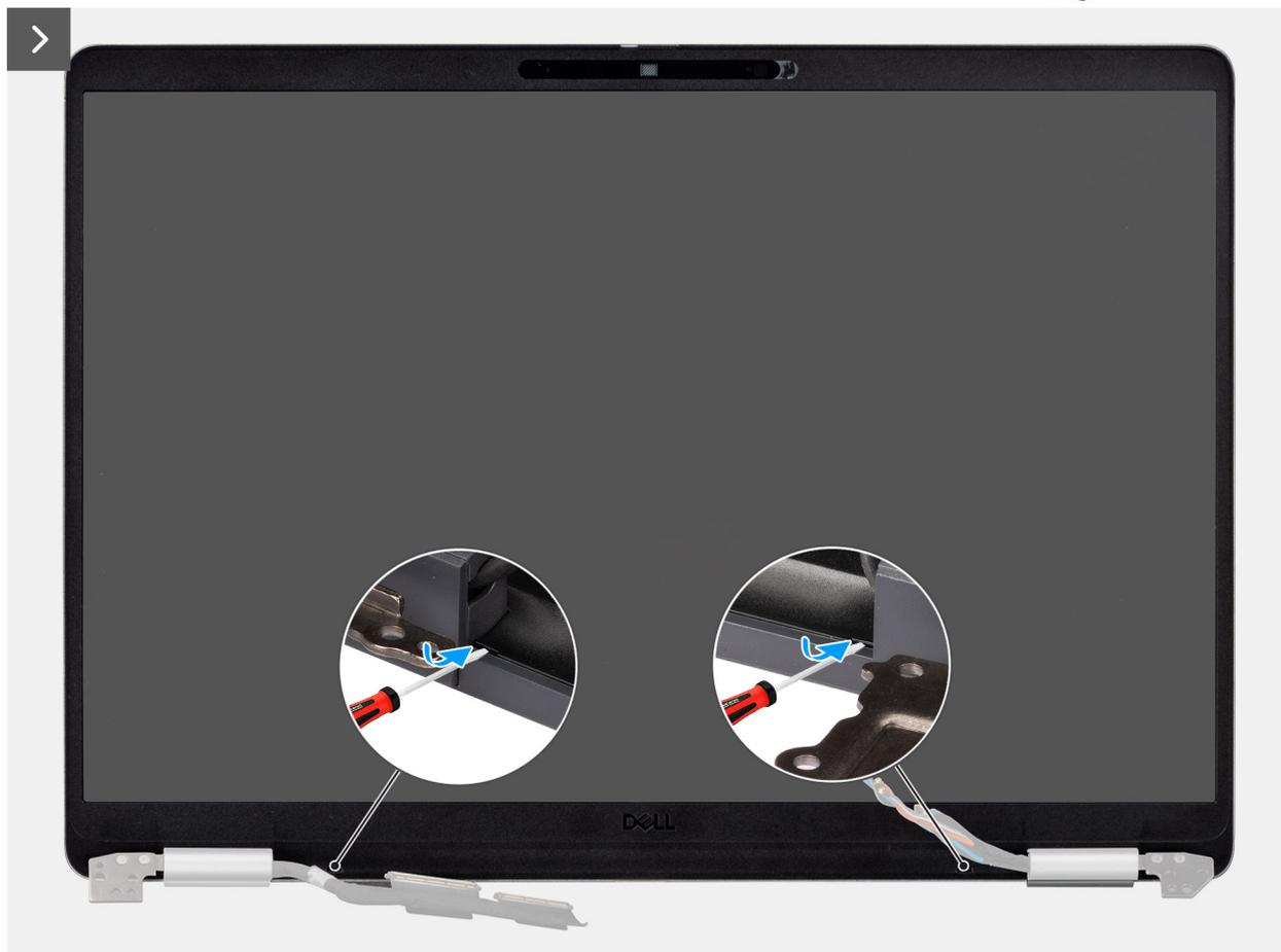
Ilustración 43. Hacer palanca en el bisel de plástico
