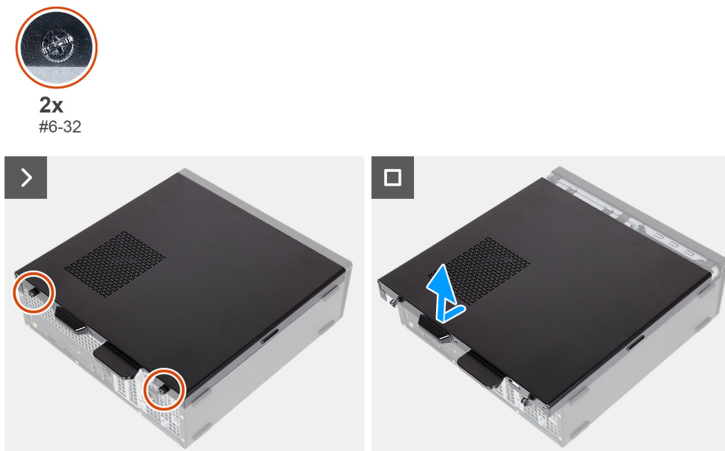
Ilustración 12. Extracción de la cubierta lateral izquierda
