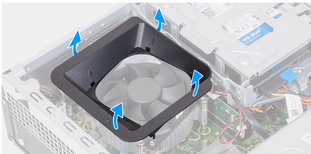
Ilustración 34. Extracción de la cubierta para flujo de aire del ventilador
