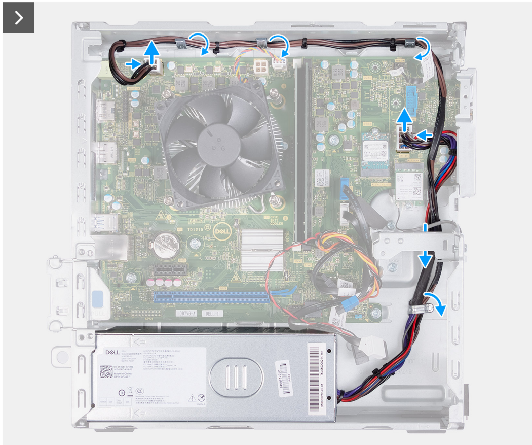
Ilustración 40. Extracción de los cables de las guías de colocación
