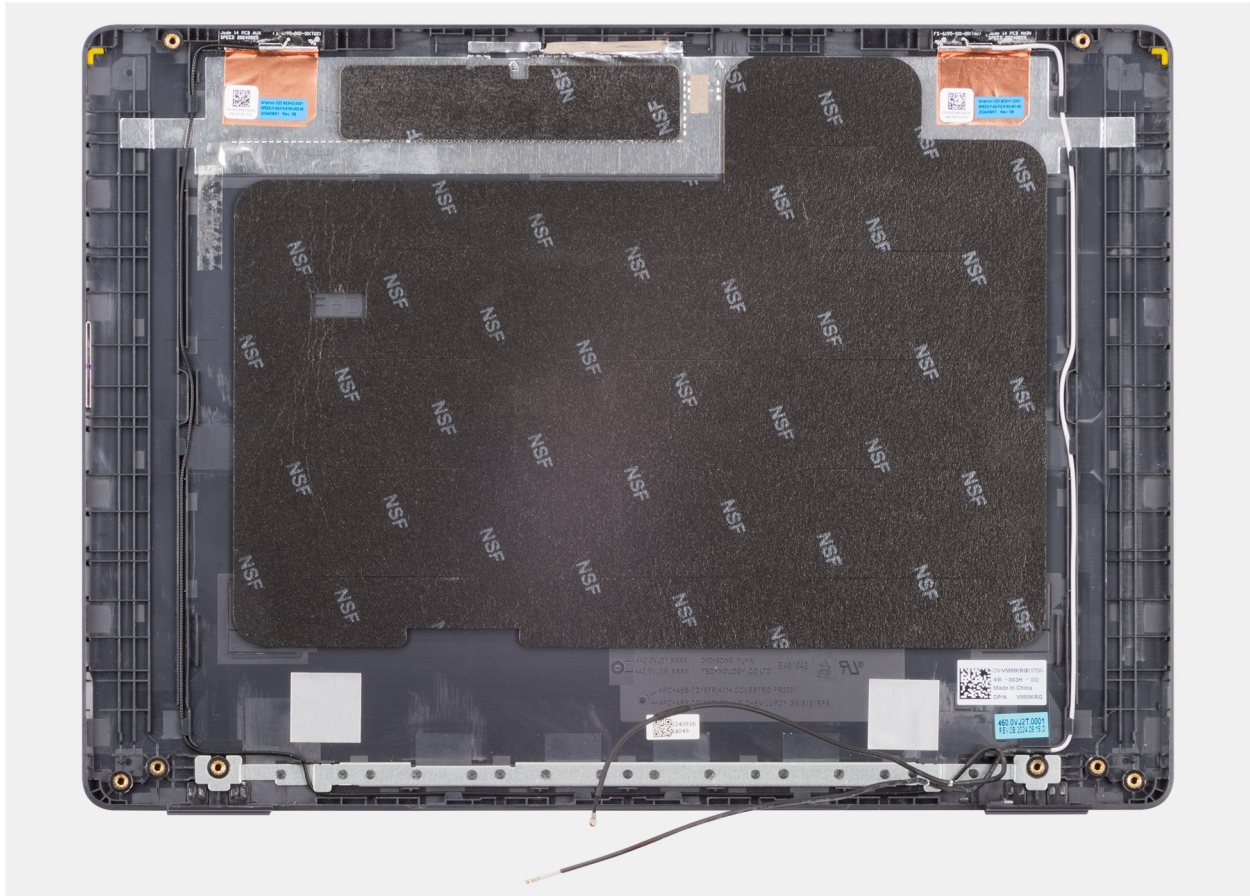
Ilustración 96. Extracción del ensamblaje de la cubierta posterior de la pantalla
