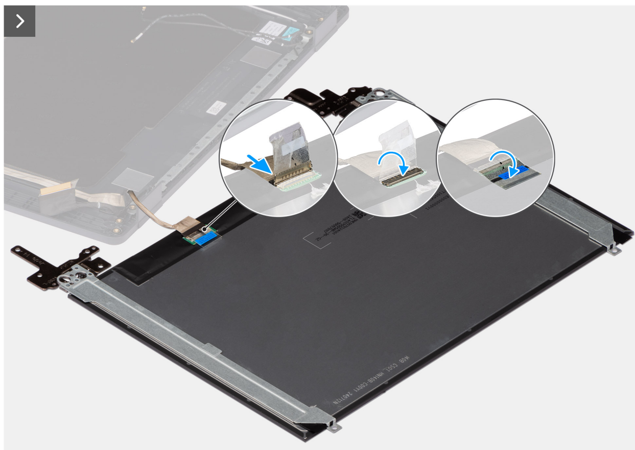
Ilustración 89. Instalación del ensamblaje del panel de pantalla
