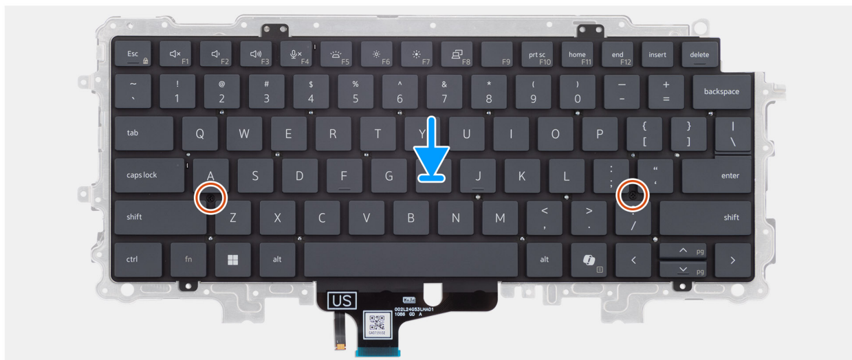
Ilustración 69. Instalación de la placa de soporte del teclado
