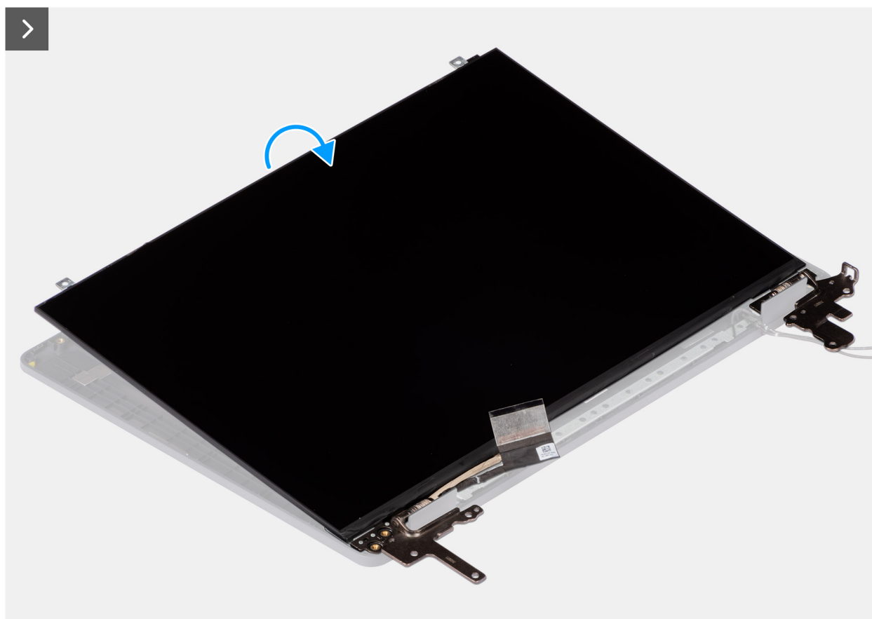
Ilustración 85. Extracción del ensamblaje del panel de pantalla
