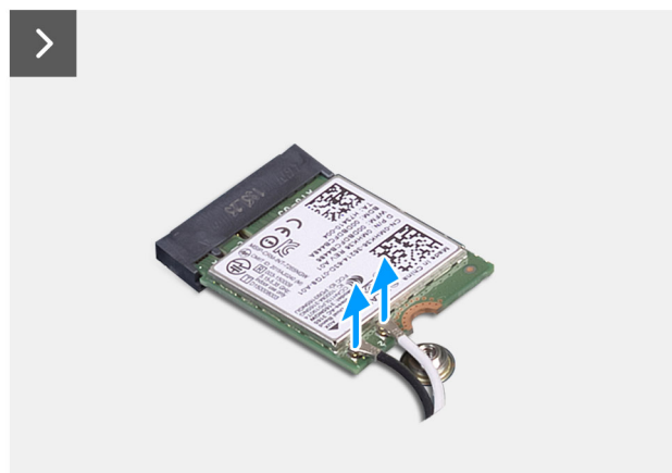
Ilustración 25. Extracción de la tarjeta inalámbrica
