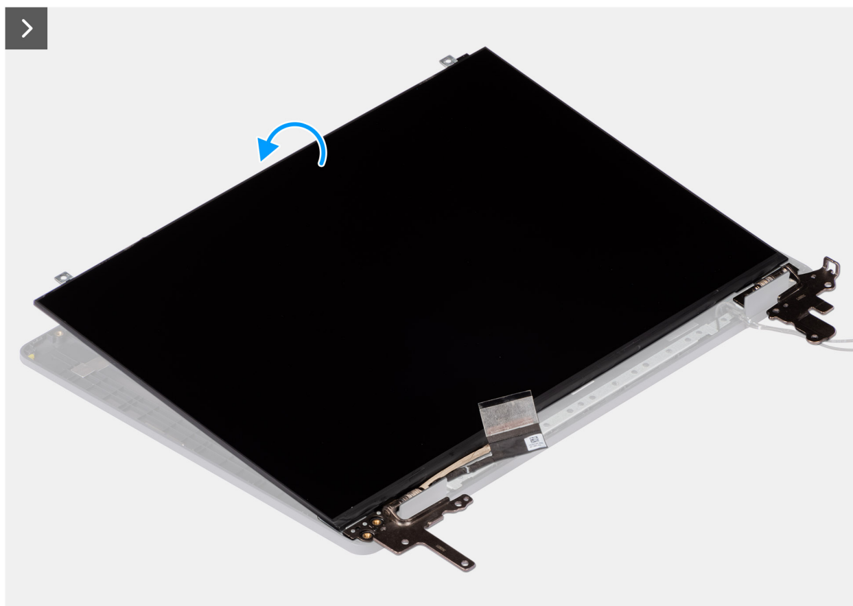
Ilustración 90. Instalación del ensamblaje del panel de pantalla
