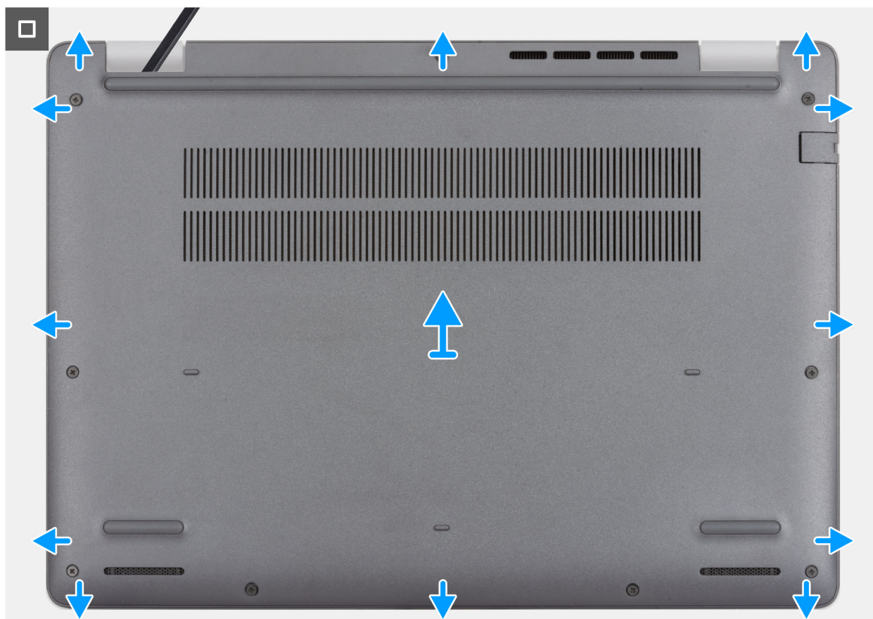
Ilustración 12. Extracción de la cubierta de la base
