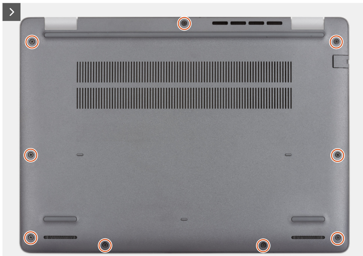
Ilustración 11. Extracción de la cubierta de la base
