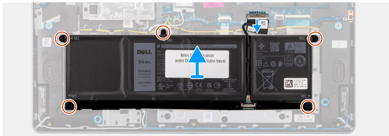
Ilustración 19. Extracción de la batería de 4 celdas
