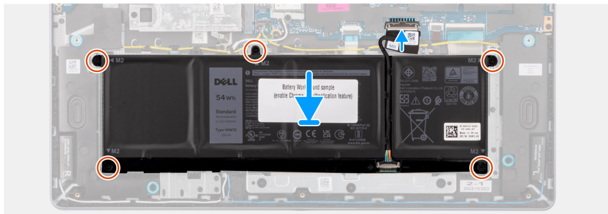
Ilustración 20. Instalación de la batería de 4 celdas
