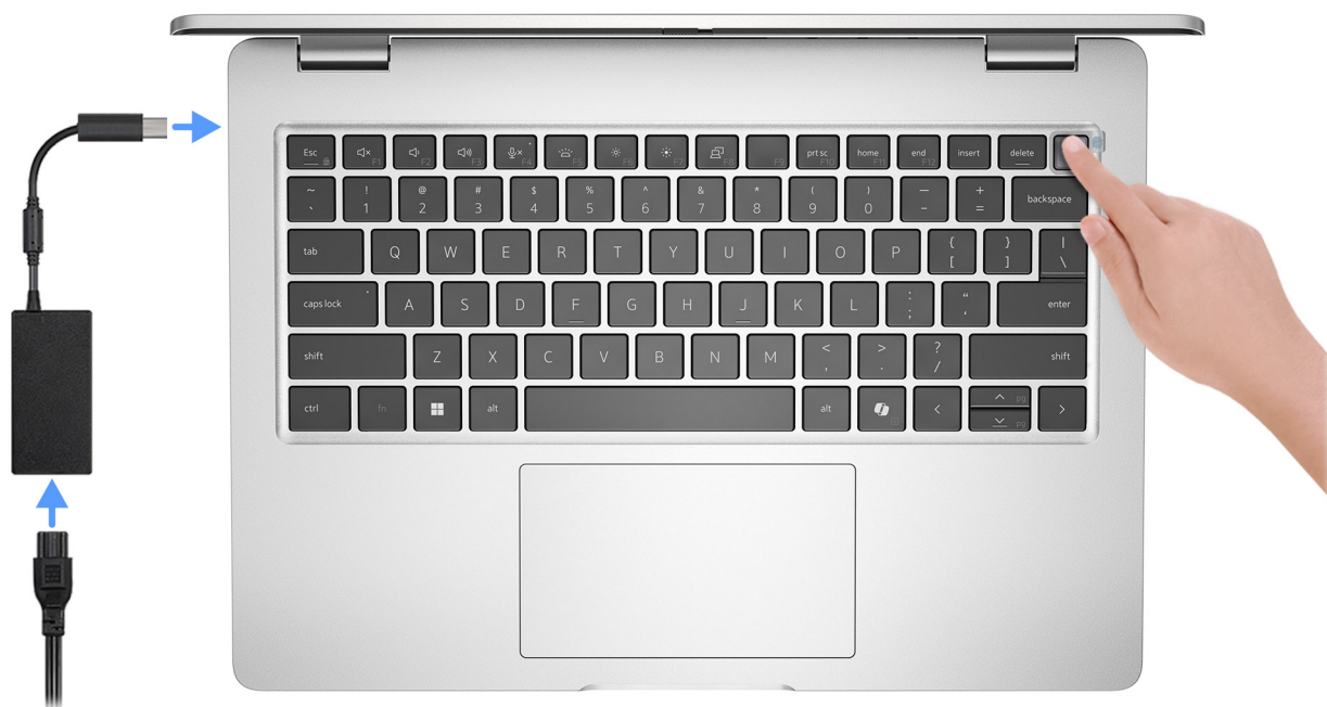
Ilustración 7. Conecte el adaptador de alimentación y presione el botón de encendido.
