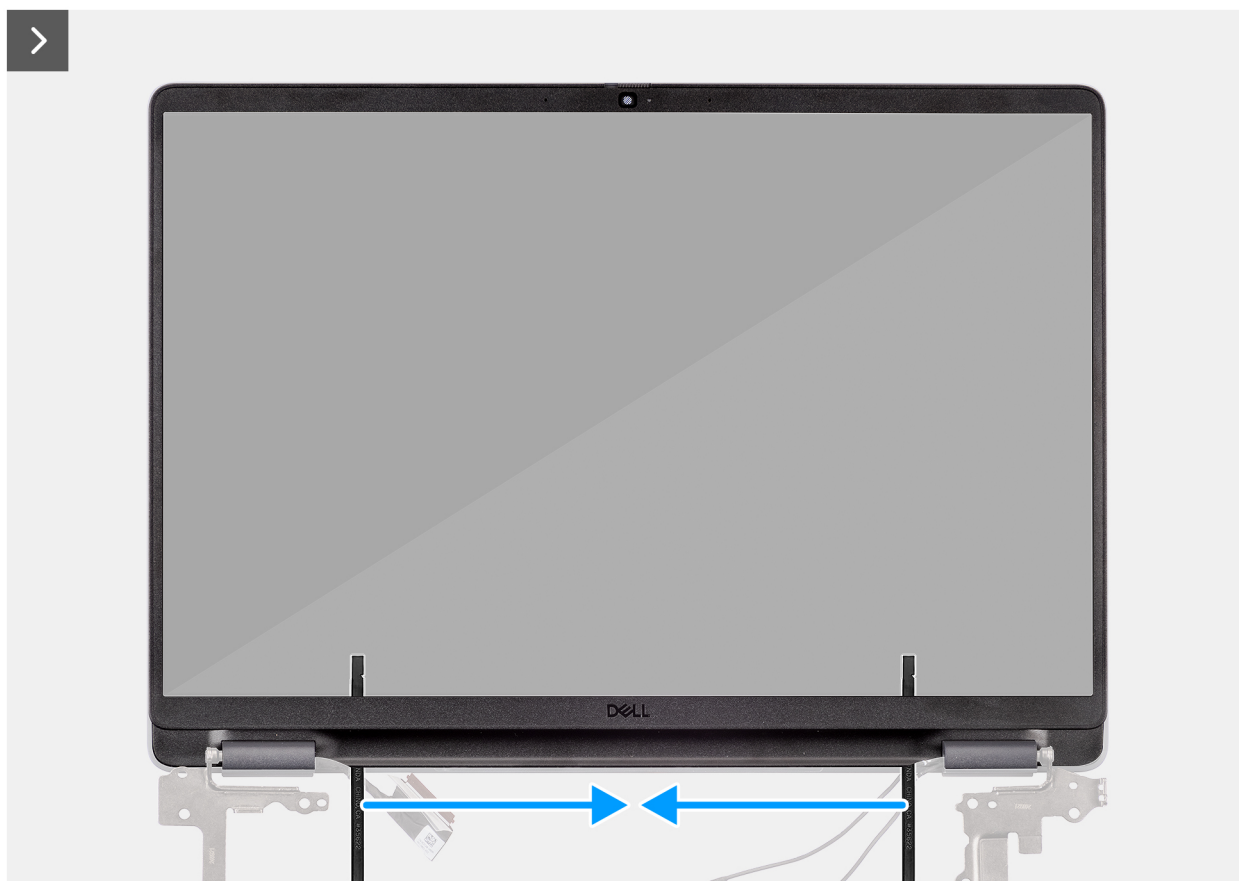
Ilustración 105. Extracción del embellecedor de la pantalla
