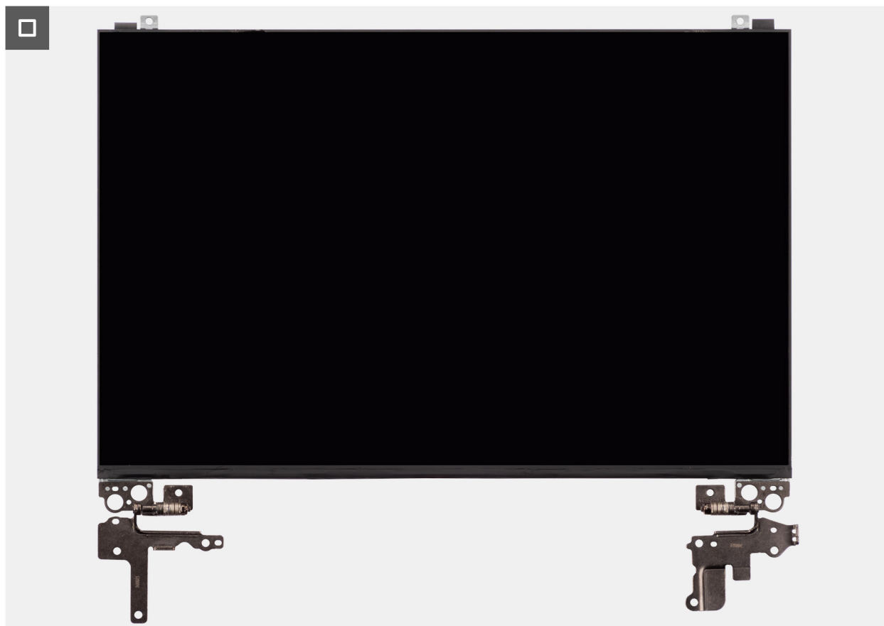
Ilustración 114. Extracción del ensamblaje del panel de pantalla
