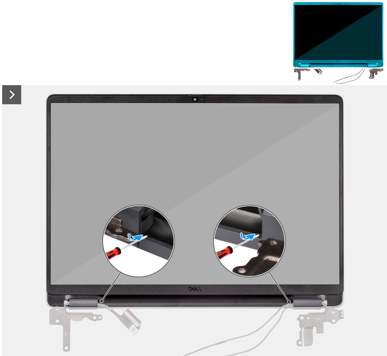
Ilustración 104. Extracción del embellecedor de la pantalla
