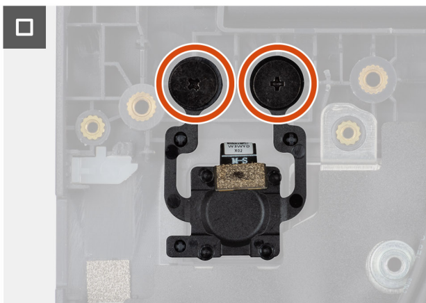
Ilustración 56. Instalación del botón de encendido con un lector de huellas digitales
