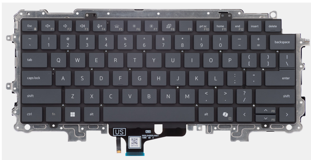
Ilustración 87. Extracción del teclado
