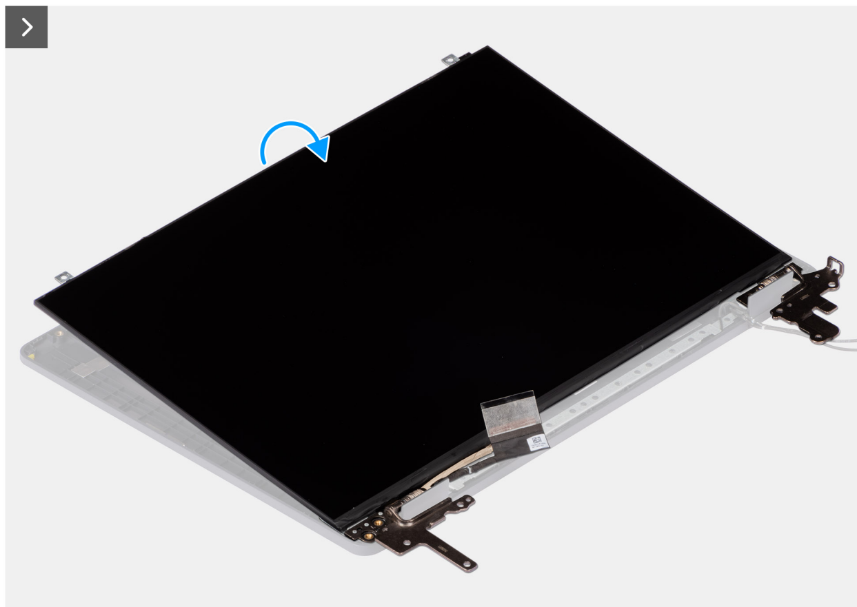
Ilustración 112. Extracción del ensamblaje del panel de pantalla
