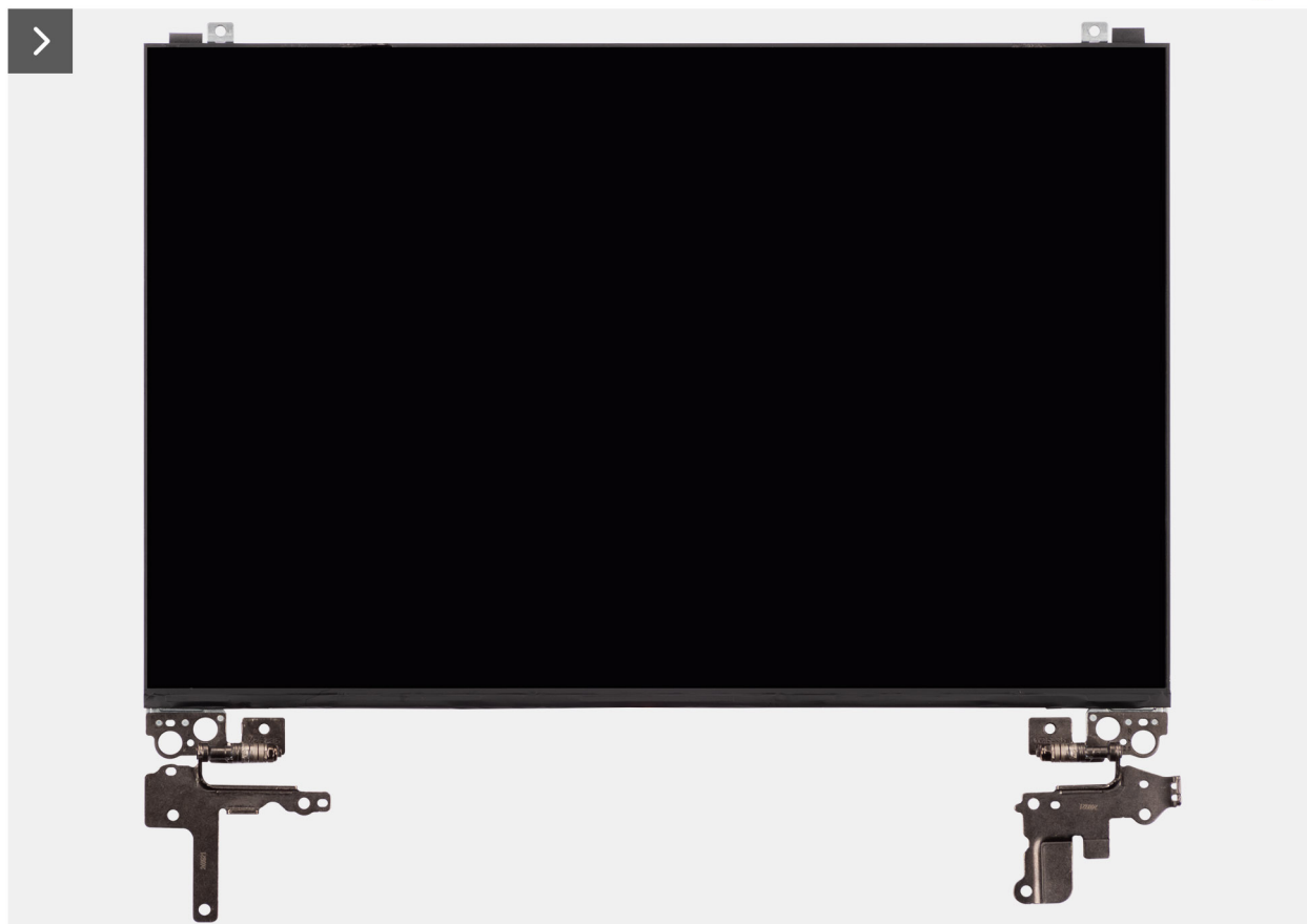
Ilustración 115. Instalación del ensamblaje del panel de pantalla
