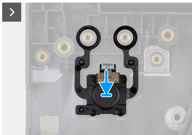
Ilustración 56. Instalación del botón de encendido con un lector de huellas digitales
