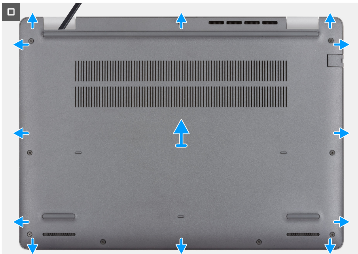
Ilustración 12. Extracción de la cubierta de la base
