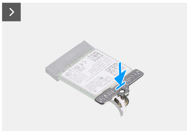
Ilustración 26. Instalación de la tarjeta inalámbrica
