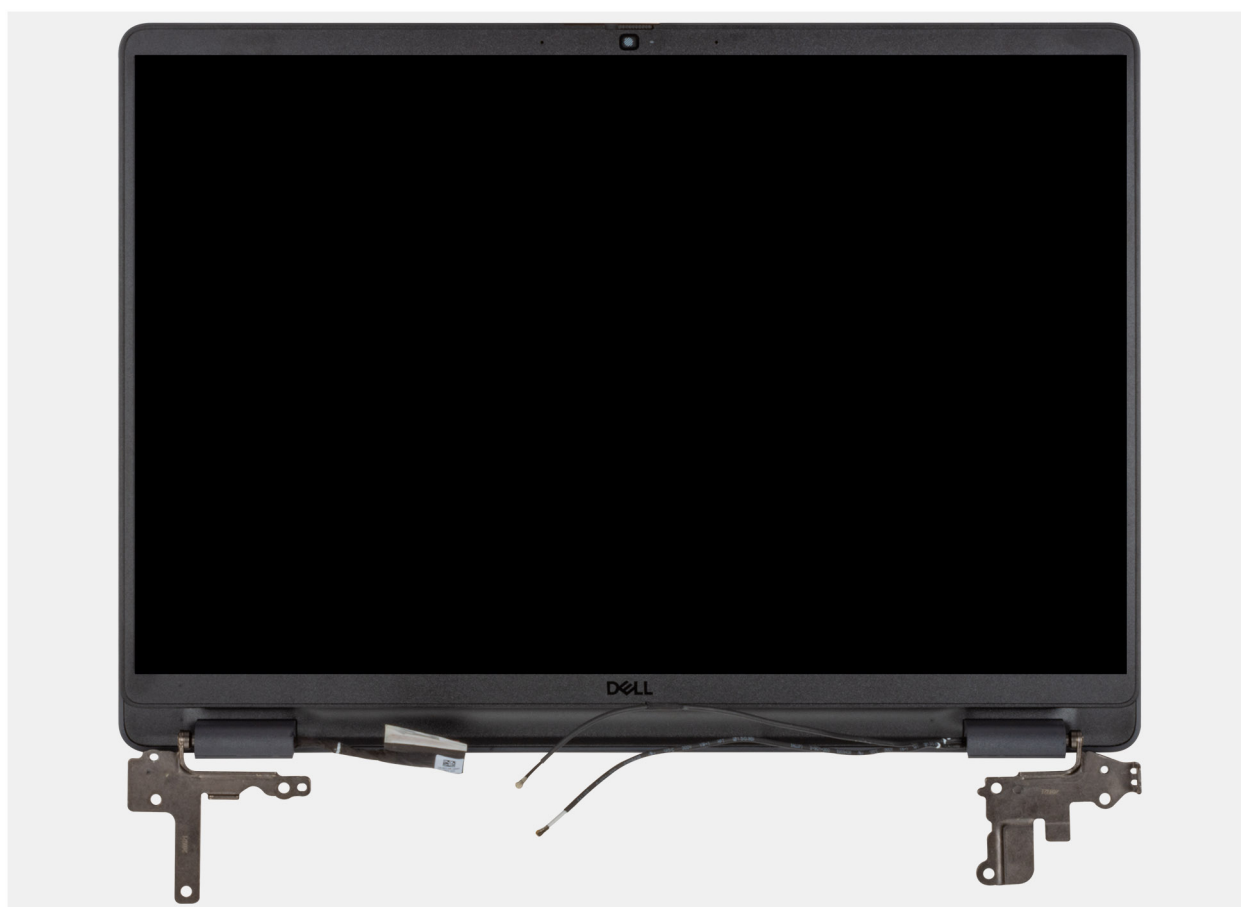
Ilustración 101. Extracción del ensamblaje de la pantalla
