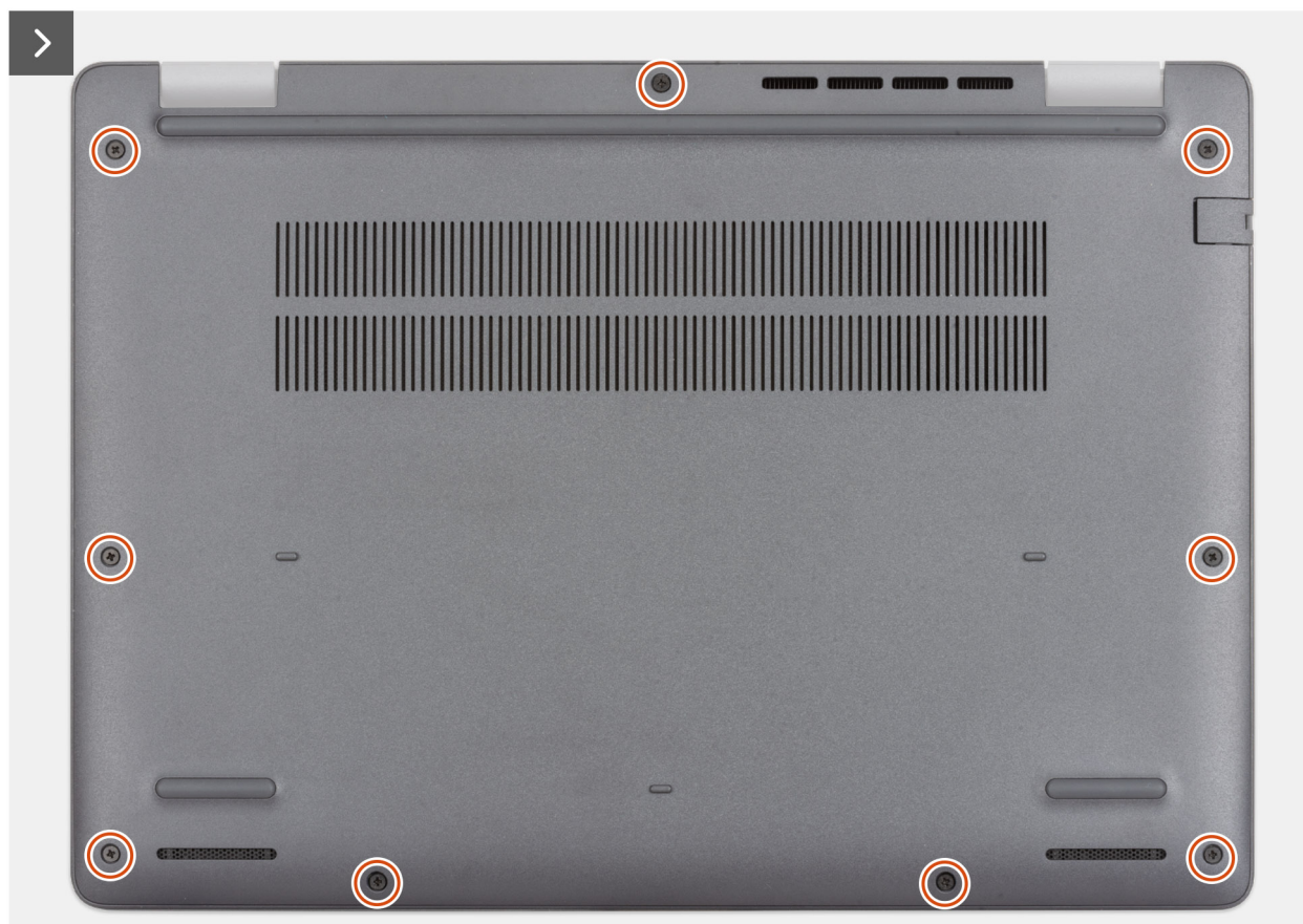
Ilustración 11. Extracción de la cubierta de la base
