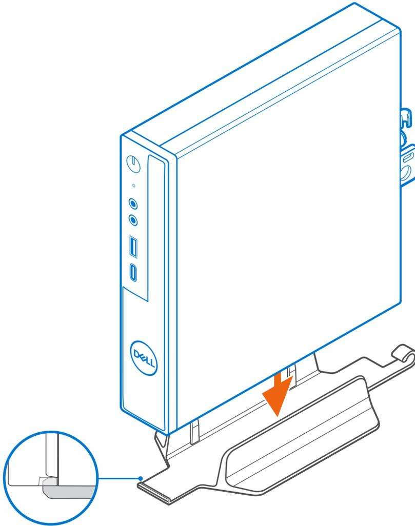
**NOTA:** Asegúrese de alinear la ranura del chasis con la lengüeta de la base vertical para evitar que la computadora salga de dicha base.
