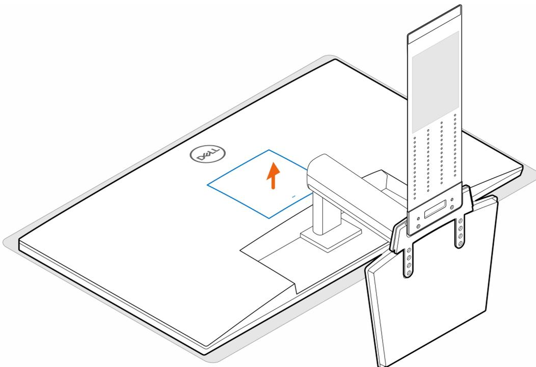
6. Instale los cuatro tornillos (M4x10) para fijar el montaje VESA al monitor.
