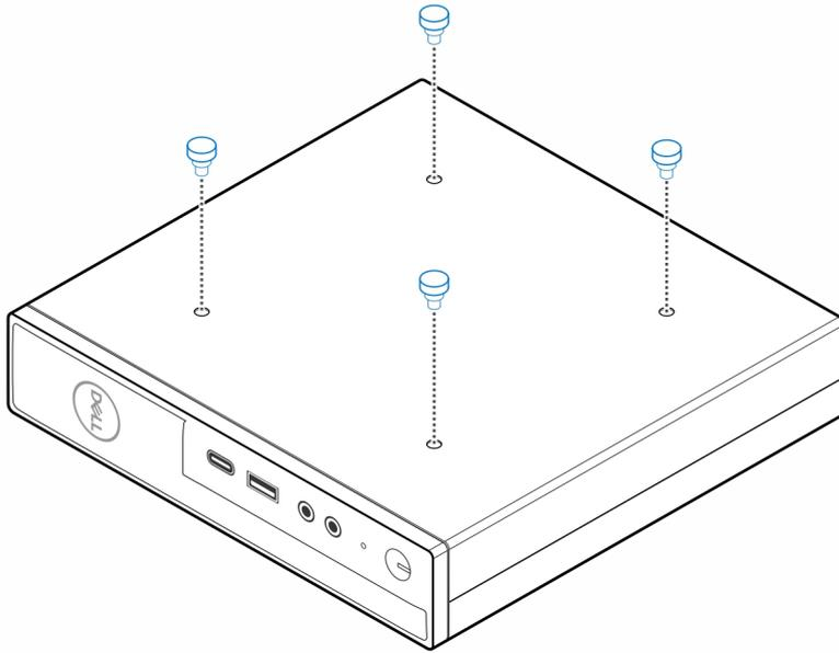
3. Alinee los tornillos pasantes (M4x4) con las muescas de la base todo en uno y monte la computadora en dicho dispositivo.
