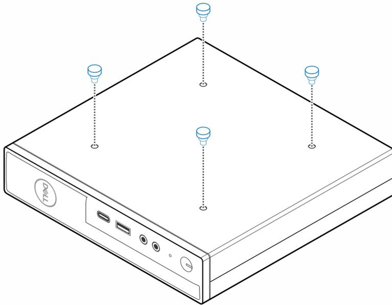
5. Alinee los tornillos pasantes (M4x4) con las muescas del montaje del escritorio y monte la computadora en dicho montaje.
