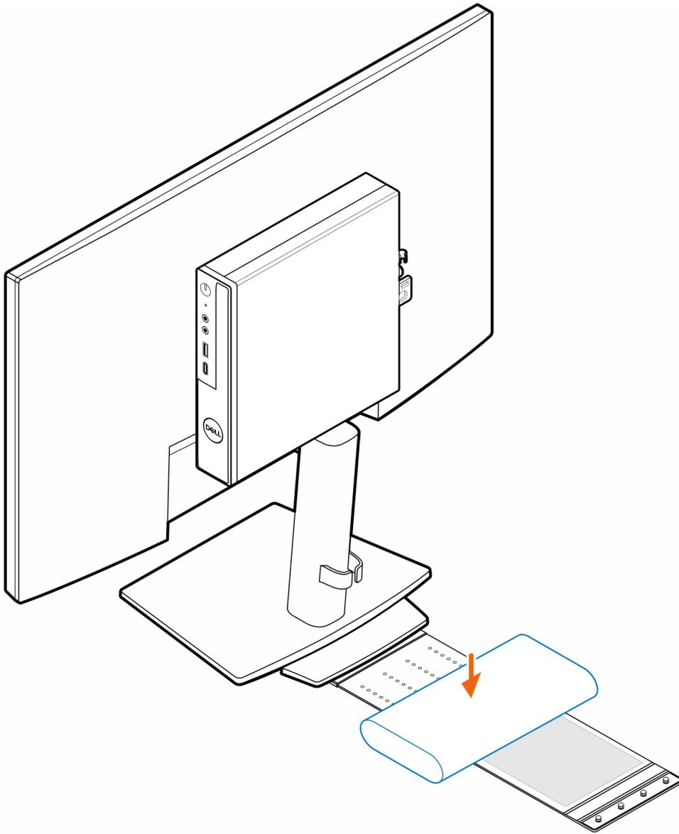
10. Ajuste la funda alrededor del adaptador de CA e inserte las lengüetas de retención en los orificios de dicho adaptador en el nivel apropiado.
