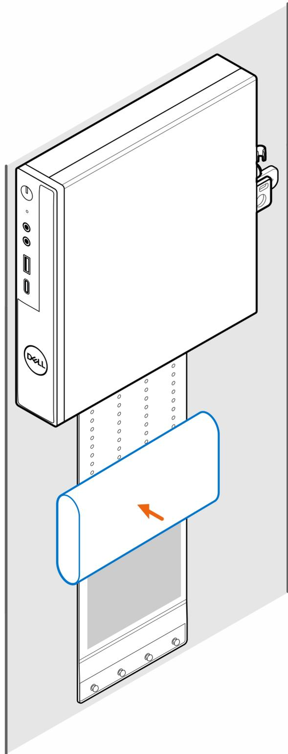
8. Ajuste la funda alrededor del adaptador de CA e inserte las lengüetas de retención en los orificios de dicho adaptador en el nivel apropiado.
