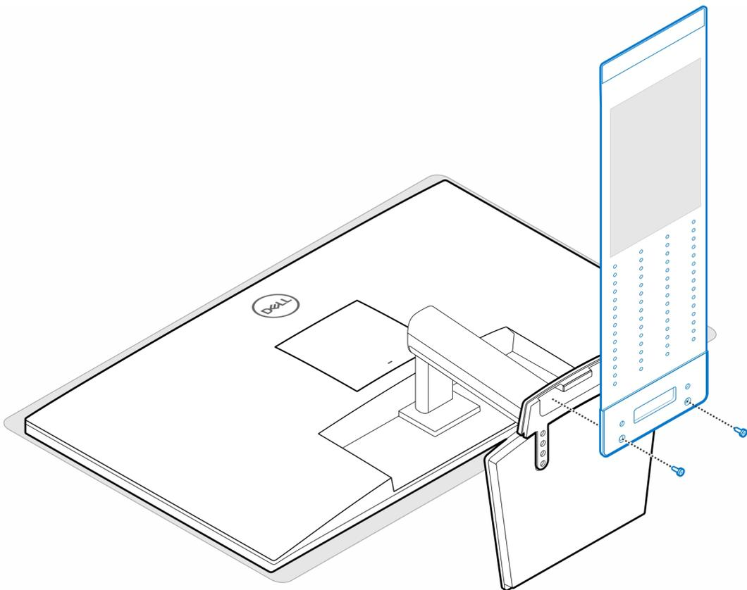
5. Extraiga la cubierta posterior del monitor.
