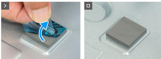
Ilustración 27. Extracción de la película plástica de la nueva almohadilla térmica
