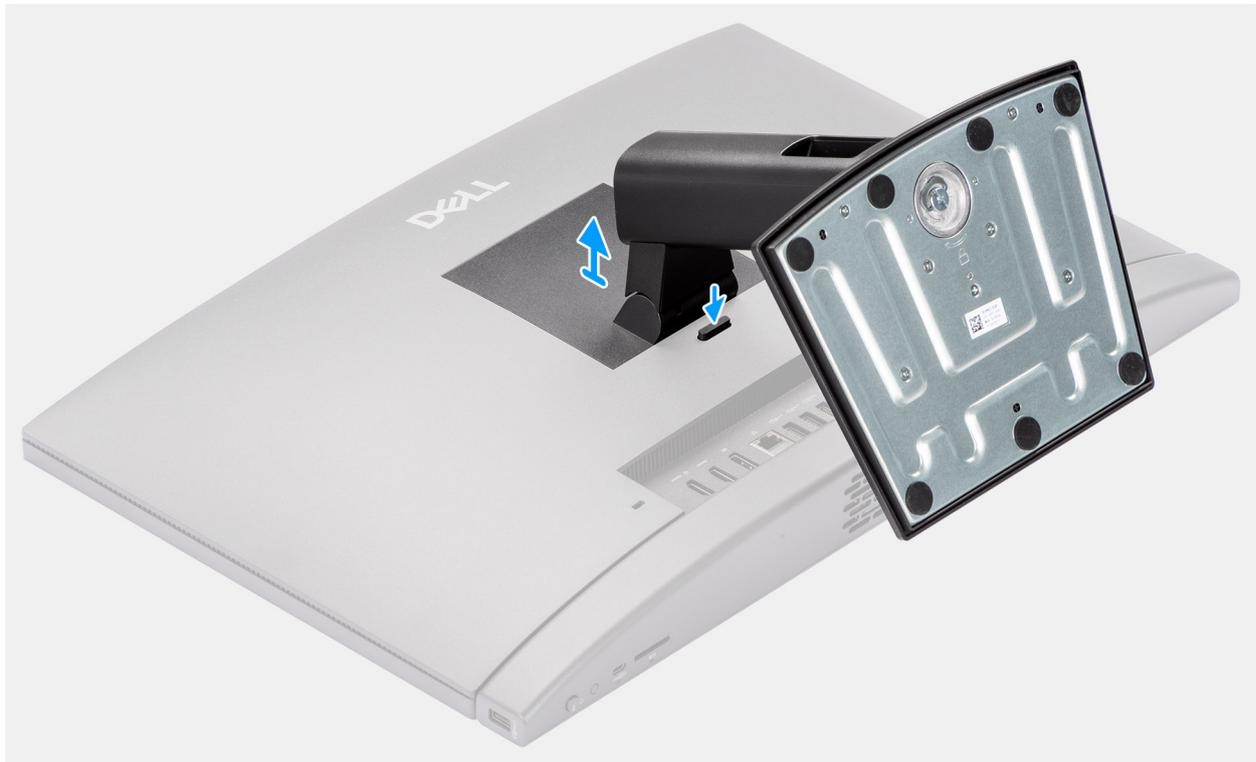
**Ilustración 32. Extracción de la base fija**
