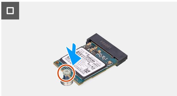
**Ilustración 47. Instalación de la unidad de estado sólido M.2 2230 en la ranura M.2 1**
