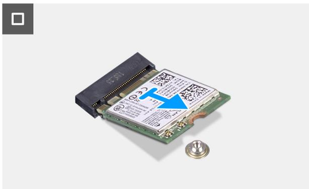
Ilustración 41. Extracción de la tarjeta inalámbrica
