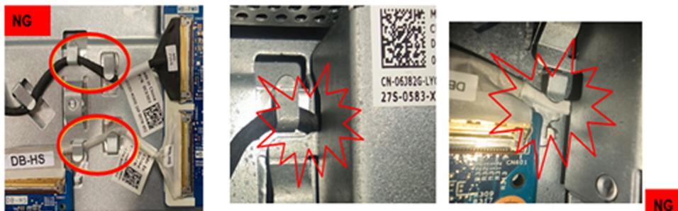
**Ilustración 18. Enrutamiento incorrecto del cable de alimentación (MB-PWR) y cable de alta velocidad (MB-HS)**
