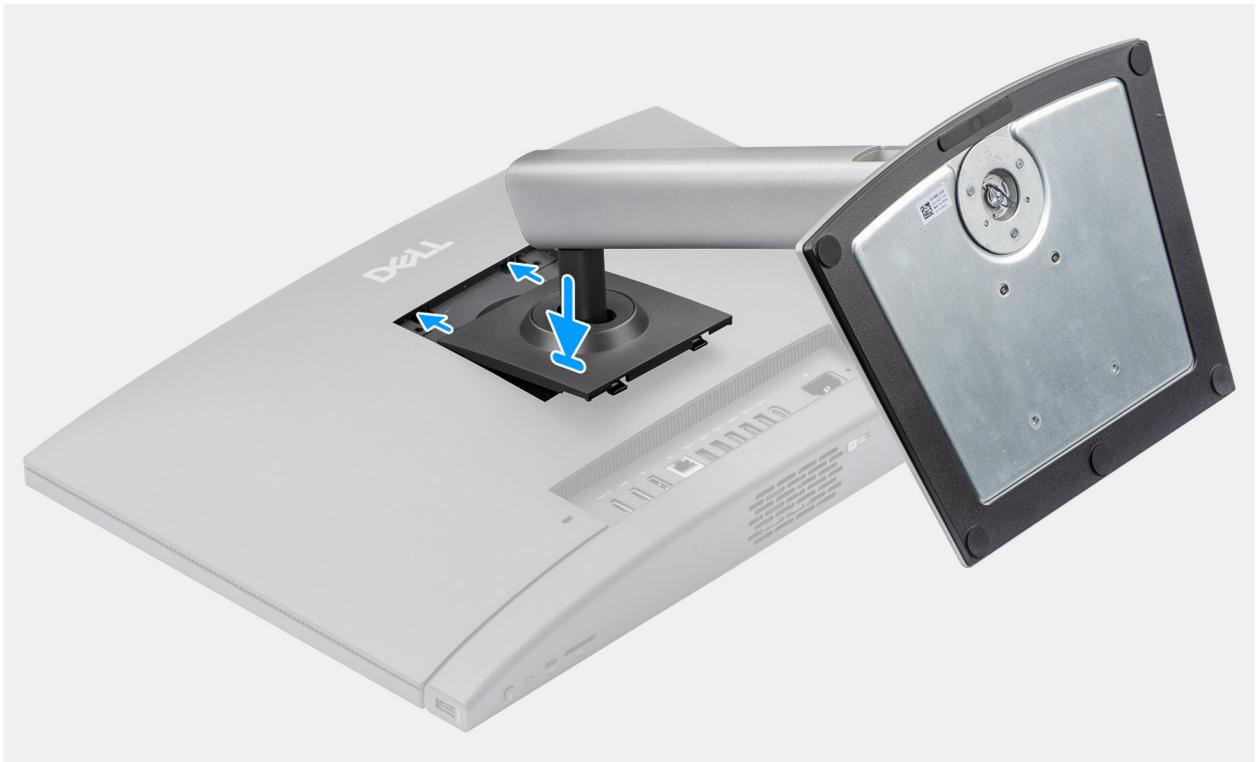
**Ilustración 33. Instalación de la base de altura regulable (HAS)**
