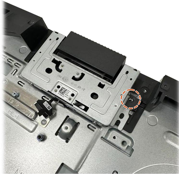
**Ilustración 28. Ensamblaje de la cámara no táctil**
