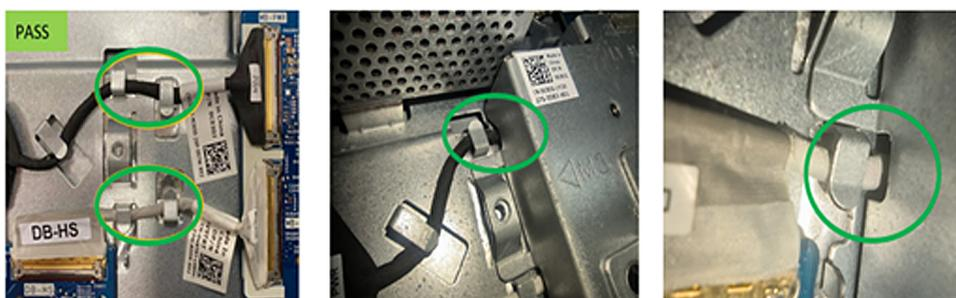
**Ilustración 17. Enrutamiento correcto del cable de alimentación (MB-PWR) y cable de alta velocidad (MB-HS)**
