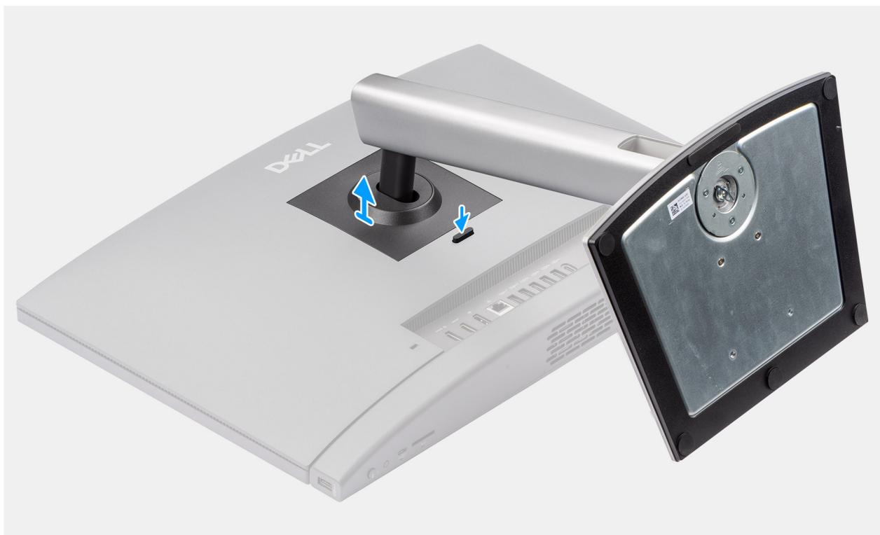
Ilustración 31. Extracción de la base de altura regulable (HAS)
