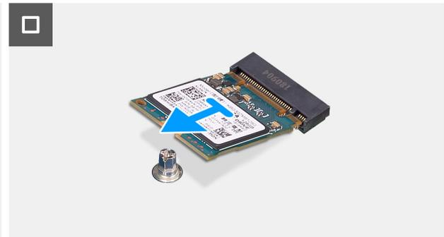
**Ilustración 46. Extracción de la unidad de estado sólido M.2 2230 de la ranura M.2 1**
