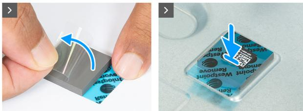
Ilustración 26. Instalación de la nueva almohadilla térmica
