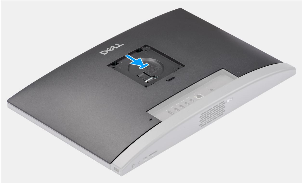
**Ilustración 36. Instalación de la cubierta posterior**
