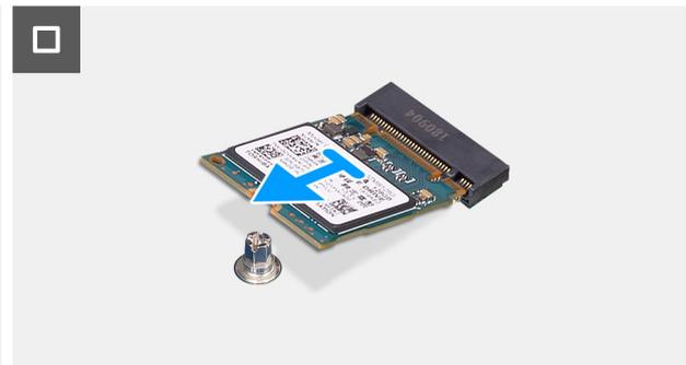
Ilustración 43. Extracción de la unidad de estado sólido M.2 2230 de la ranura M.2 0
