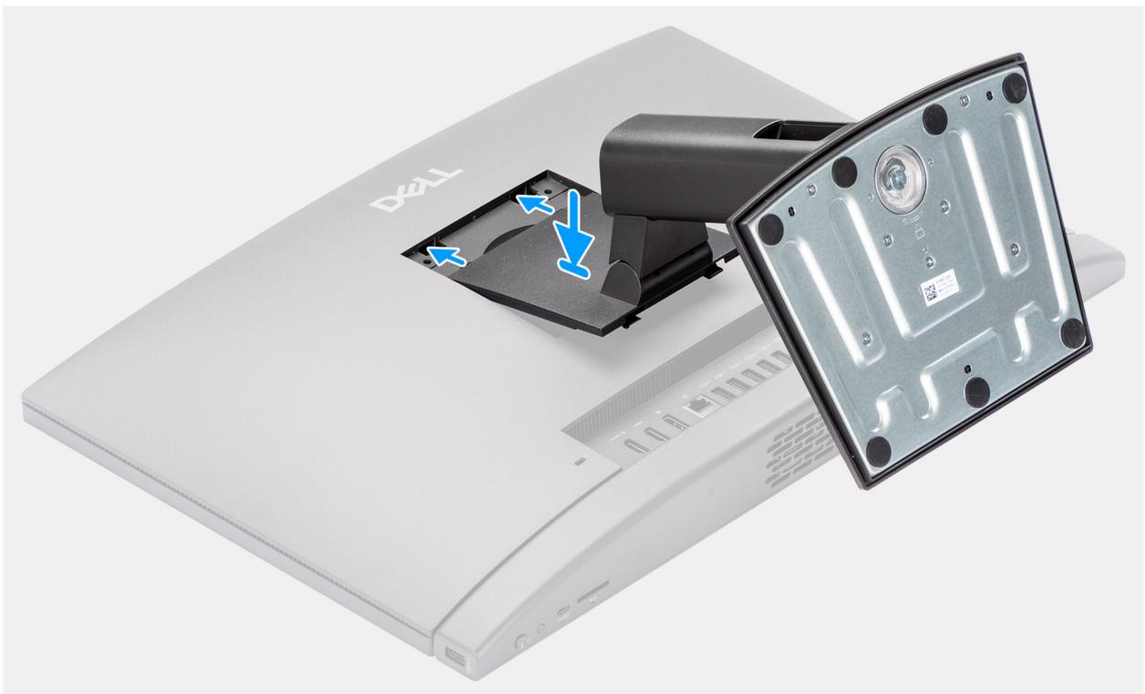
**Ilustración 34. Instalación de la base fija**
