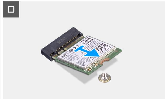
**Ilustración 23. Extracción de la tarjeta inalámbrica**
