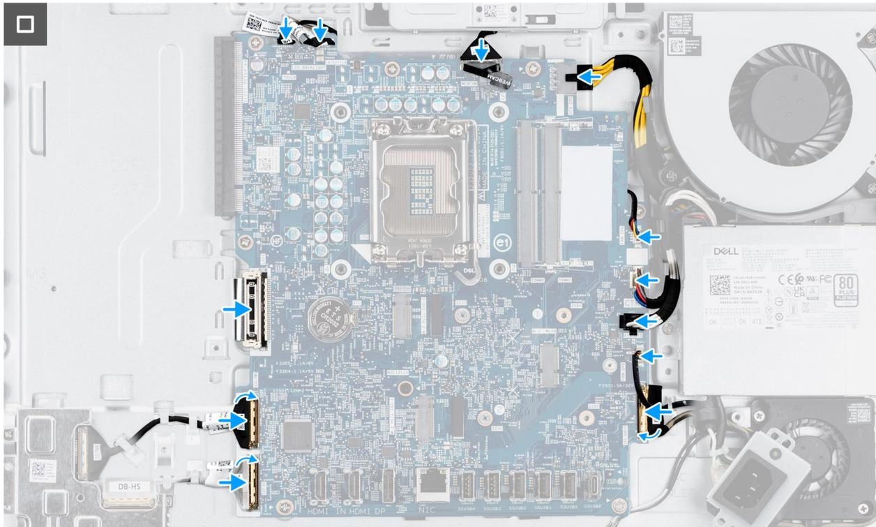
**Ilustración 58. Instalación de la tarjeta madre**
