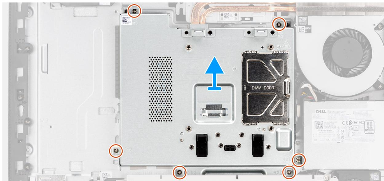
**Ilustración 21. Extracción del protector de la tarjeta madre**
