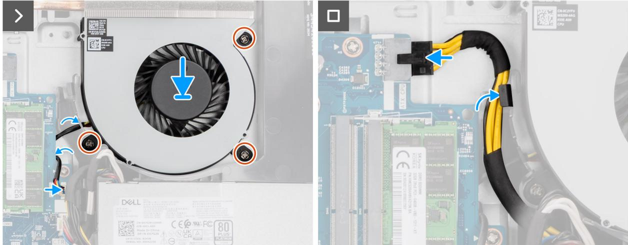
**Ilustración 40. Instalación del ventilador**
