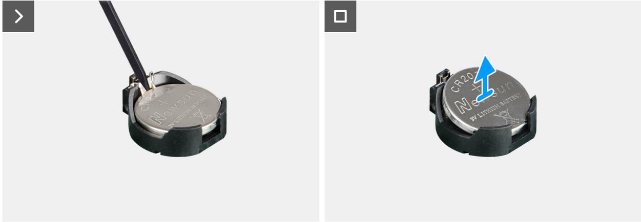
**Ilustración 31. Extracción de la batería de tipo botón**
