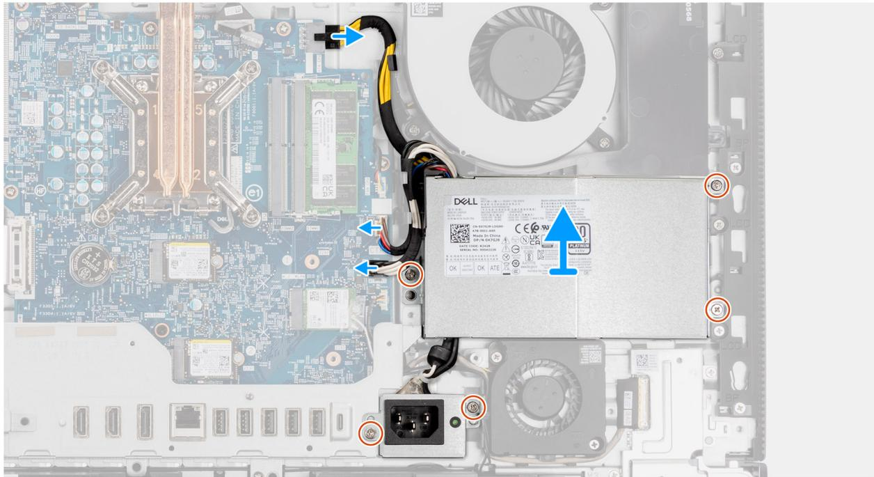
**Ilustración 41. Extracción de la fuente de alimentación**
