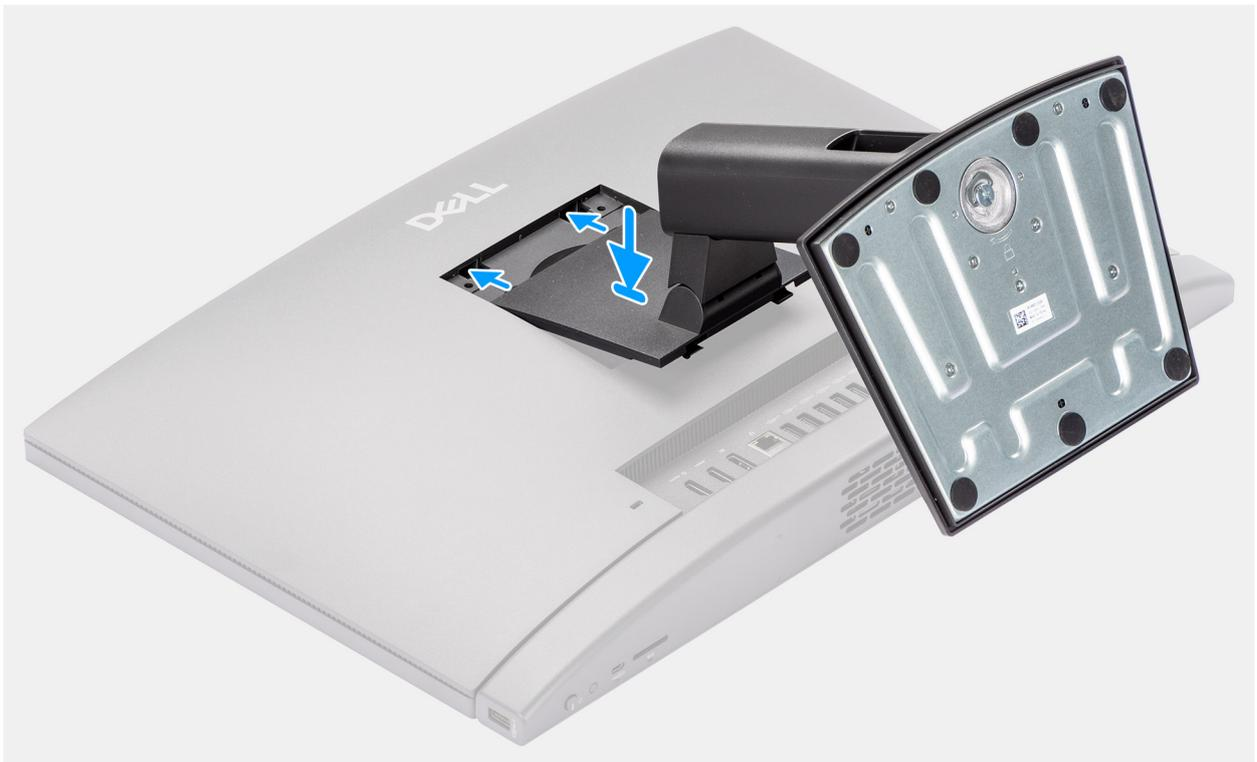
**Ilustración 16. Instalación de la base fija**
