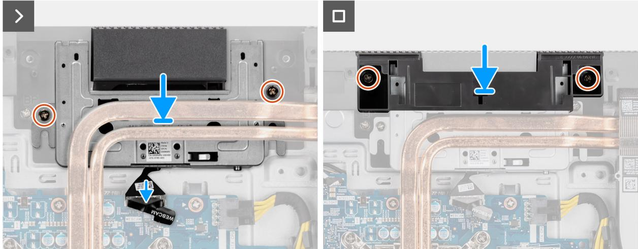
**Ilustración 38. Instalación del ensamblaje de la cámara retráctil**
