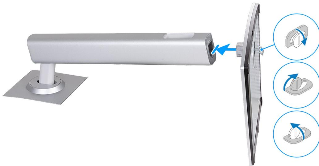
**Ilustración 8. Instalación de la base del soporte**
