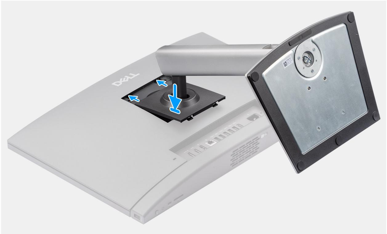
**Ilustración 15. Instalación de la base de altura regulable (HAS)**
