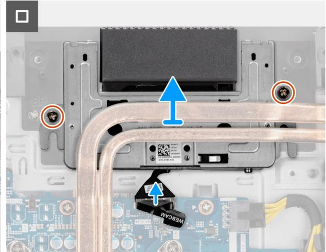
**Ilustración 37. Extracción del ensamblaje de la cámara retráctil**
