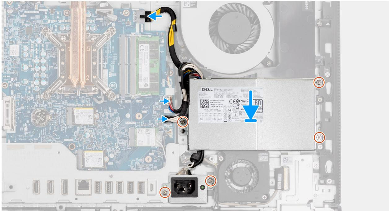
**Ilustración 42. Instalación de la fuente de alimentación**
