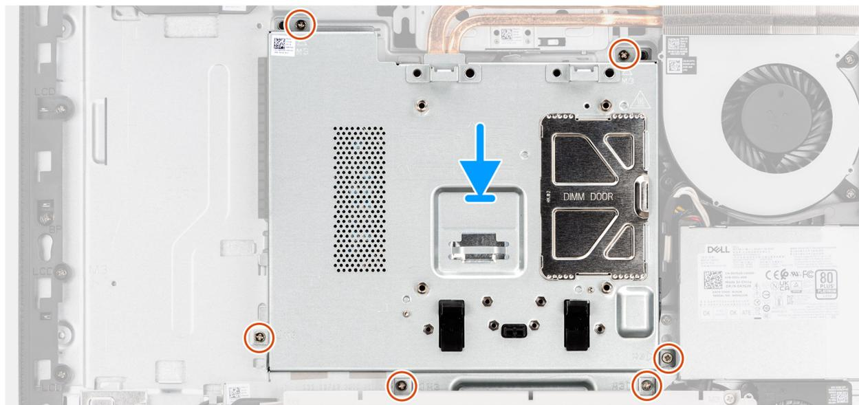
**Ilustración 22. Instalación del protector de la tarjeta madre**
