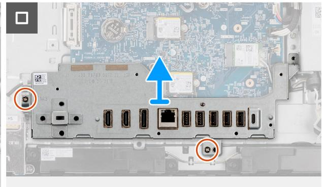
**Ilustración 45. Extracción del soporte de I/O**
