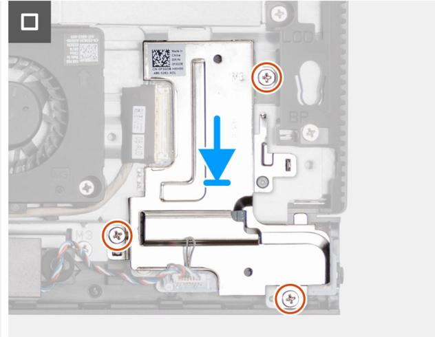
**Ilustración 62. Instalación de la placa de audio**
