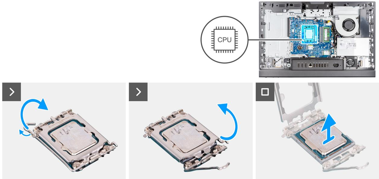
**Ilustración 51. Extracción del procesador**
