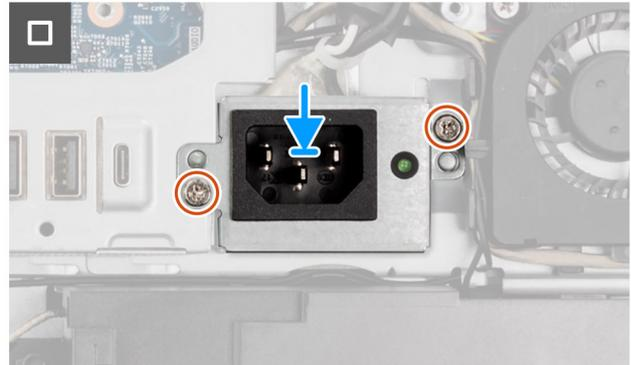
**Ilustración 46. Instalación del soporte de I/O**
