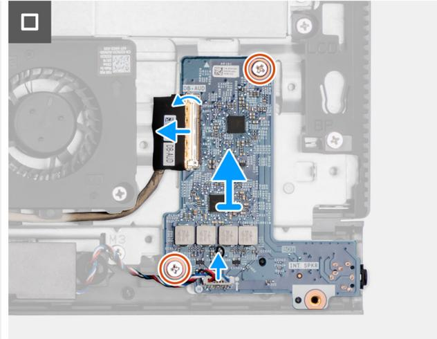
**Ilustración 61. Extracción de la placa de audio**
