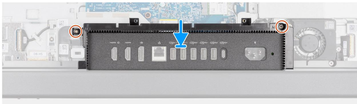
**Ilustración 34. Instalación de la cubierta de I/O**
