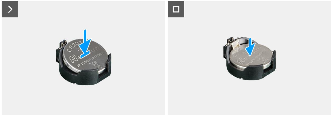
**Ilustración 32. Instalación de la batería de tipo botón**
