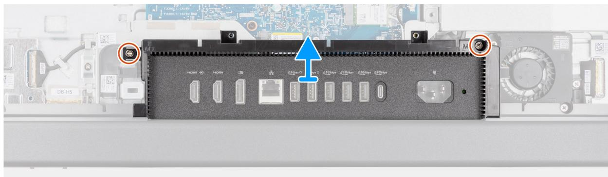
**Ilustración 33. Extracción de la cubierta de I/O**
