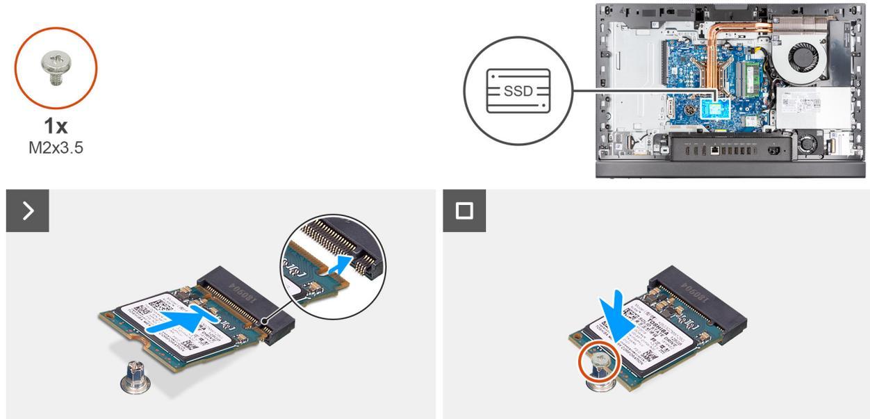
**Ilustración 26. Instalación de la unidad de estado sólido M.2 2230 en la ranura M.2 0**
