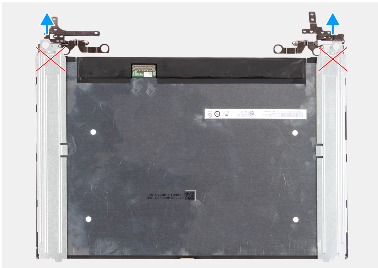
Ilustración 67. Extracción del panel de pantalla
