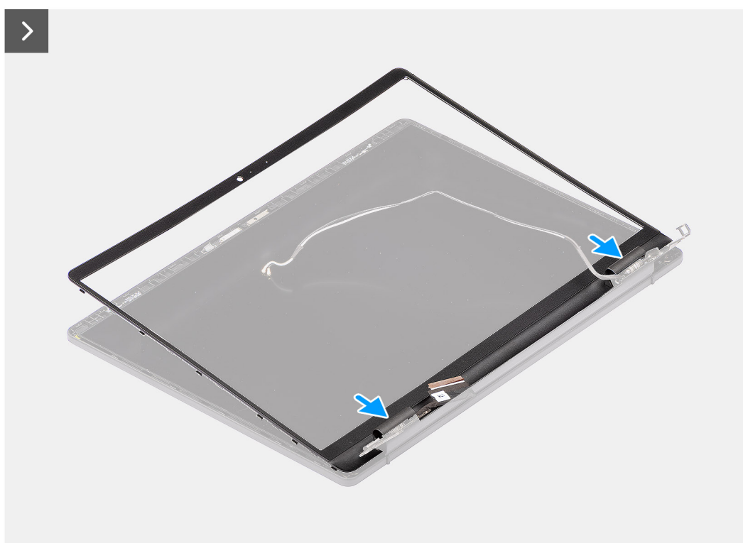
Ilustración 61. Instalación del bisel de la pantalla
