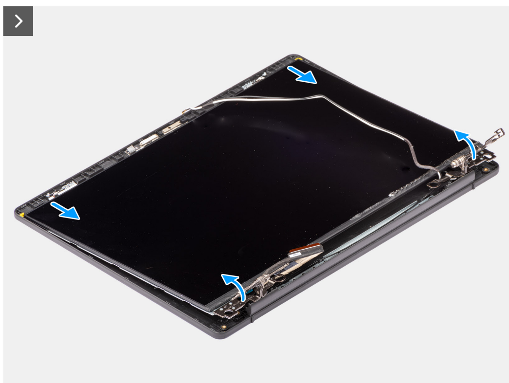
Ilustración 65. Extracción del panel de pantalla
