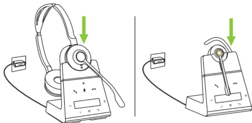
El auricular se carga cuando se acopla en la base, siempre que la base esté conectada a la red eléctrica. El LED de estado del auricular y el icono de batería de la base parpadearán para indicar que el auricular está cargando.
