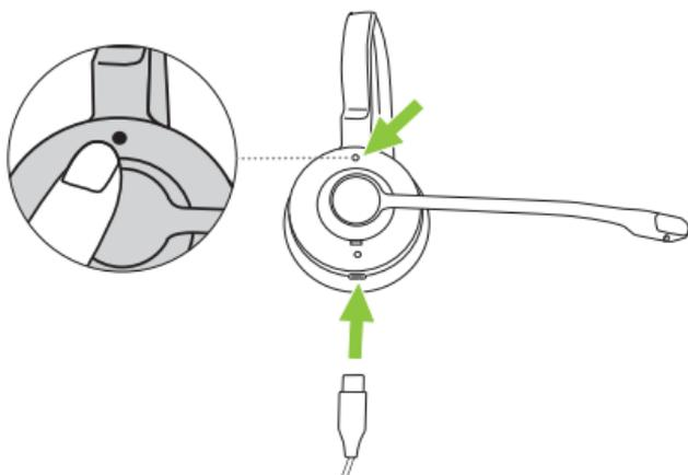
3. Podrá seleccionar el auricular como dispositivo de reproducción de audio en el ordenador. Si conecta el auricular con el cable USB, no podrá utilizar el control de llamadas ni la función de luz de ocupado del auricular.
