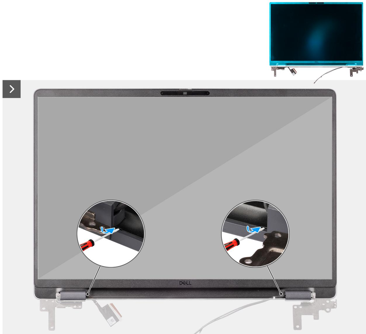
**Ilustración 77. Removing the display bezel**
