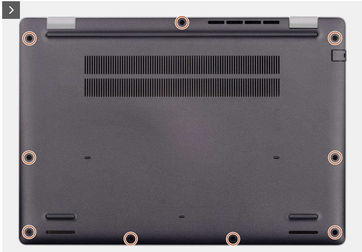
Ilustración 11. Removing the base cover
