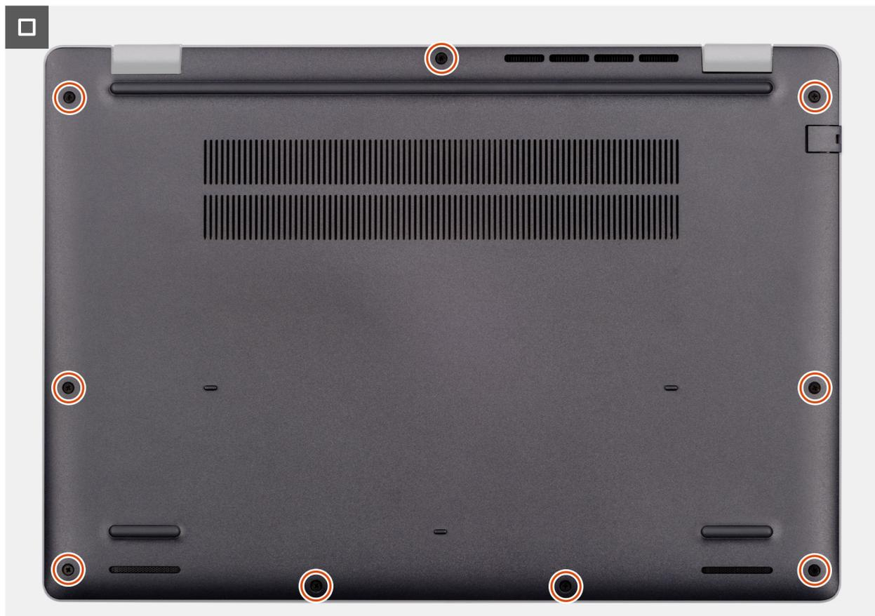
Ilustración 16. Installing the base cover
