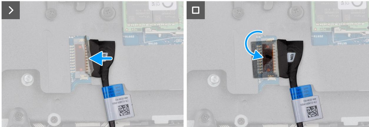
Ilustración 14. Connecting the battery cable
