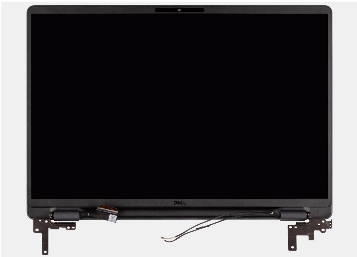
**Ilustración 74. Removing the display assembly**
