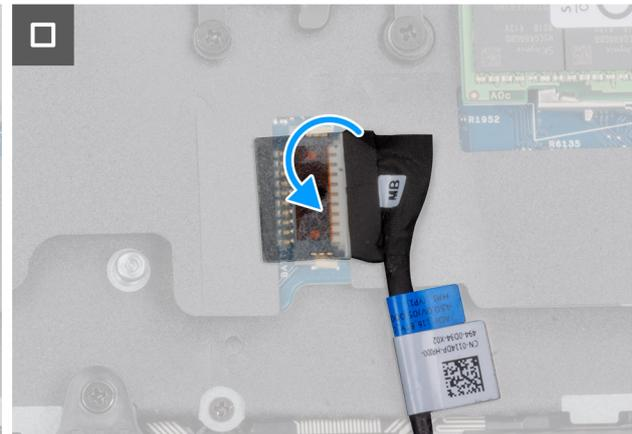
**Ilustración 18. Installing the battery**
