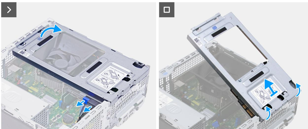
**Ilustración 18. Extracción de la bahía de rotación**
