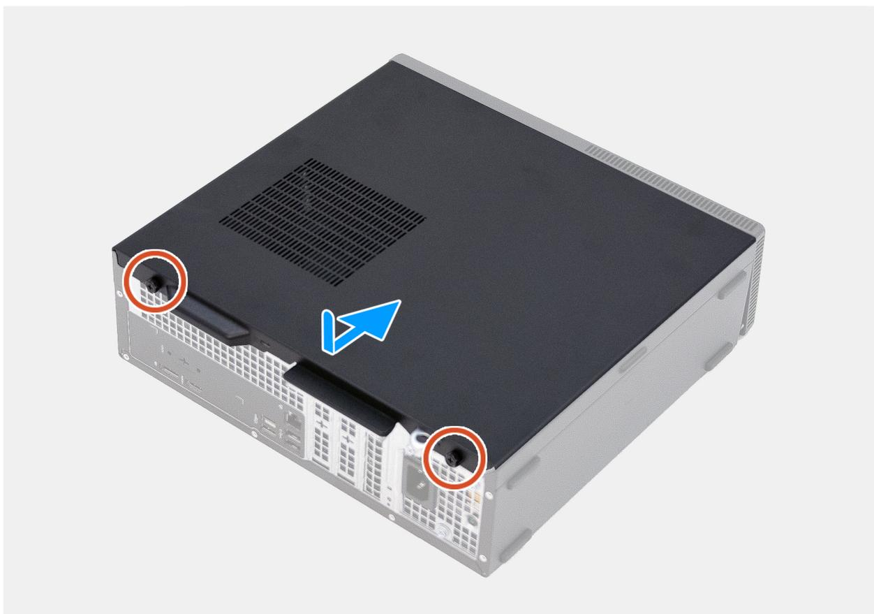
**Ilustración 11. Instalación de la cubierta lateral izquierda**
