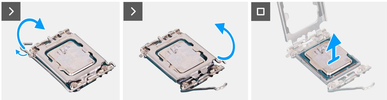
**Ilustración 40. Extracción del procesador**
