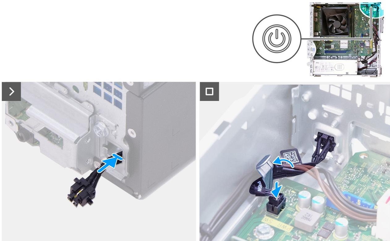
**Ilustración 43. Instalación del botón de encendido**
