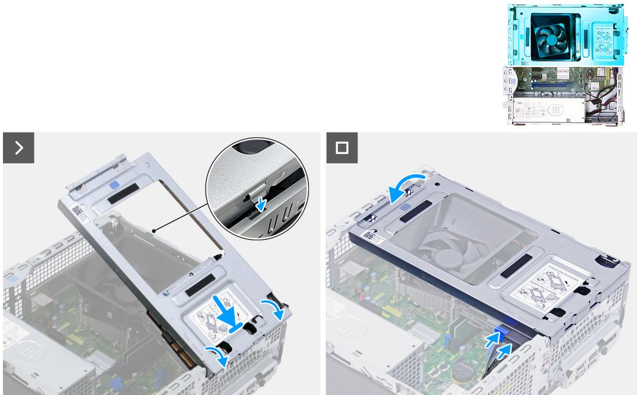
**Ilustración 19. Instalación de la bahía de rotación**
