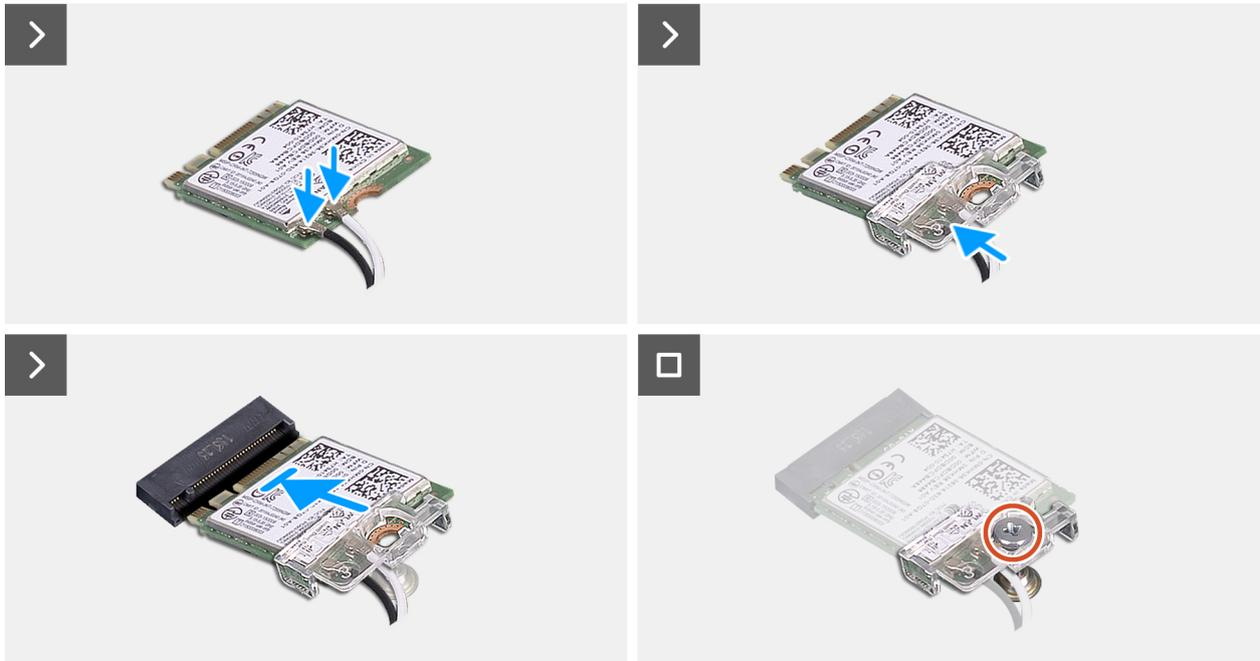
**Ilustración 27. Instalación de la tarjeta inalámbrica**
