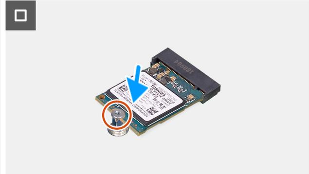
**Ilustración 25. Instalación de la unidad de estado sólido M.2 2230**
