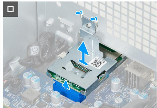
**Ilustración 28. Extracción del lector de tarjetas de medios**
