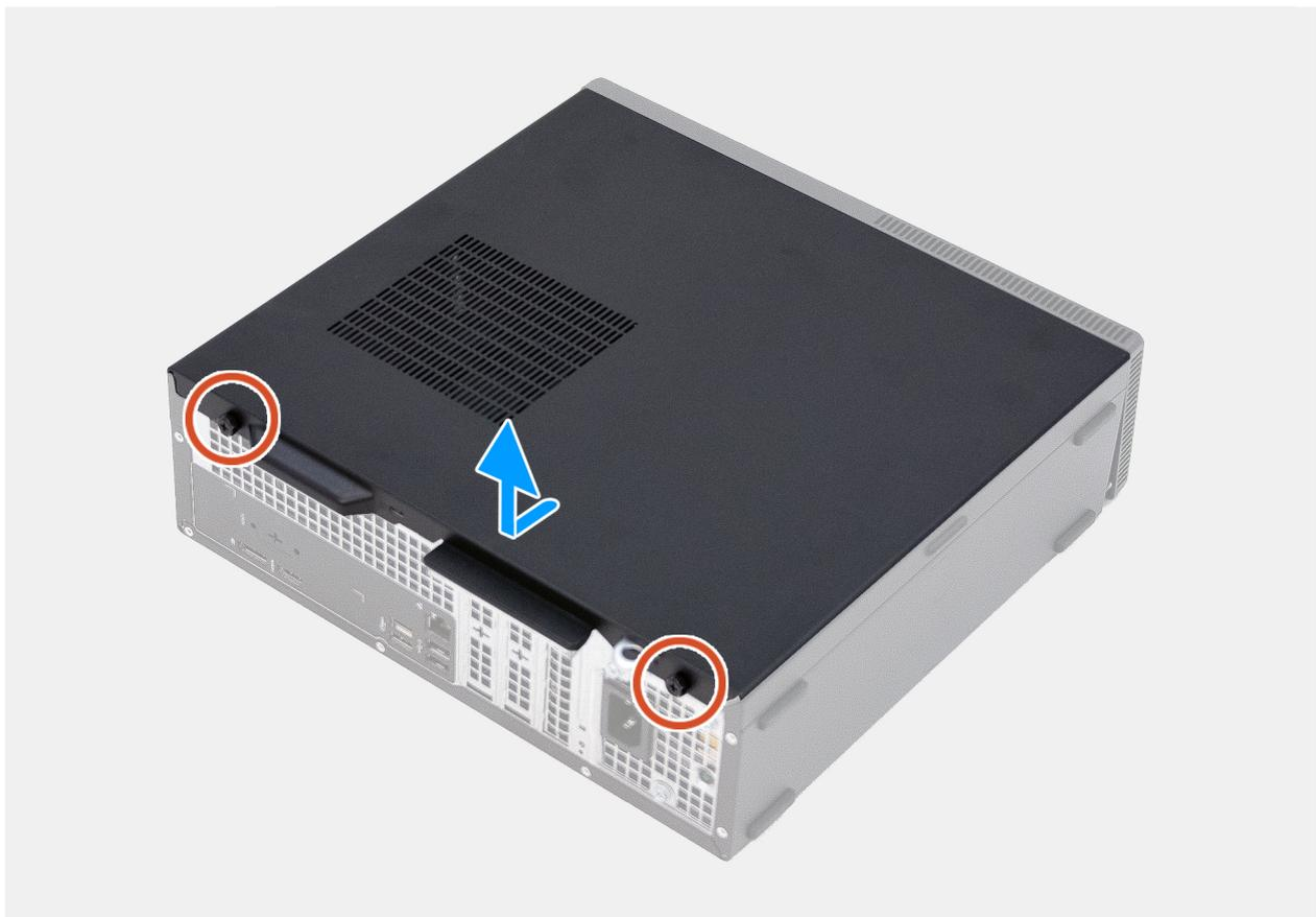
Ilustración 10. Extracción de la cubierta lateral izquierda
