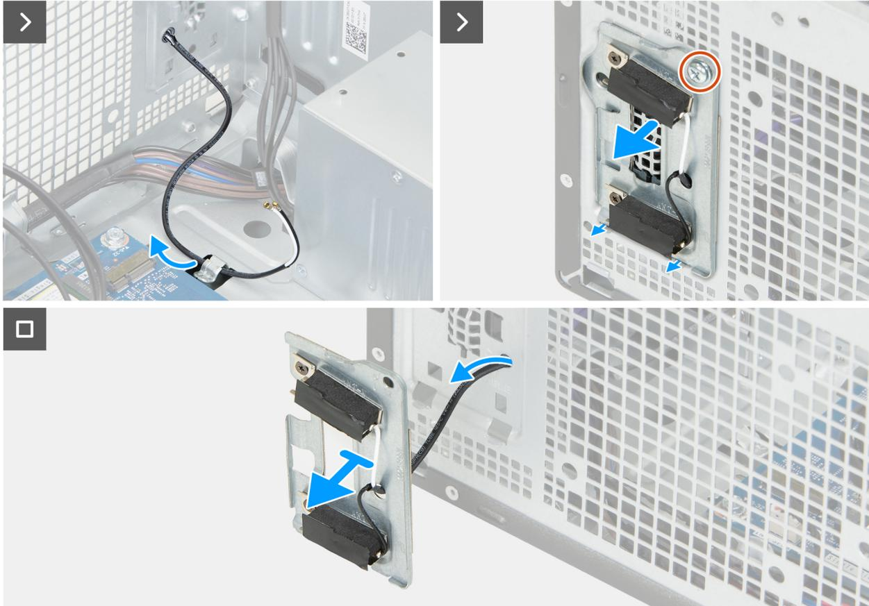
**Ilustración 30. Extracción del módulo de la antena**
