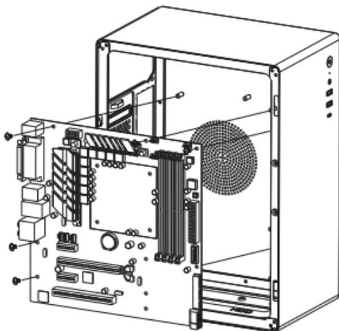
Coloque la M/B en el gabinete alineado a los orificios, después fije la M/B con tornillos como se muestra en la imagen.
