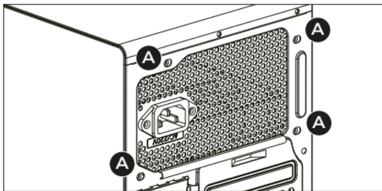
Coloque la fuente de alimentación en la posición indicada en la imagen y apriete los 4 tornillos de la posición "a".
