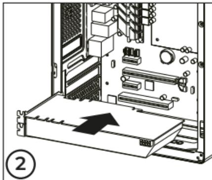
Inserte la tarjeta de video en el slot de la tarjeta madre en dirección de la flecha de la imagen.
