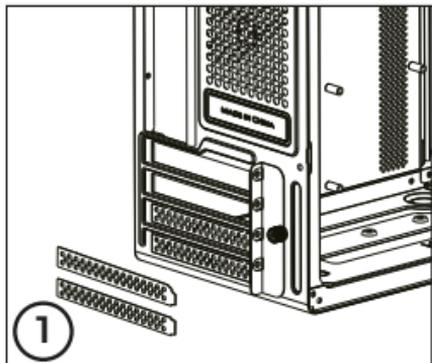
Retire los tornillos de la barra de fijación colocados ranuras PCI, quite la barra de sujeción y por ultimo remueva las tapas de las ranuras PCI.
