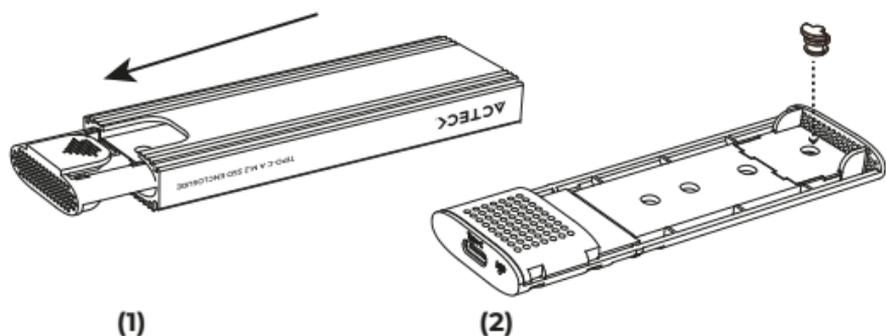
3. Inserta el disco en un ángulo de 45° haciendo coincidir los conectores en la ranura. Después, mueve el puente para asegurar la unidad.
