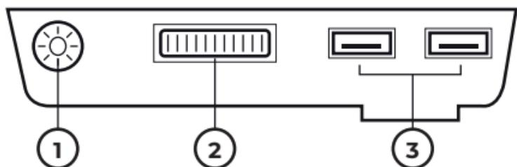
1. Botón Luz LED (presione una vez para cambiar el color del LED, presione mas de 5 segundos para ENCENDER/APAGAR el LED)
