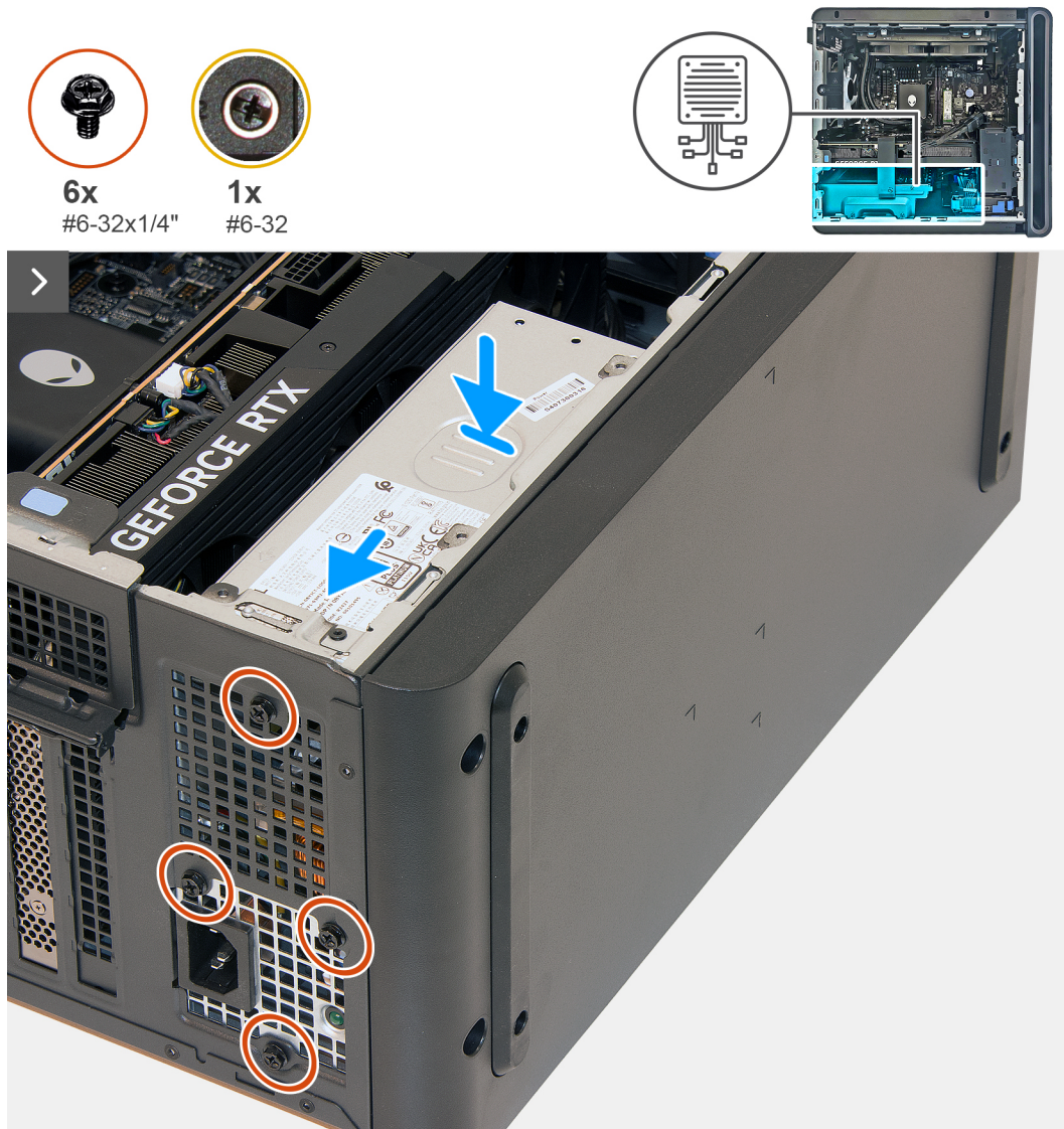
Ilustración 47. Instalación de la fuente de alimentación
