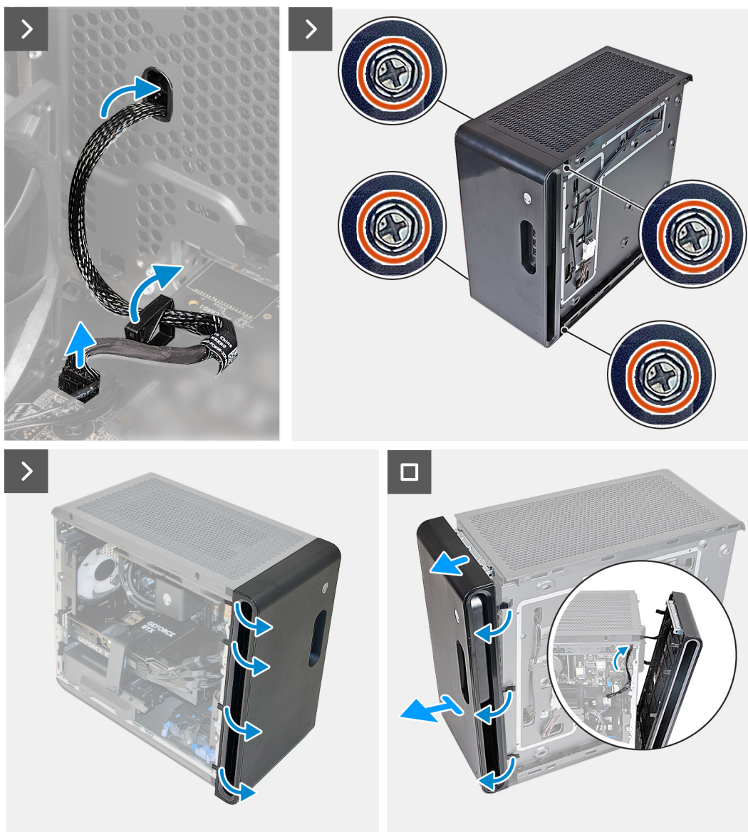
Ilustración 18. Extracción del bisel frontal
