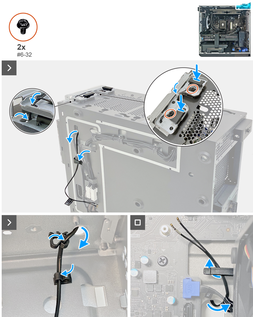
Ilustración 58. Instalación de la antena
