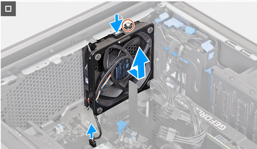
Ilustración 31. Extracción del ventilador del chasis frontal inferior
