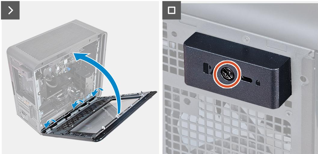
**Ilustración 6. Instalación de la cubierta lateral izquierda**
