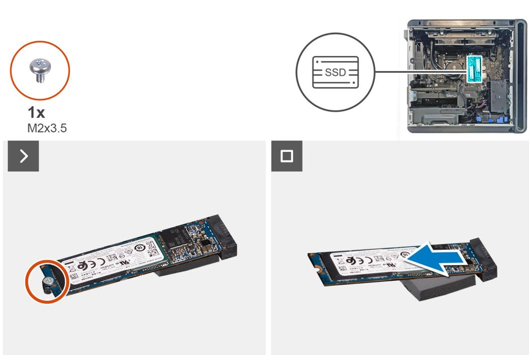
**Ilustración 26. Extracción de la unidad de estado sólido M.2 2280**
