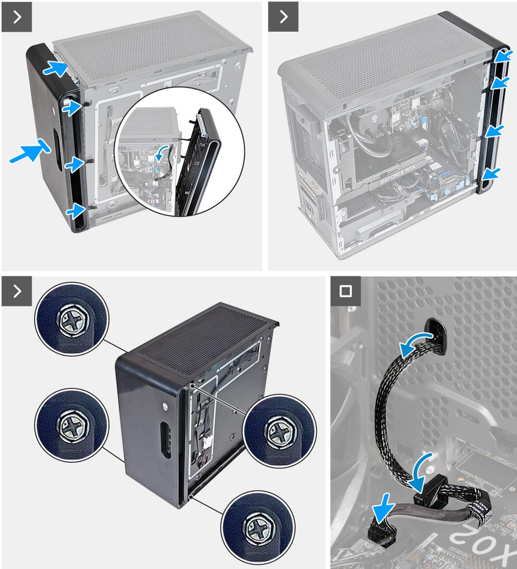
Ilustración 10. Instalación del bisel frontal
