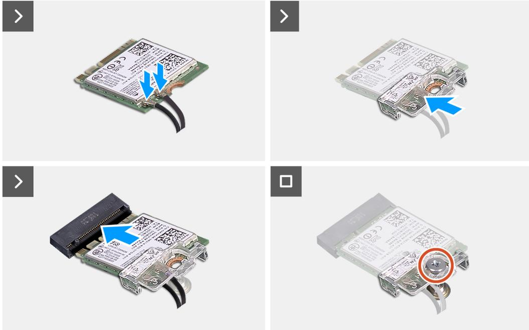
**Ilustración 30. Instalación de la tarjeta inalámbrica**
