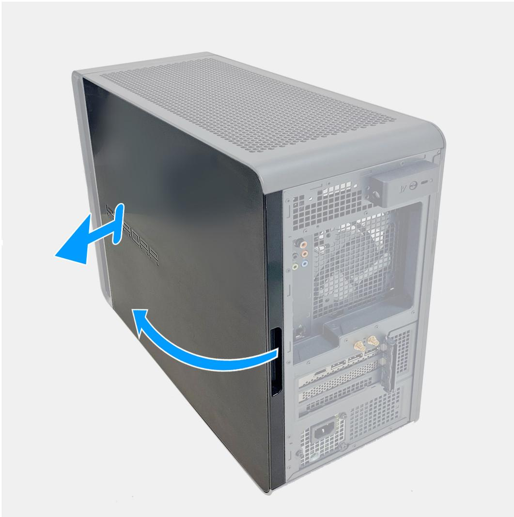
**Ilustración 7. Extracción de la cubierta lateral derecha**
