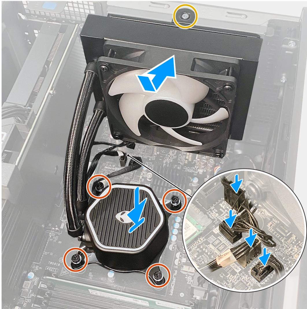
**Ilustración 42. Instalación del ensamblaje de enfriamiento líquido del procesador**
