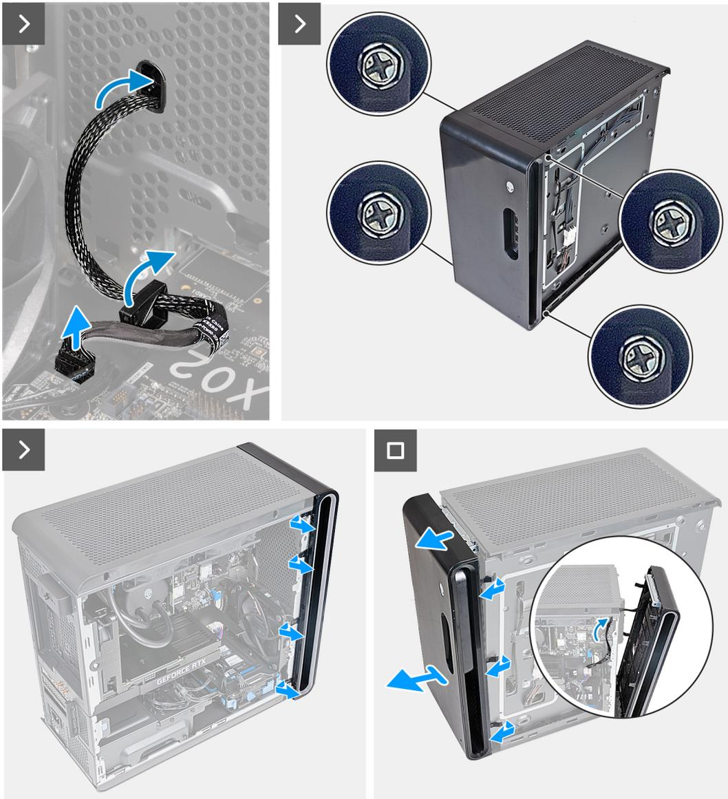
**Ilustración 9. Extracción del bisel frontal**
