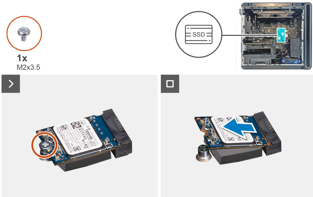
**Ilustración 23. Extracción de la unidad de estado sólido M.2 2230**
