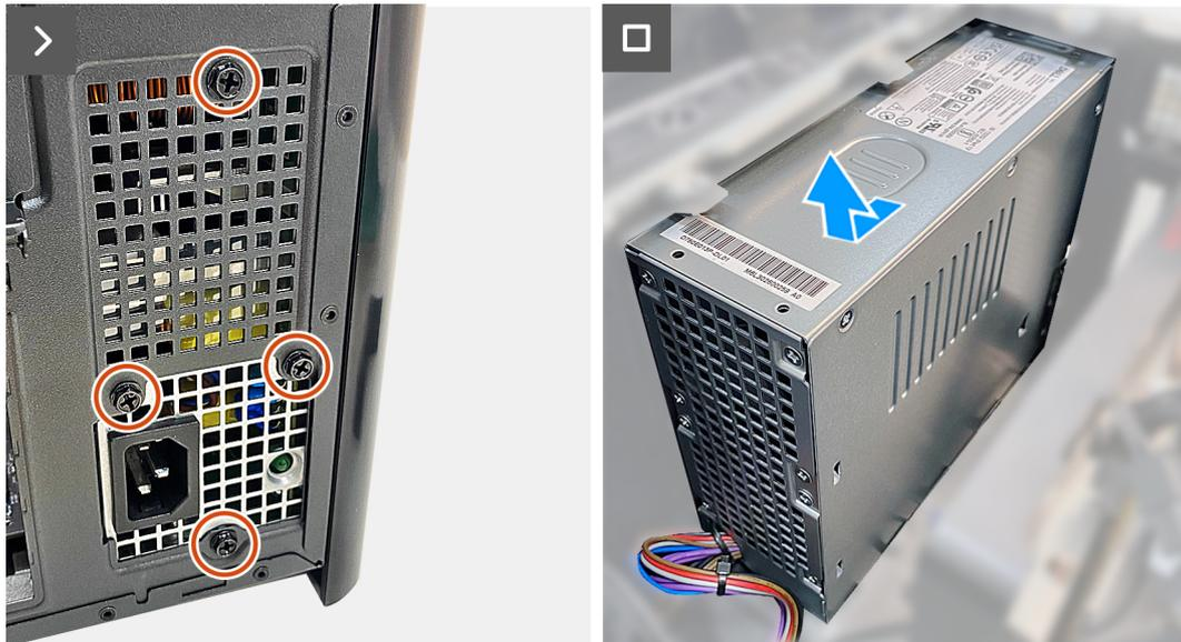
**Ilustración 36. Extracción de la fuente de alimentación**
