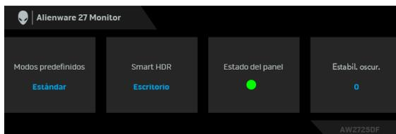
Normalmente, el **Estado del panel** muestra un punto verde. Cuando aparezca un punto amarillo, es recomendable realizar una **Actualización de píxeles**; cuando aparezca un punto rojo, significará que el monitor se ha utilizado durante 9000 horas sin realizar una **Actualización del panel**. Para más información, consulte [Mantenimiento del panel OLED](#).
