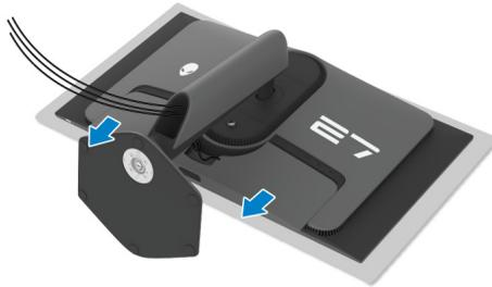
5. Desconecte los cables del monitor y páselos a través de la ranura de almacenamiento de cable en el elevador de soporte.
