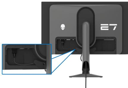
11. Conecte los cables necesarios al monitor, como el cable DisplayPort-DisplayPort, el cable USB-C-DisplayPort, el cable HDMI, los cables USB 3.2 Gen 1 (5 Gbps) ascendentes y descendentes, etc.
