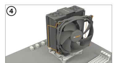
Fije el ventilador de 120 mm (2) en la unidad de refrigeración (1) utilizando clips de ventilador (16). Conecte el ventilador a la señal PWM de la placa base
