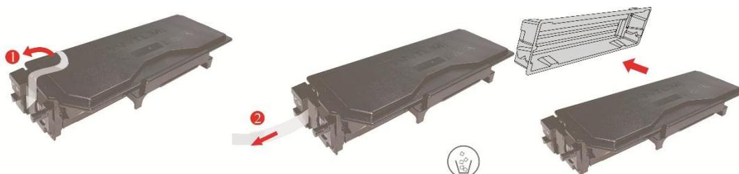
6. Instalar el cartucho en los componentes de tambor a lo largo de la pista de los componentes, instalación completa caja.
