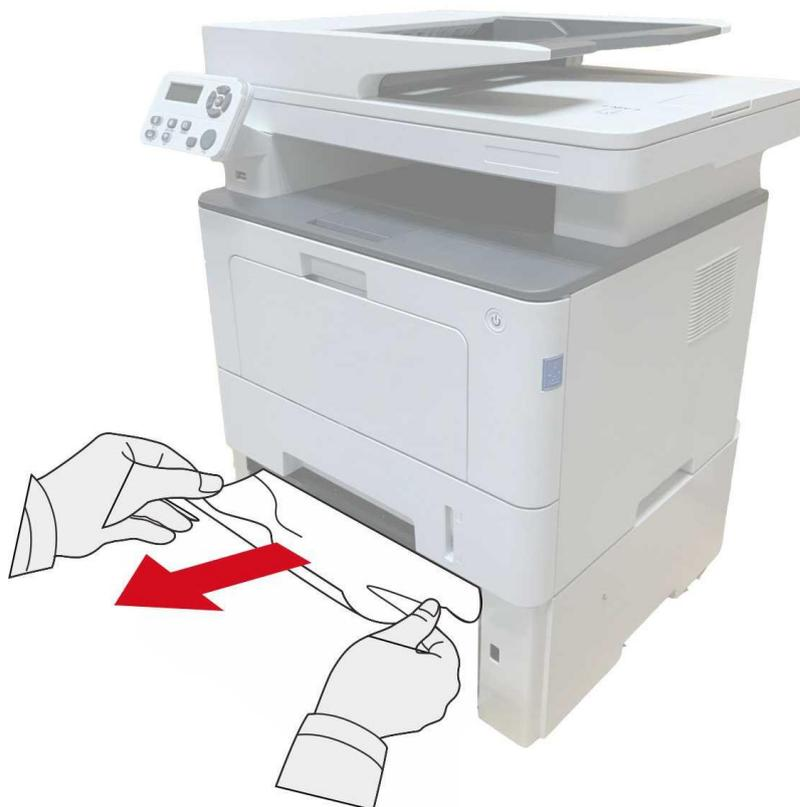
3. Después de retirar el papel atascado, vuelva a insertar la bandeja opcional en la impresora y ésta reanudará la impresión automáticamente.
