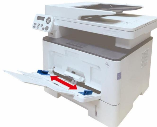
3. Despliegue la pila de papel para evitar errores de alimentación o atascado, y coloque el papel a imprimir en la bandeja de alimentación mirando hacia arriba. La bandeja de alimentación multifunción puede sujetar hasta 60 papeles de 80g/m<sup>2</sup> cada uno.
