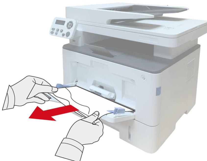
2. Después de retirar el papel atascado, vuelva a cargar el papel en la bandeja multiuso; pulse el botón de la cubierta frontal para abrir y cerrar la cubierta frontal, y la impresora reanudará la impresión.
