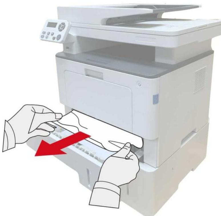
3. Después de retirar el papel atascado, vuelva a insertar la bandeja automática en la impresora y ésta reanudará la impresión automáticamente.
