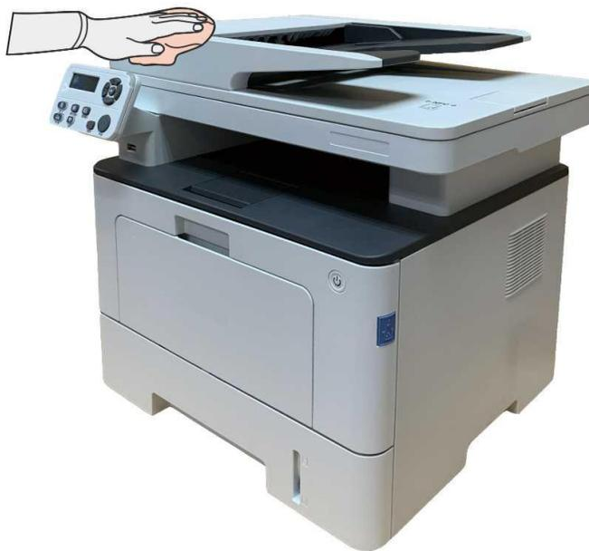
2. Levantar la cubierta del escáner, y limpiar suavemente el cristal de exposición y el alimentador de documentos para dúplex automático CIS (D-CIS) con un paño suave.
