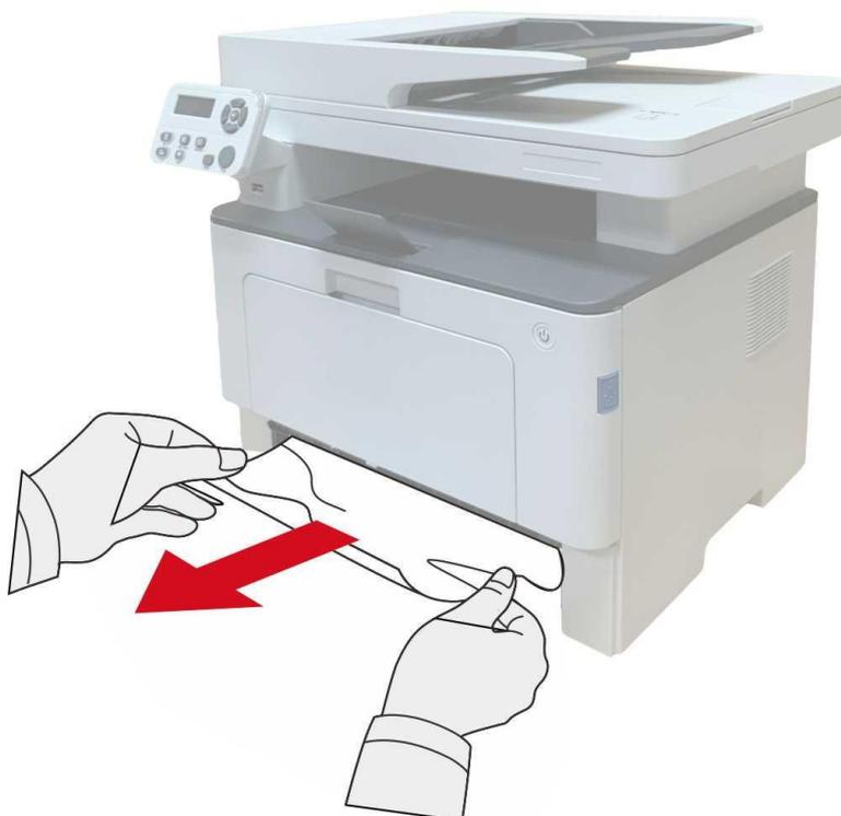
3. Después de retirar el papel atascado, vuelva a insertar la bandeja automática en la impresora; pulse el botón de la cubierta frontal para abrir y cerrar la cubierta frontal, y la impresora reanudará la impresión automáticamente.
