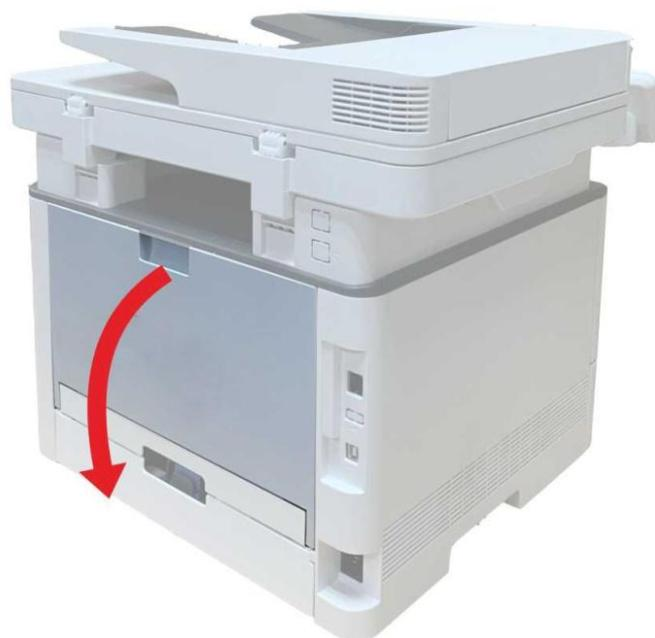
3. Abra la puerta del fusor usando las pestañas situadas en ambos laterales.
