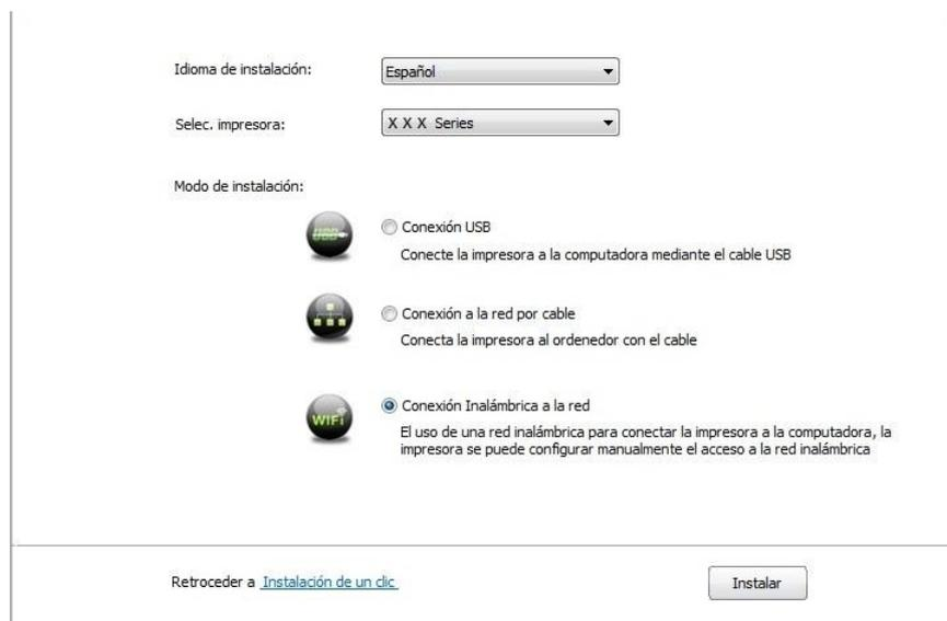
8. En la ventana de configuración inalámbrica emergente seleccione "Si, deseo configurar la red inalámbrica de la impresora", según la operación del sistema, la configuración de la impresora a la red inalámbrica (modo de configurar, véase el [capítulo 5.1.1](#)).
