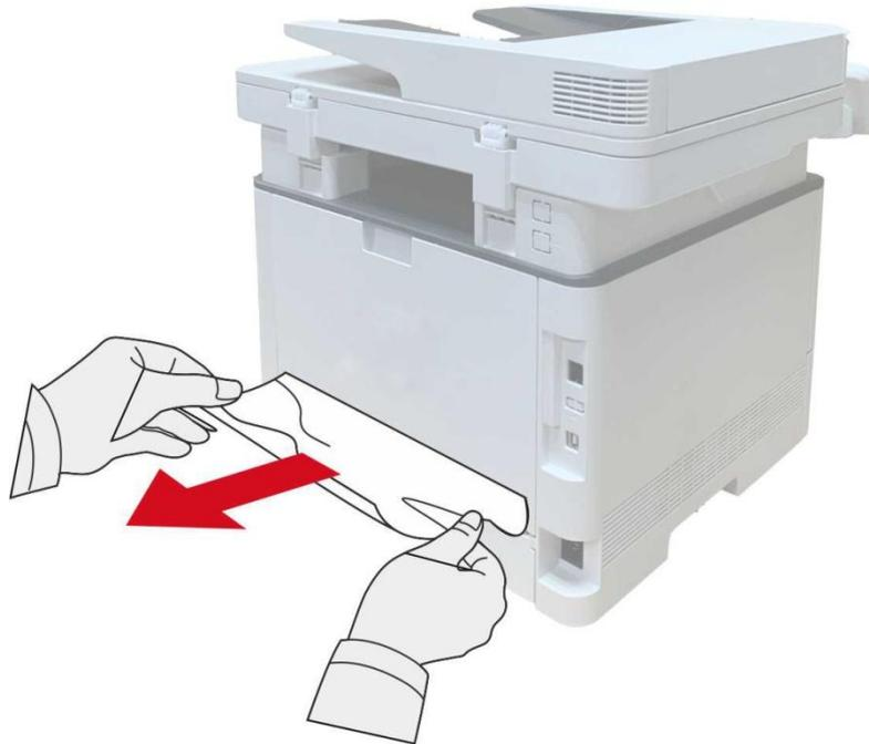
4. Retire el atasco de papel, y poner de nuevo a la unidad dúplex y otras partes de la inspección del producto, para garantizar que ninguna de cartón, abrir y cerrar la cubierta frontal, la impresora reanudará automáticamente la impresión.
