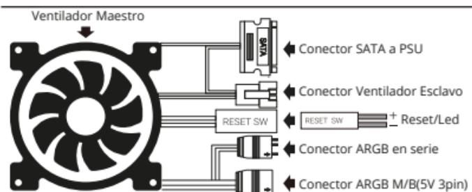
Control: Mantenga presionado el botón de Reset/LED durante tres segundos para cambiar al modo de control M/B. Vuelva a mantener presionado durante tres segundos para cambiar al modo de control del botón de Reset/LED.
