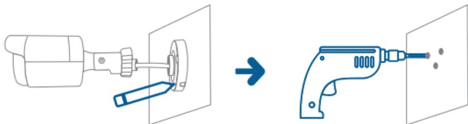
3. Acomoda el cable por debajo de la base, enróscala y utiliza los tornillos (incluidos) para fijarla.
