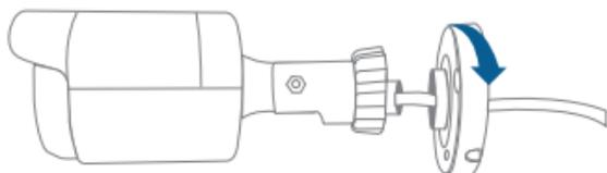
2. Usa la base como plantilla, para hacer las marcas de perforación en a superficie donde colocarás la cámara. Luego, perfora y coloca los taquetes (incluidos).
