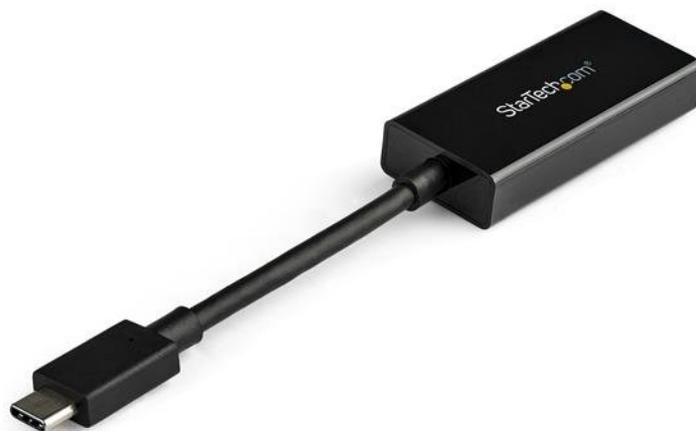
Este adaptador USB-C a HDMI le permite conectar su laptop equipada con USB Type-C a una pantalla HDMI. El adaptador es compatible con HDR ("High Dynamic Range", alto rango dinámico), lo cual ofrece imágenes más nítidas y mejor transmisión de video.
