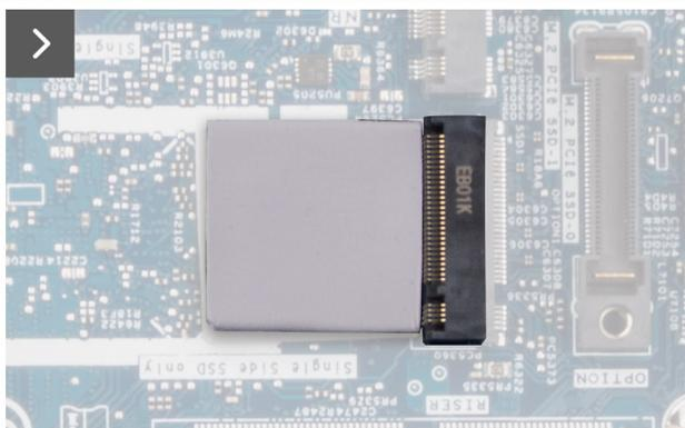
**Ilustración 17. Instalación de la unidad de estado sólido 2230**
