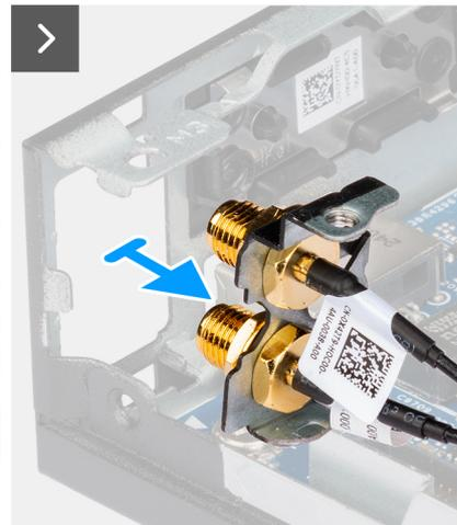
**Ilustración 36. Extracción de la antena SMA**
