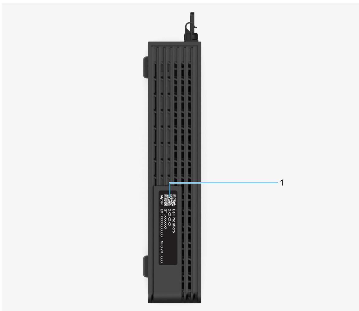
**Ilustración 3. Vista superior de Dell Pro ultracompacto QCM1250**
