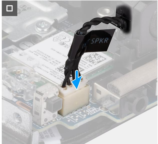
Ilustración 15. Instalación del parlante
