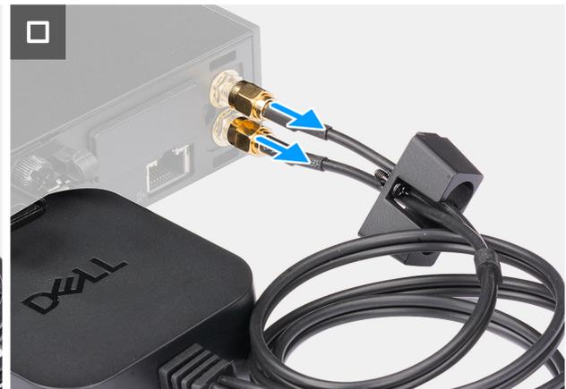
Ilustración 34. Extracción de la antena de disco externa
