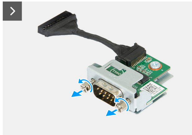
Ilustración 58. Instalación del módulo de puerto serial
