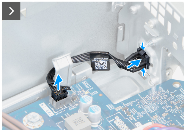
Ilustración 44. Extracción del botón de encendido
