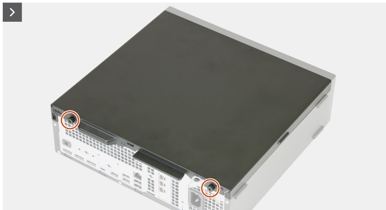
Ilustración 6. Extracción de la cubierta lateral
