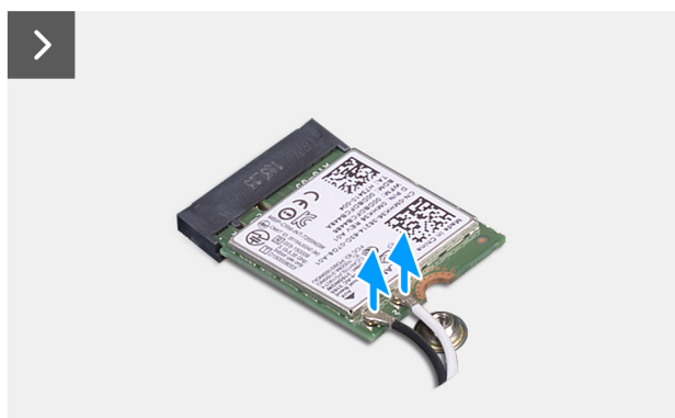
Ilustración 29. Extracción de la tarjeta inalámbrica
