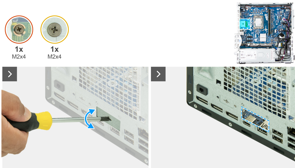
Ilustración 55. Instalación del módulo de puerto opcional
