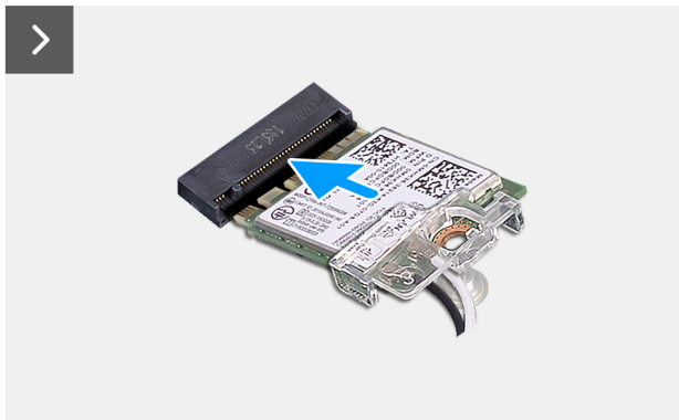
Ilustración 30. Instalación de la tarjeta inalámbrica
