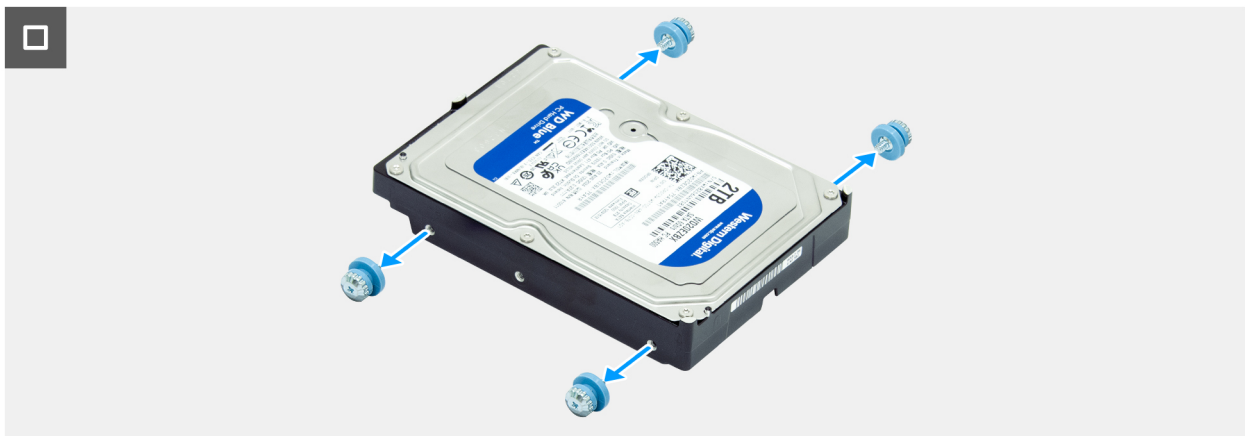
Ilustración 40. Extracción del disco duro
