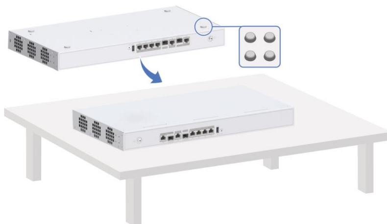
Figura 1-1 Montaje del dispositivo en la Estación de Trabajo
