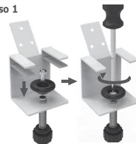
Utilice un tornillo Phillips para fijar la placa de sujeción
