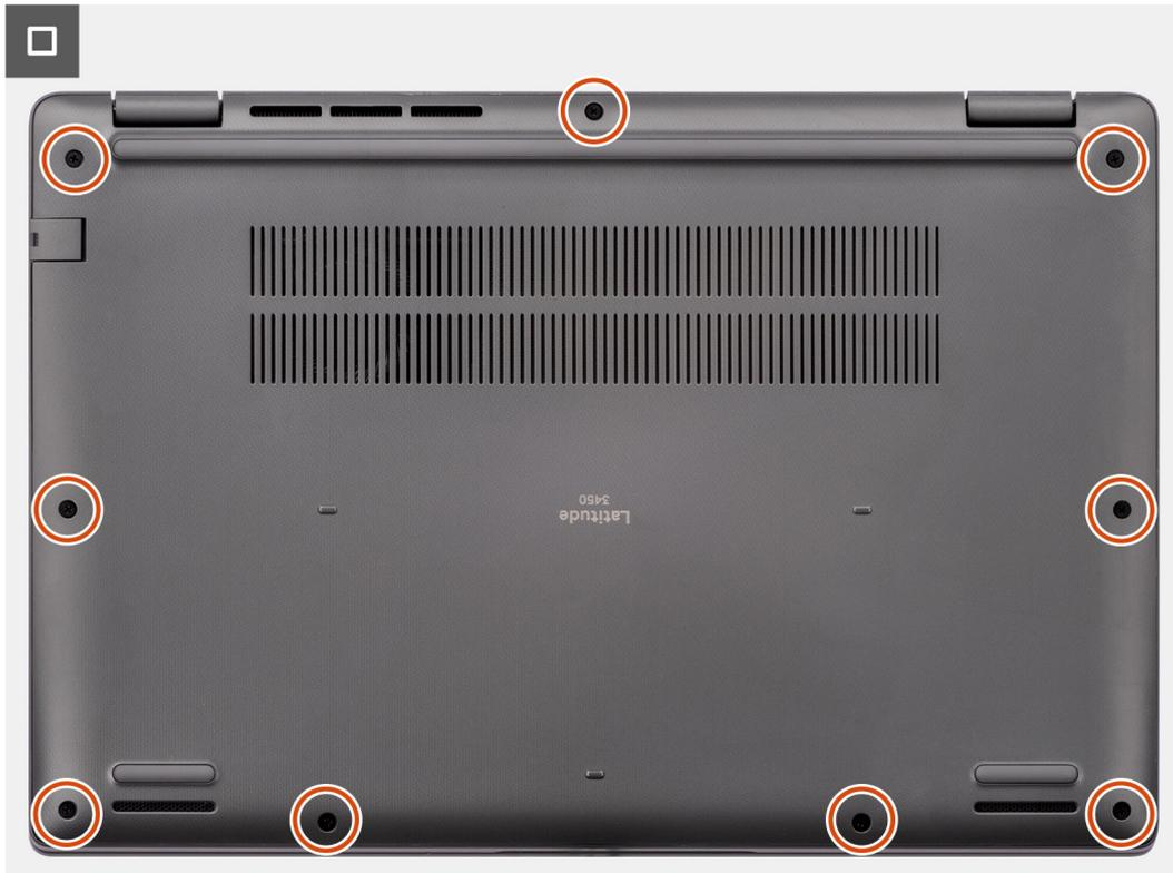
**Ilustración 12. Instalación de la cubierta de la base**
