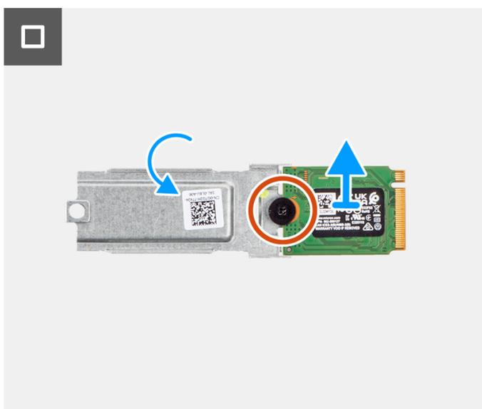
Ilustración 21. Extracción de la unidad de estado sólido M.2 2230
