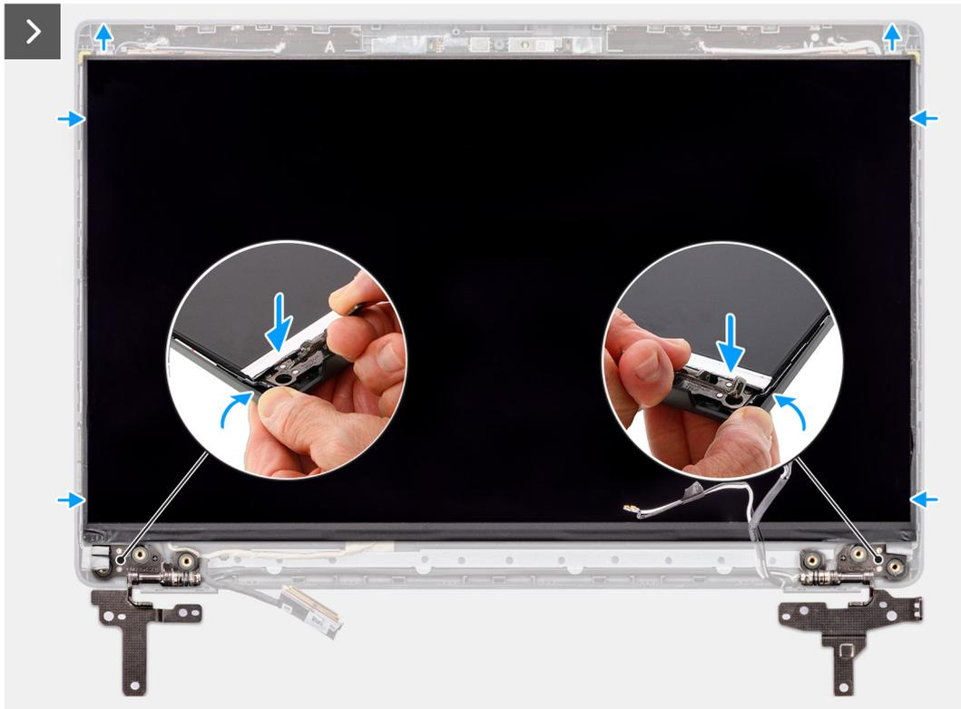
**Ilustración 62. Instalación del panel de pantalla**
