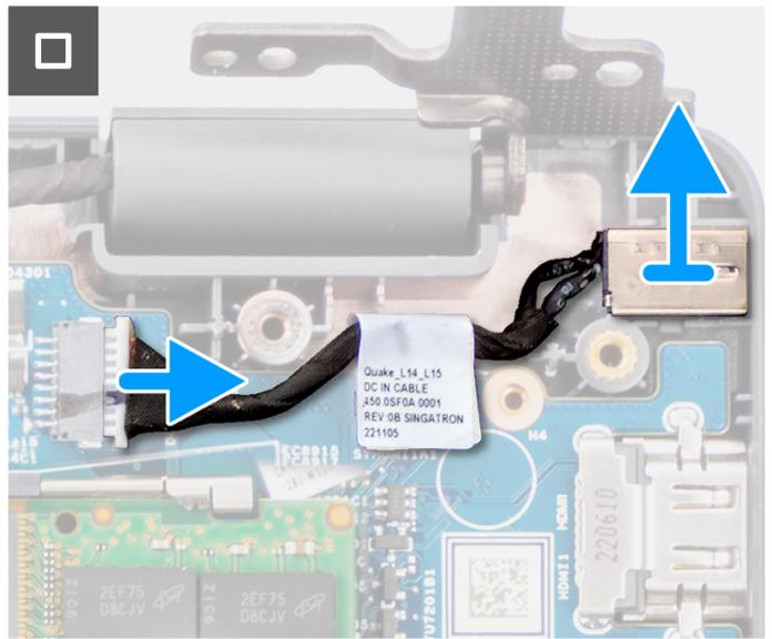
**Ilustración 29. Extracción del puerto del adaptador de alimentación**
