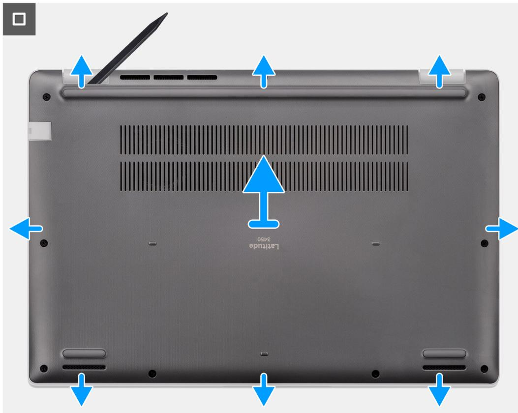
**Ilustración 10. Extracción de la cubierta de la base**
