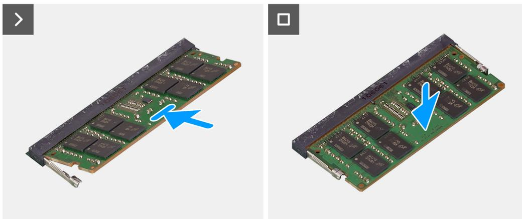
**Ilustración 14. Instalación de los módulos de memoria**
