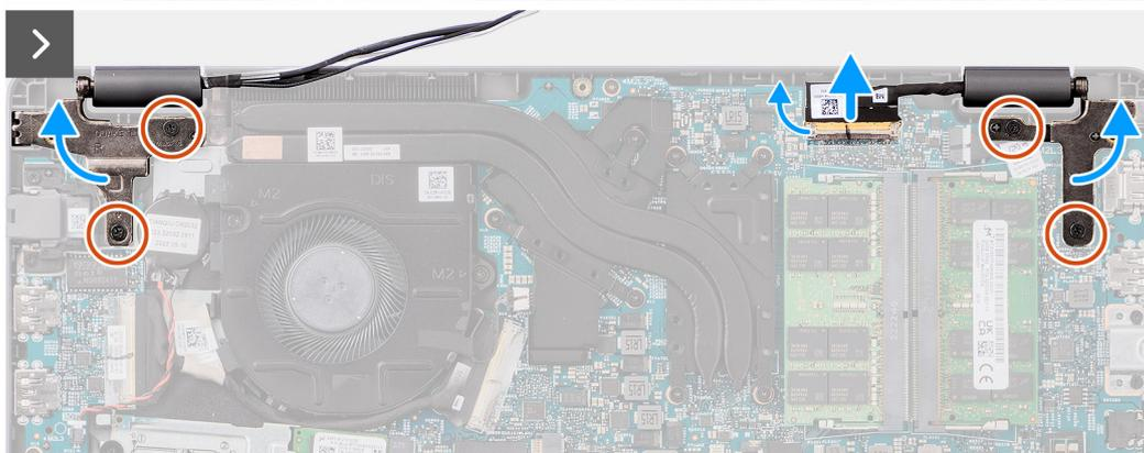
Ilustración 47. Extracción del ensamblaje de la pantalla
