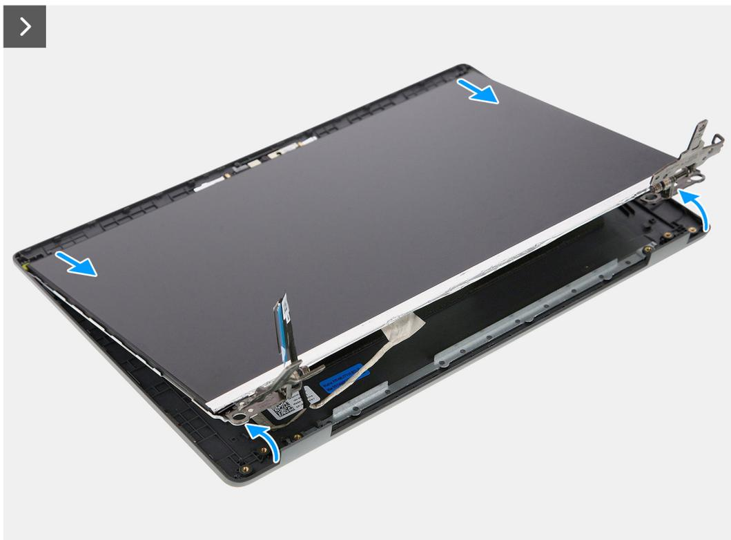
Ilustración 56. Extracción del panel de pantalla
