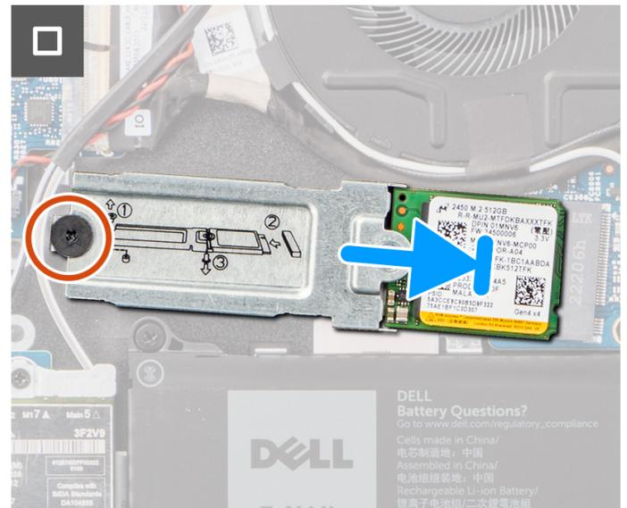
**Ilustración 22. Instalación de la unidad de estado sólido M.2 2230**
