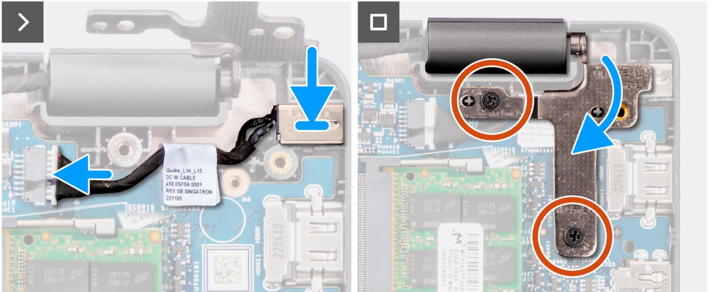
**Ilustración 30. Instalación del puerto del adaptador de alimentación**
