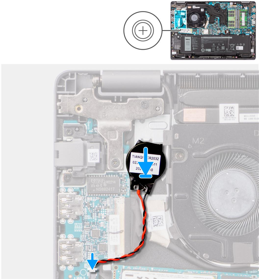
**Ilustración 20. Instalación de la batería de tipo botón**
