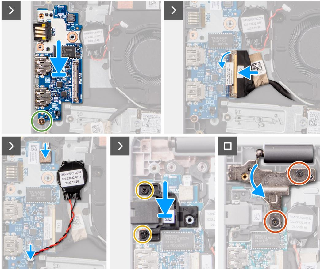
**Ilustración 38. Instalación de la placa de I/O**
