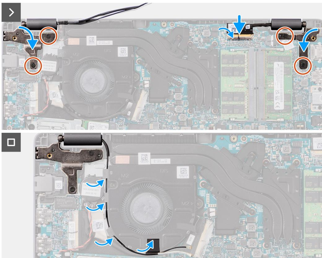
**Ilustración 51. Instalación del ensamblaje de la pantalla**
