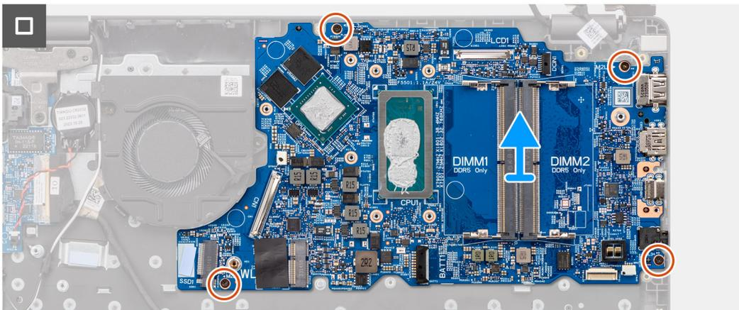
**⚠ PRECAUCIÓN:** El sistema posee una batería de tipo botón que se conecta a la placa de I/O. Desconectar el cable de la placa de I/O restablece los ajustes del programa de configuración del BIOS a los predeterminados. Tenga en cuenta los ajustes del programa de configuración del BIOS antes de desconectar el cable de la placa de I/O.
