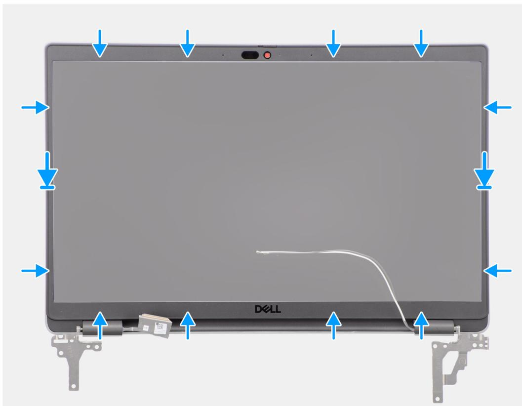
**Ilustración 53. Instalación del bisel de la pantalla**
