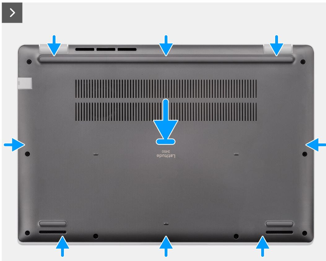
Ilustración 11. Instalación de la cubierta de la base
