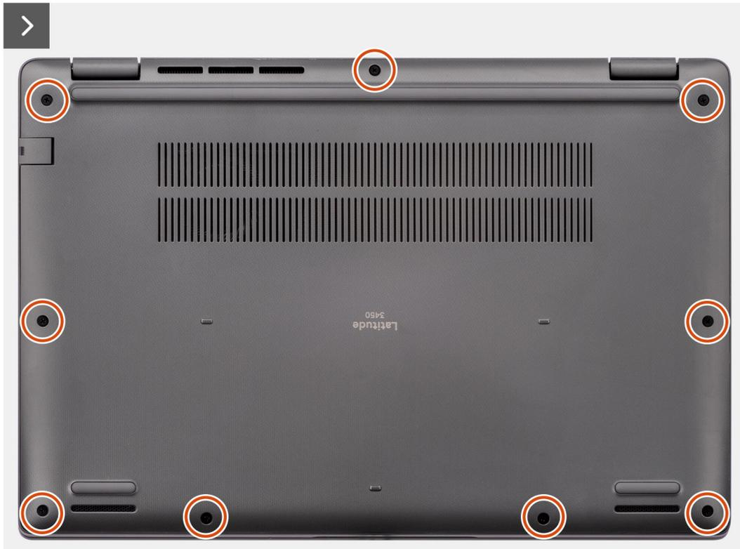
Ilustración 9. Extracción de la cubierta de la base
