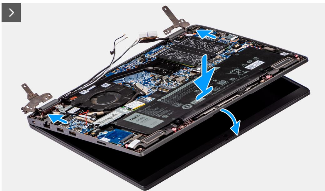
Ilustración 50. Instalación del ensamblaje de la pantalla
