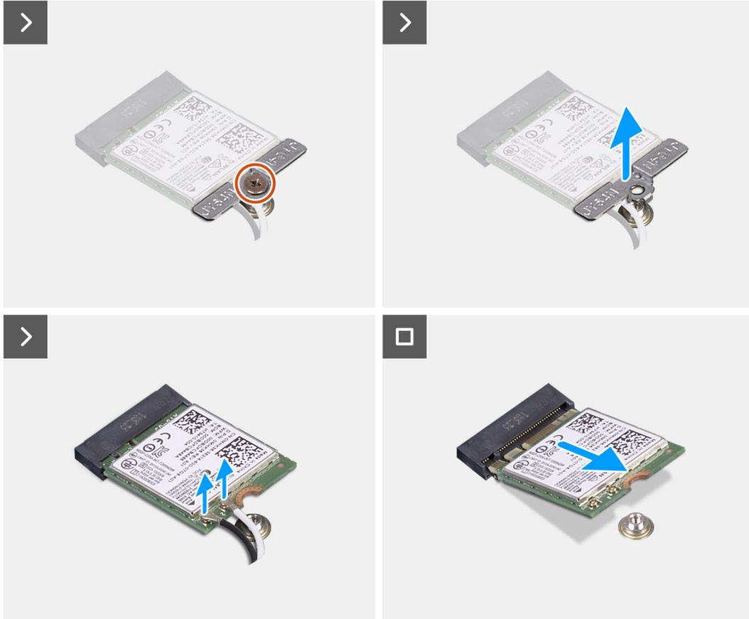
**Ilustración 15. Extracción de la tarjeta inalámbrica**
