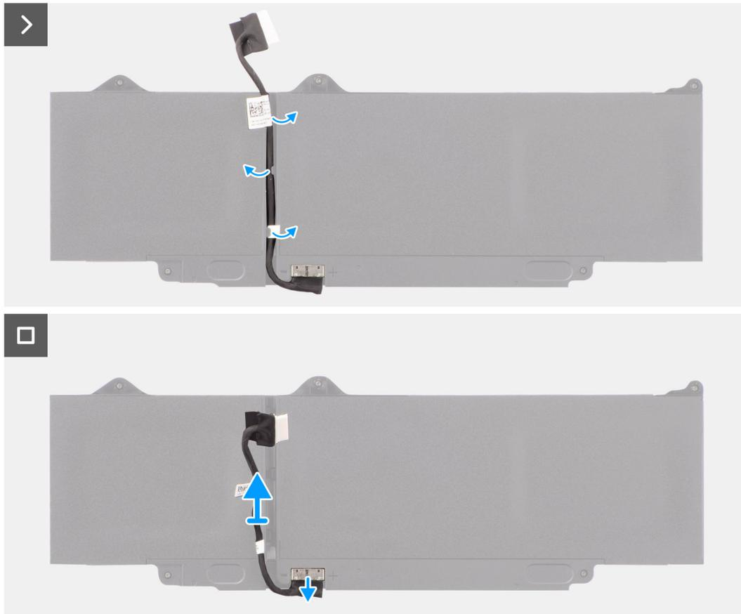
**Ilustración 27. Extracción del cable de la batería**
