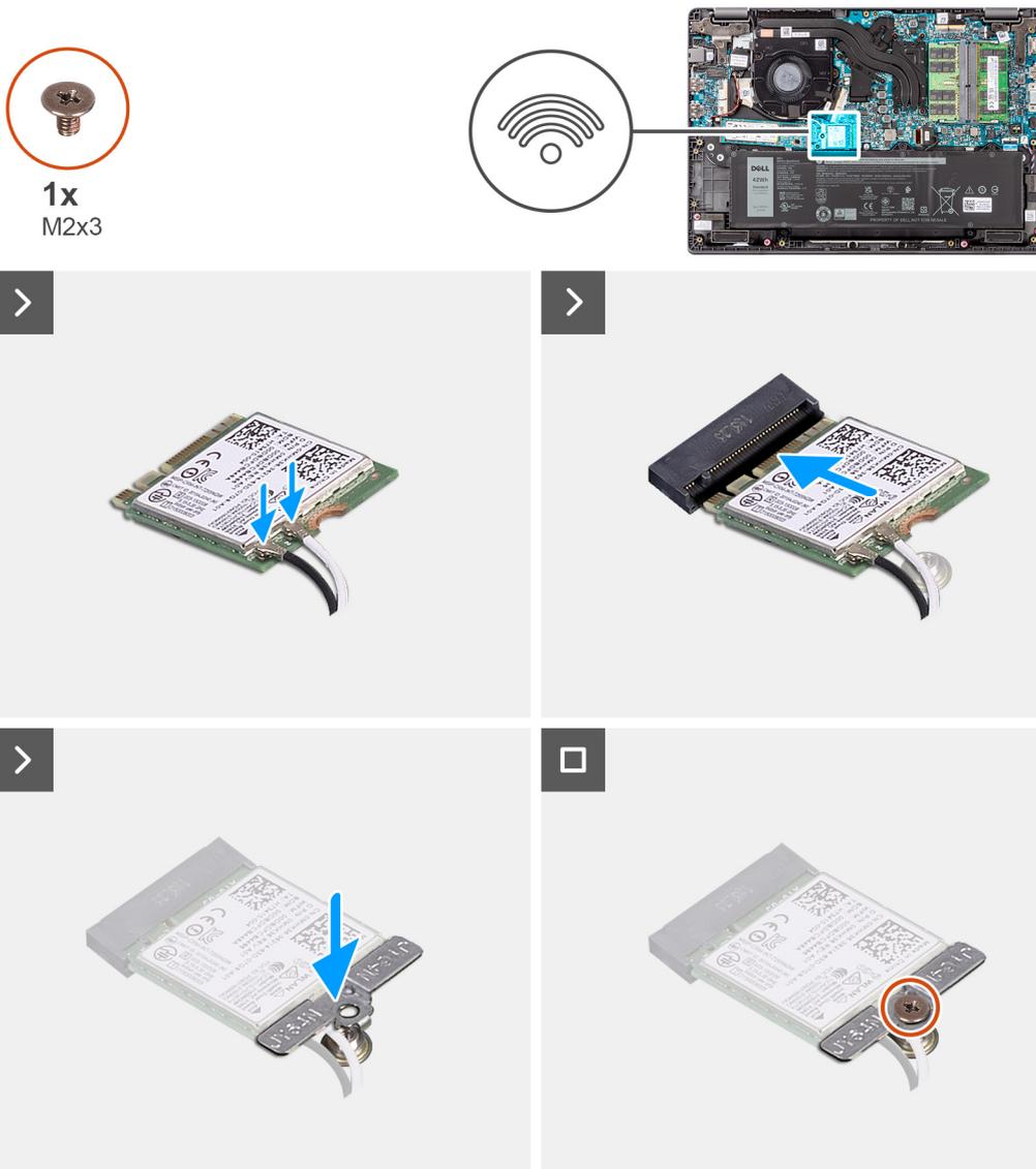
**Ilustración 16. Instalación de la tarjeta inalámbrica**
