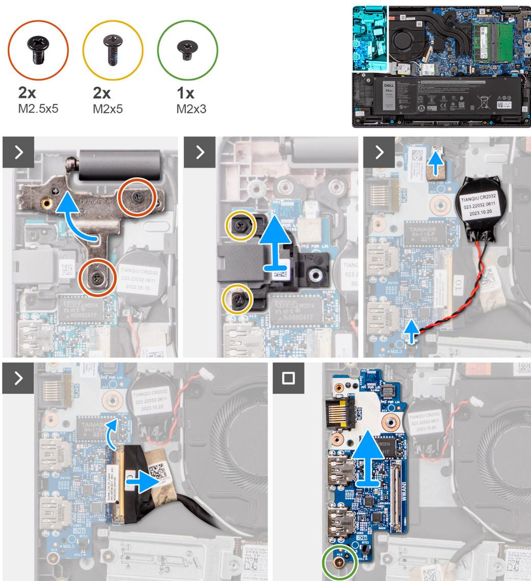
Ilustración 37. Extracción de la placa de I/O
