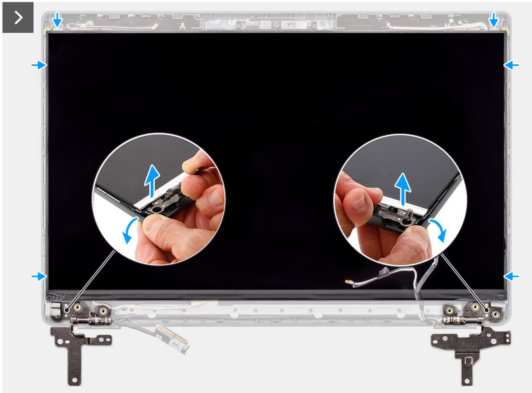
Ilustración 55. Extracción del panel de pantalla
