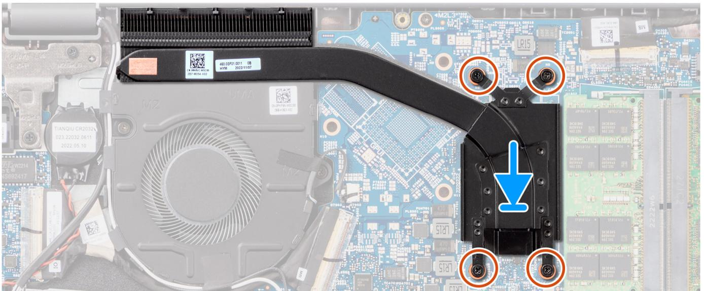
**Ilustración 32. Instalación del disipador de calor para gráficos integrados**
