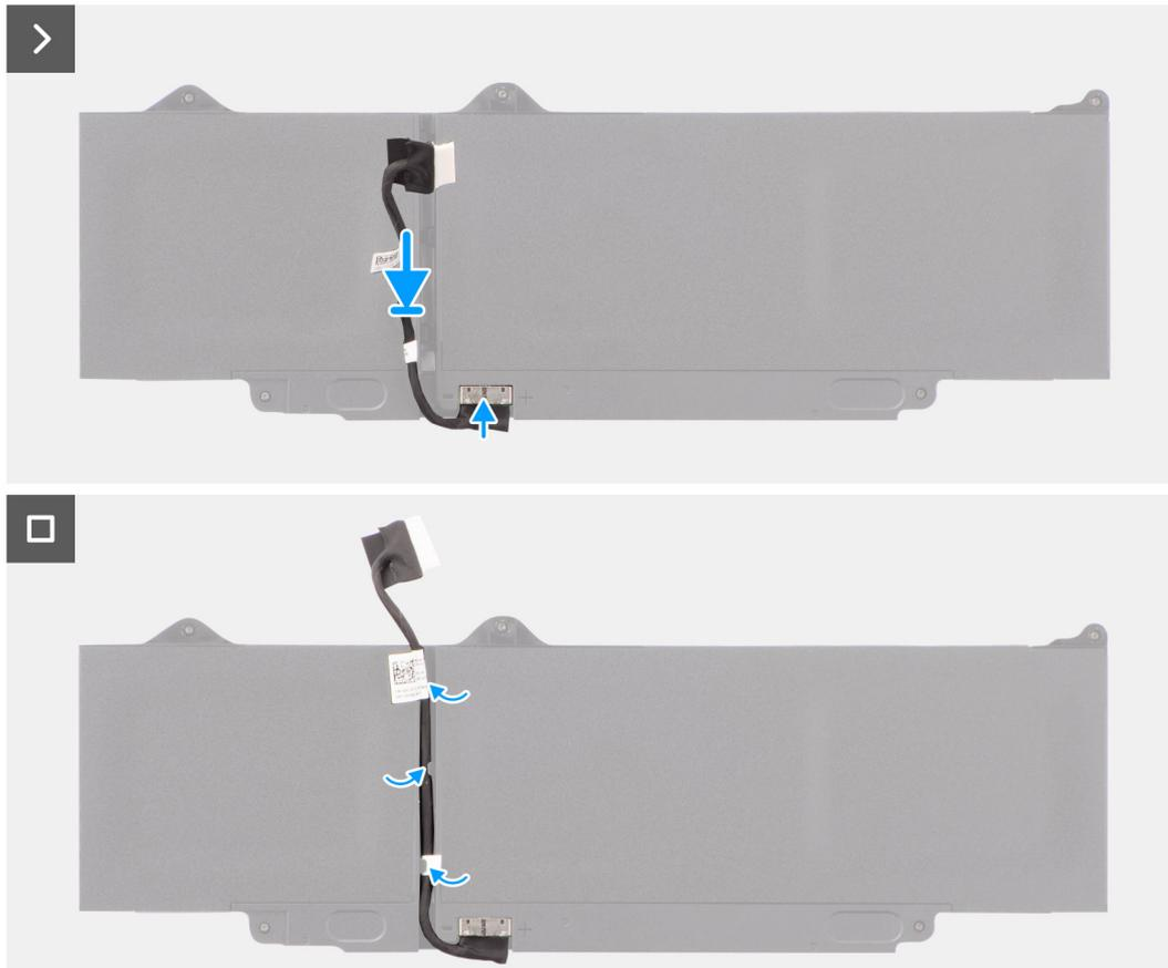
**Ilustración 28. Instalación del cable de la batería**
