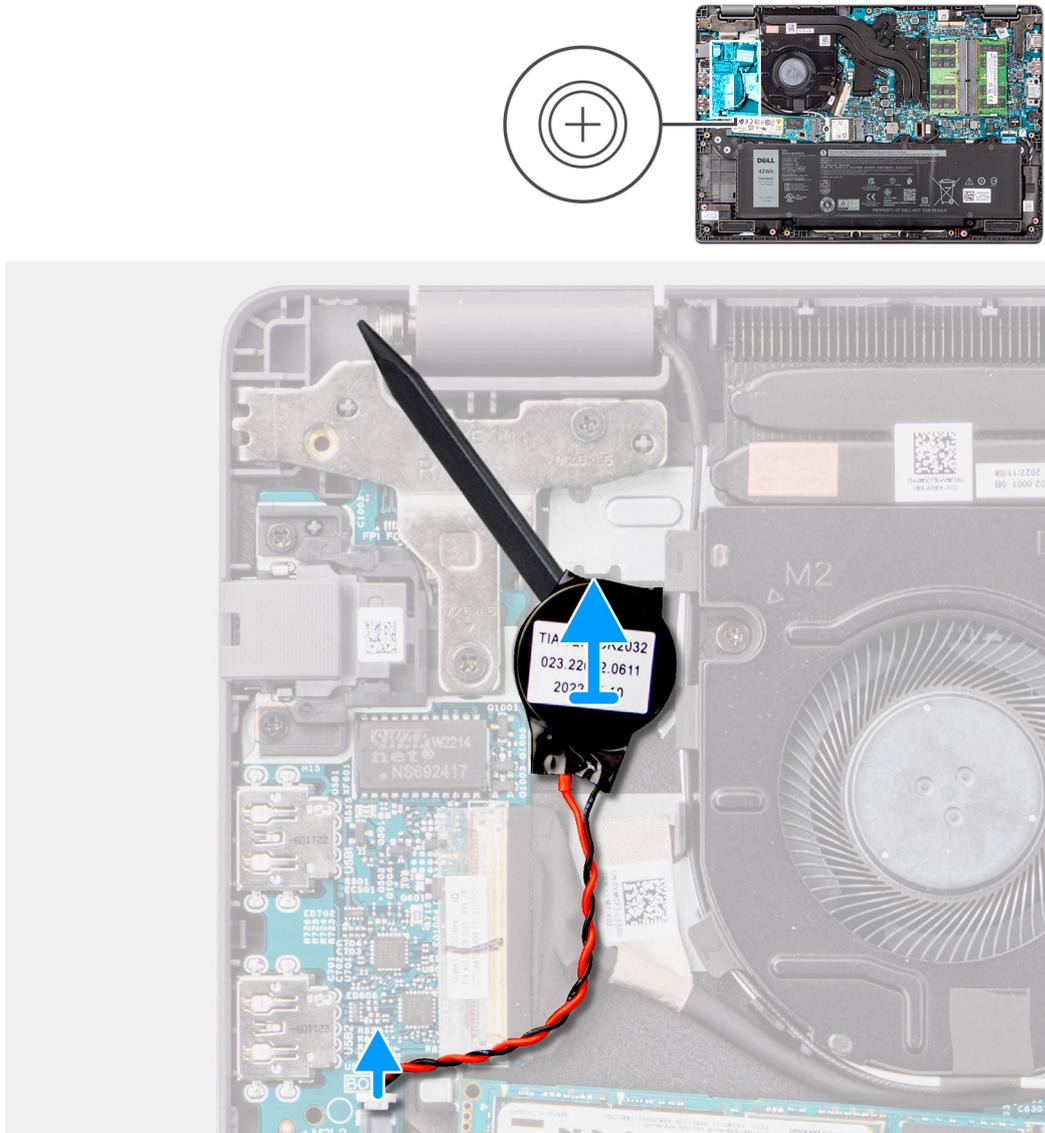
**Ilustración 19. Extracción de la batería de tipo botón**
