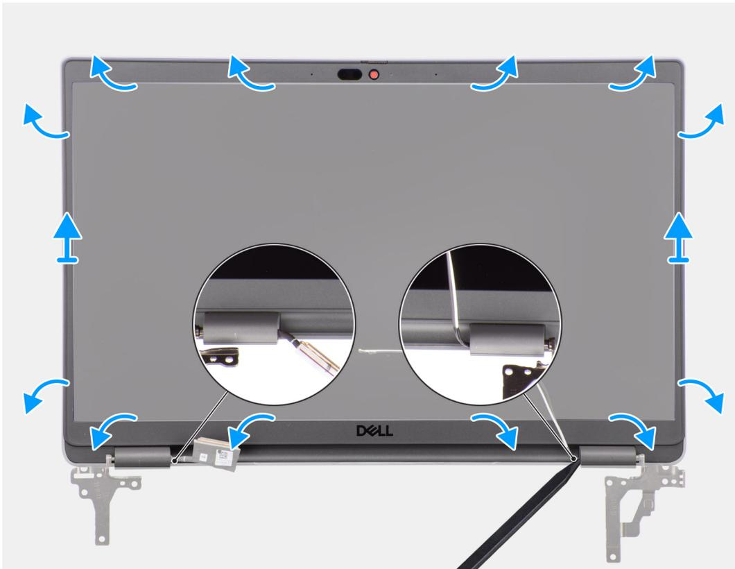
**Ilustración 52. Extracción del bisel de la pantalla**
