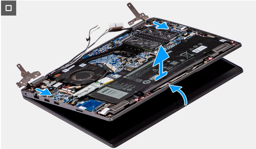
**Ilustración 48. Extracción del ensamblaje de la pantalla**
