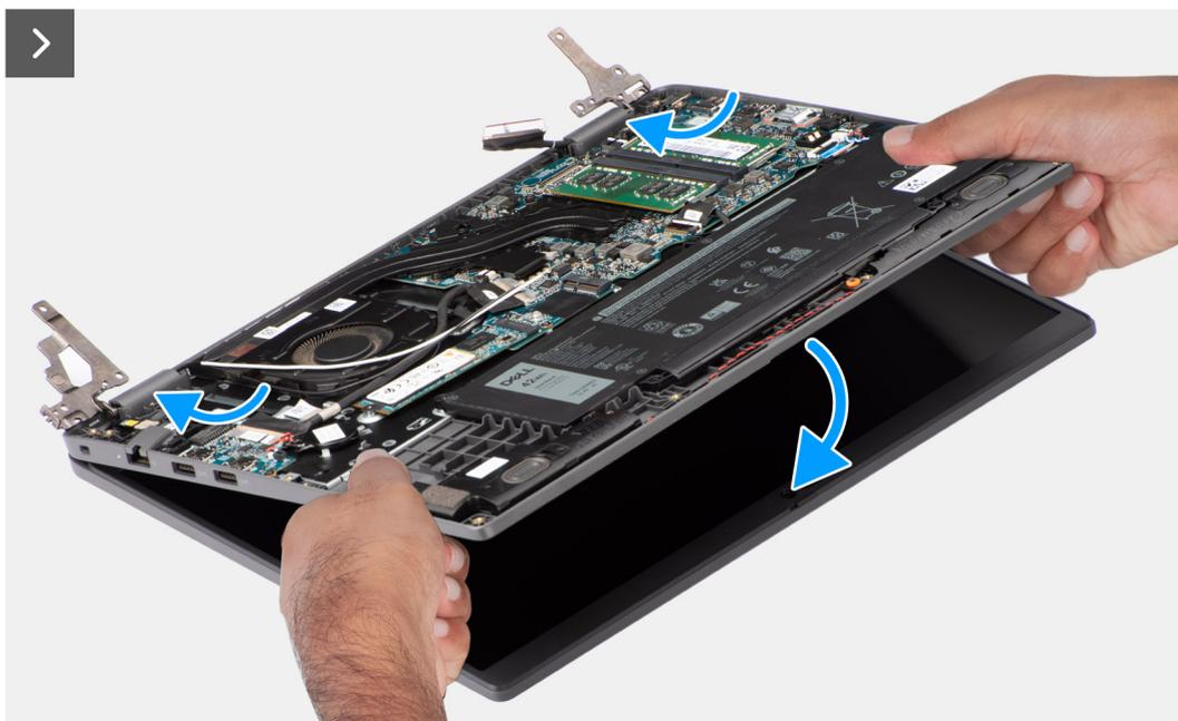
**Ilustración 49. Extracción del ensamblaje de la pantalla**
