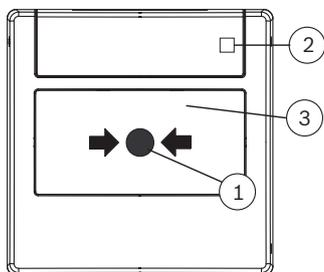
Al pulsar la señal (1), se rompe el cristal (3), lo que activa la alarma y hace que el LED parpadee (2). Los pulsadores de incendio de accionamiento único se pueden rearmar con la llave de prueba y cambiando el cristal (3). El LED (2) se apaga.
