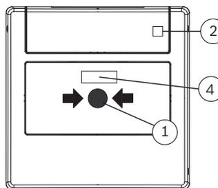
Al pulsar la señal (1), se activa la alarma. El estado de alarma se indica mediante el cambio de color de la ventana (4) y el parpadeo del LED (2). Los pulsadores alarma de incendio de accionamiento único se pueden rearmar con la llave de prueba. El LED (2) se apaga.
