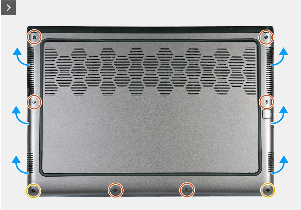
**Ilustración 9. Extracción de la cubierta de la base**
