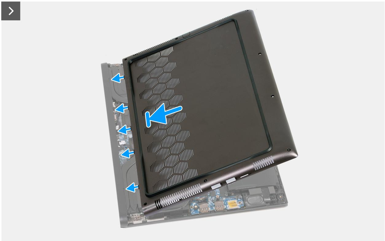
**Ilustración 11. Instalación de la cubierta de la base**
