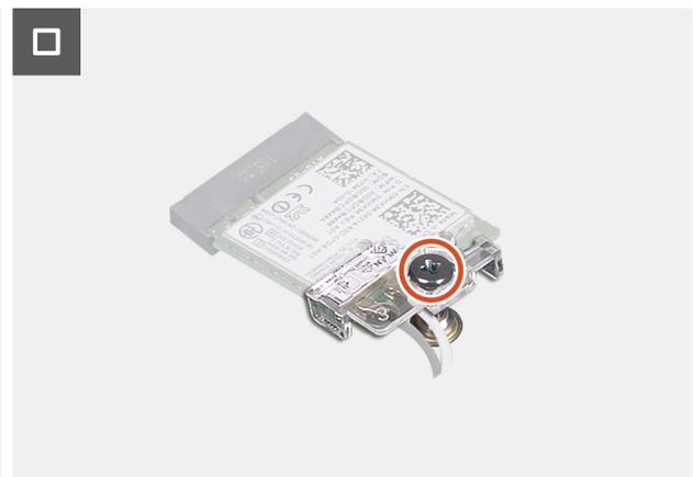
Ilustración 18. Instalación de la tarjeta inalámbrica
