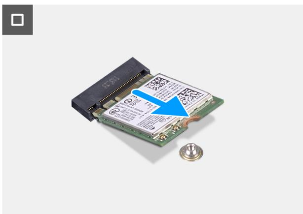
**Ilustración 17. Extracción de la tarjeta inalámbrica**
