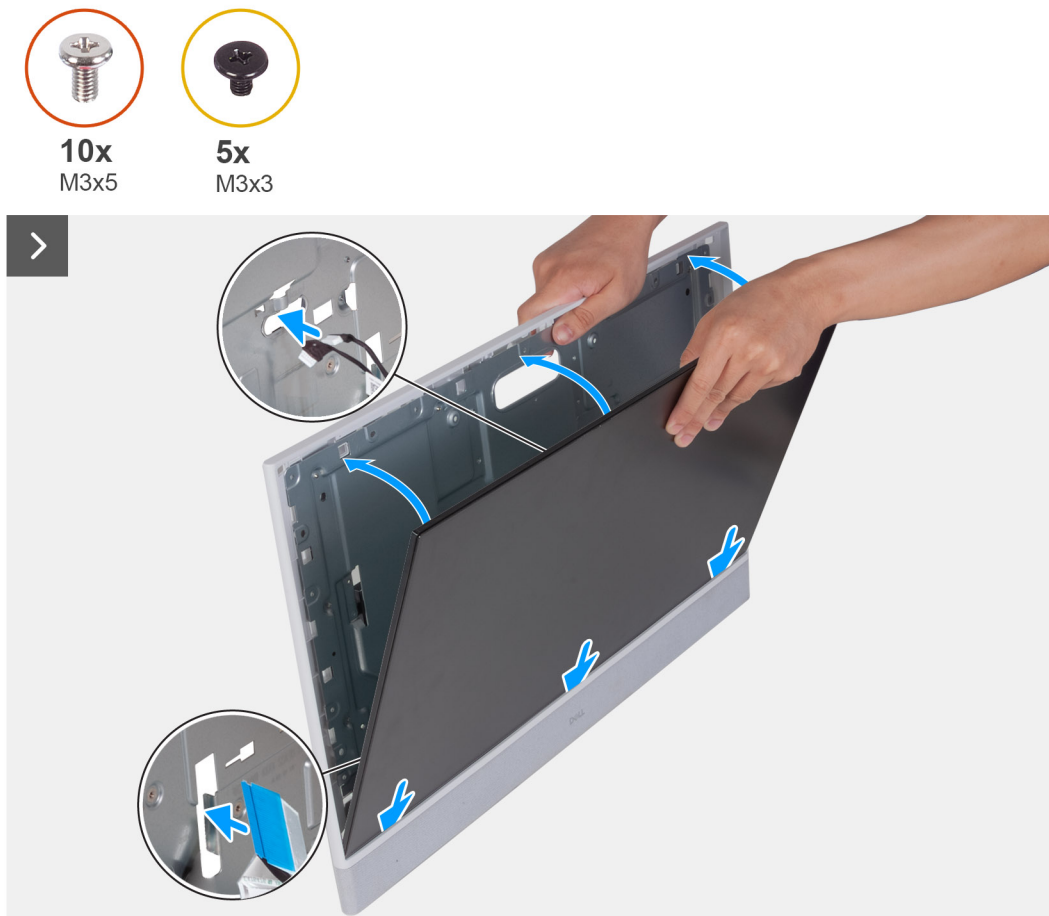
Ilustración 62. Instalación del panel de pantalla
