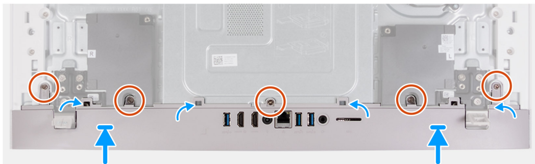
Ilustración 23. Instalación de la cubierta inferior
