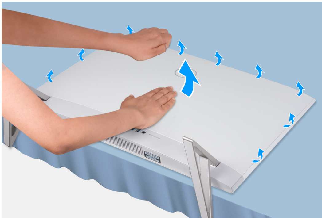
Ilustración 20. Extracción de la cubierta posterior
