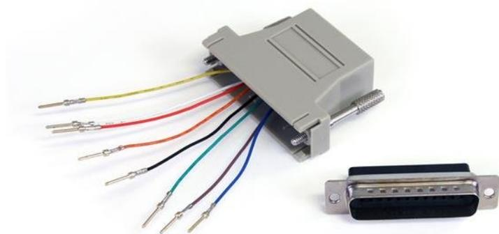
Este adaptador DB25M a RJ45F se utiliza para conexiones modulares RS232, RS422 y RS485.
