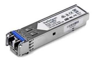
El modelo GLCLHSMDST es un módulo transceptor por fibra óptica compatible con el modelo GLC-LH-SMD de Cisco, diseñado, programado y probado para su funcionamiento con enrutadores y conmutadores de la marca Cisco®. Ofrece conectividad confiable a 1GbE a través de cableado de fibra, para redes compatibles con 1000BASE-LX/LH, a una distancia máxima de hasta 10km.
