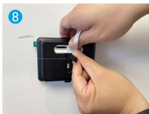
Conecte el panel al cable de la cámara.
