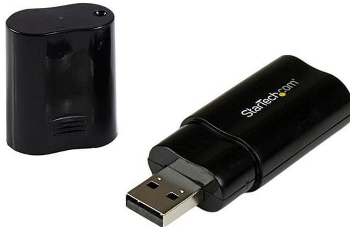
Este adaptador USB a audio convierte un puerto USB en puerto de audio, lo cual permite la conexión de un conjunto de audífonos y micrófono a un computador, sin necesidad de desconectar otros dispositivos.
