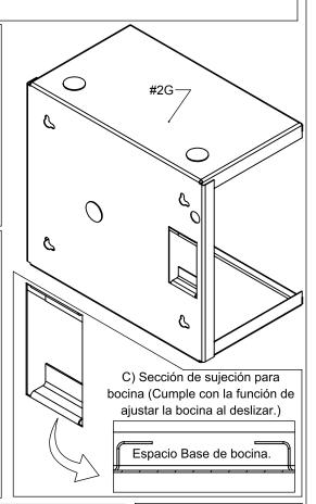
D) Considere la instalación eléctrica a manejar dentro/fuera del gabinete y su pared antes de perforar. El gabinete cuenta con cinco salidas de cables con tapa removible.
