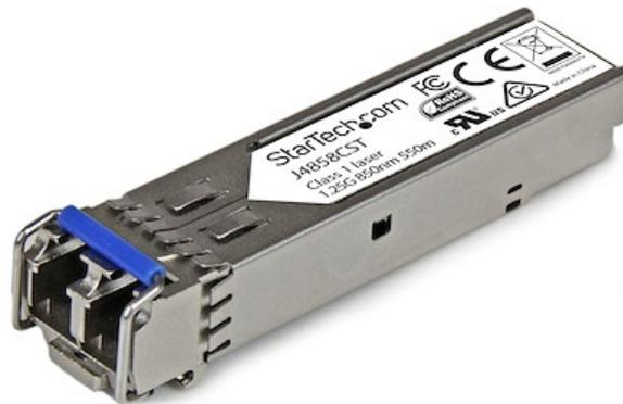
El modelo J4858CST es un módulo transceptor por fibra óptica, compatible con el modelo J4858C de HPE, diseñado, programado y probado para su funcionamiento con enrutadores y conmutadores de la marca HPE®. Ofrece conectividad confiable a 1GbE a través de cableado de fibra, para redes compatibles con 1000BASE-SX, a una distancia máxima de hasta 550m.
