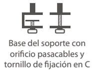
Base del soporte con orificio pasacables y tornillo de fijación en C
