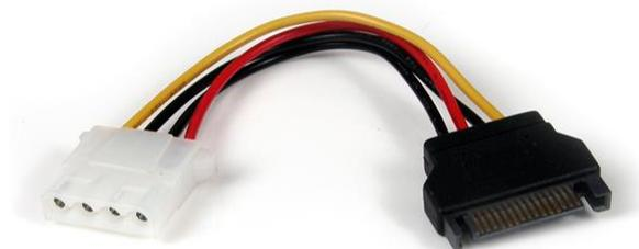
Este Adaptador de Cable de Alimentación SATA a LP4, LP4SATAFM6IN dispone de un conector LP4 hembra y un conector SATA macho, permitiendo conectar un disco duro IDE a un conector de alimentación Serial ATA de la fuente de alimentación del computador.
