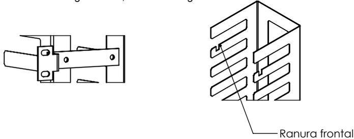
2- Instale los brackets de sujeción sobre las perforaciones preparadas en la parte trasera de su Rack de la serie EIRL o EIRA (no incluido) utilizando el kit de tornillos incluido.
