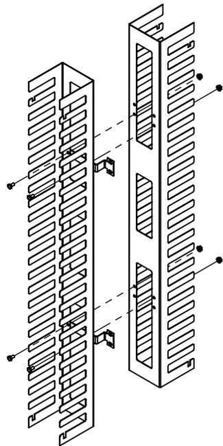
Para realizar una instalación doble, utilice solo 2 pares de tornillos y 1 par de brackets para sujetar ambos organizadores.
