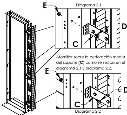
Atornillar sobre la perforación media del soporte (C) como se indica en el diagrama 2.1 y diagrama 2.2.
