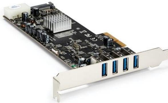
La tarjeta PCI Express USB 3.0 de 4 puertos, modelo PEXUSB3S44V, permite agregar, a un PC con PCIe x4 disponible, cuatro puertos dedicados USB 3.0 de 5 Gbps. La arquitectura de puerto independiente mejora el rendimiento USB 3.0, ya que transfiere los datos a la computadora en cuatro canales independientes, lo cual permite transferencias de archivos más rápidas.
