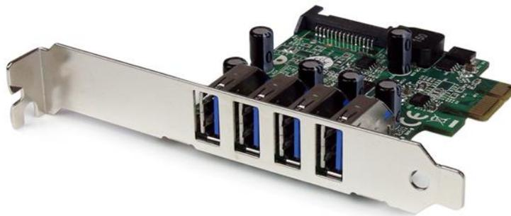
La tarjeta PCI Express USB 3.0 (con alimentación SATA), modelo PEXUSB3S4V, permite agregar 4 puertos USB 3.0 externos a cualquier sistema informático equipado con PCI Express, además de admitir tasas de transferencia de datos de hasta 5 Gbps y ser retrocompatible con dispositivos USB 2.0 / 1.x.
