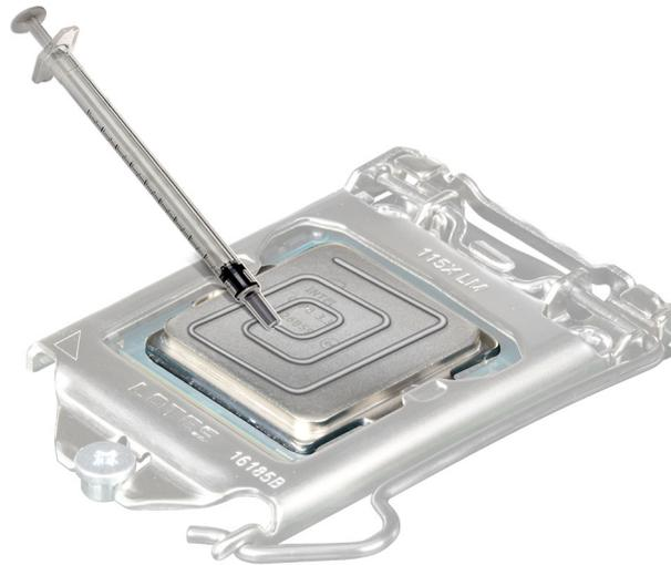
**Ilustración 59. Aplicación de la grasa térmica**
