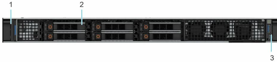
**Ilustración 2. Vista frontal de un sistema de 6 unidades de 2,5 pulgadas**
