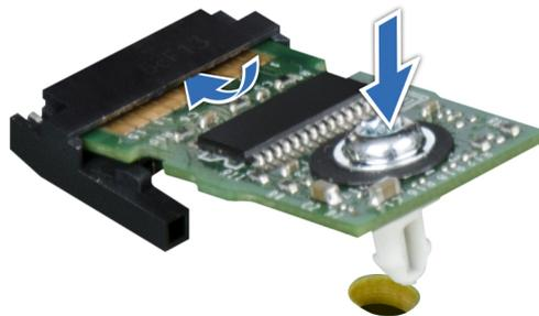
Ilustración 91. Instalación del TPM
