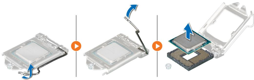
**Ilustración 57. Extracción del procesador**
