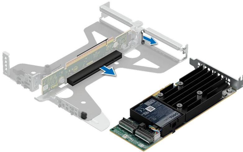
**Ilustración 65. Extracción de una tarjeta de expansión de la tarjeta elevadora**
