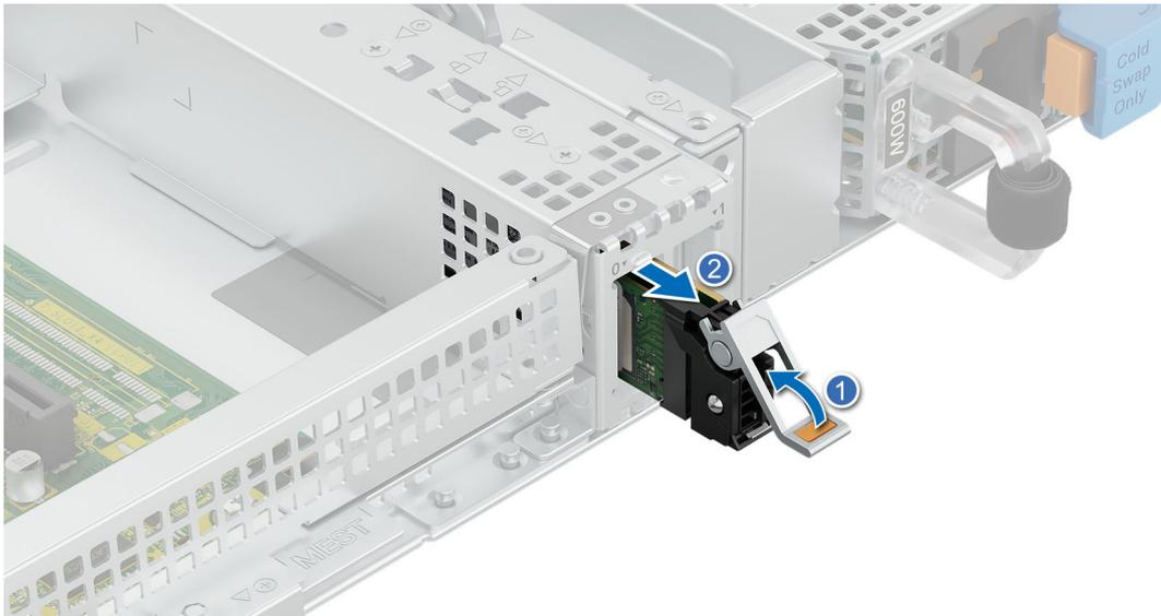
**Ilustración 71. Extracción del módulo M.2 de BOSS-N1**
